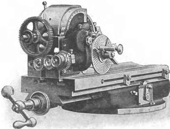
Abb. 60. Wanderer-Teilkopf (2 Wechselräder und 2 Zwischenräder).
