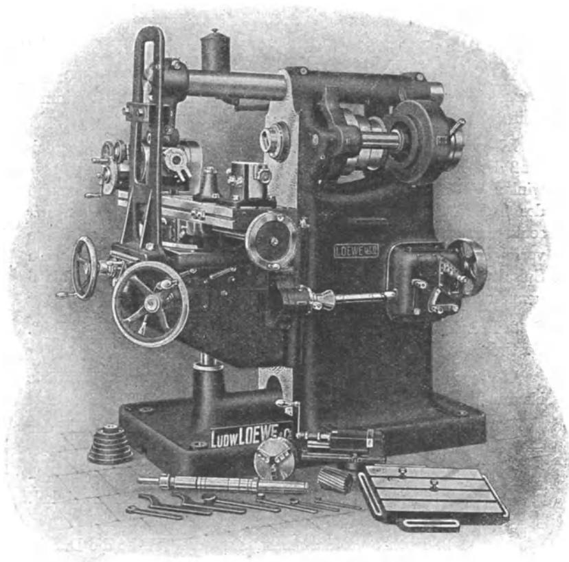
Abb. 44. Universalfräsmaschine von Ludw. Loewe, A.-G.
