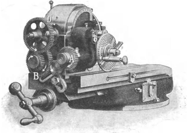
Abb. 61. Wanderer-Teilkopf (4 Wechselräder und 1 Zwischenrad).
