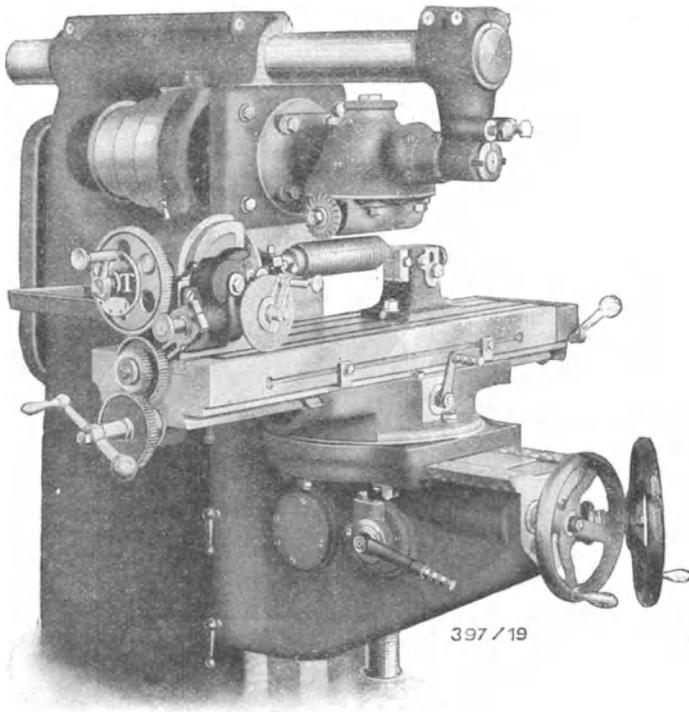
Abb. 36. Wanderer Universalfräsmaschine mit Fräserkopf zum Gewindefräsen.
