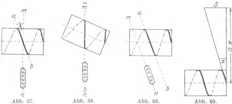
zeichnet den Unterschied zwischen beiden Richtungen. Entweder muß nun der Arbeitstisch um diesen  $\angle x$  verstellt werden (Abb. 38) oder der Fräserkopf muß um die Größe dieses Winkels gedreht werden (Abb. 39).
