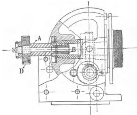
Abb. 34. Räderanordnung zum Fräsen großer Steigungen.      Abb. 35. Wanderer-Teilkopf mit Vorrichtung zum Gewindeschneiden.
