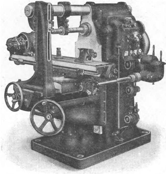
Abb. 46. Universalfräsmaschine von J. E. Reinecker, A.-G., Chemnitz.
