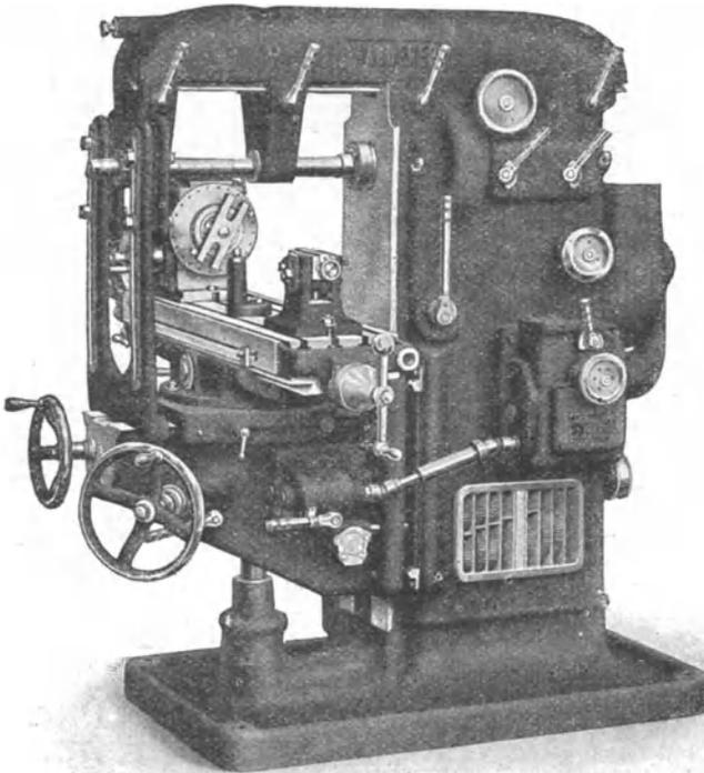
Abb. 45. Universalfräsmaschine der Wanderer-Werke, Schönau bei Chemnitz.
