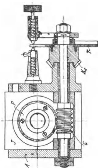
Abb. 33. Universalteilapparat.
