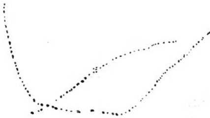
Fig. 5. Voorkomen van een opname met sporen van \beta -stralen. (Wilson)
