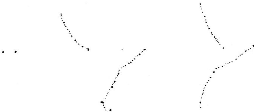
Fig. 6. Foto-elektronen en Compton-elektronen door een van rechts komende bundel \gamma -stralen vrijgemaakt. (Wilson)
