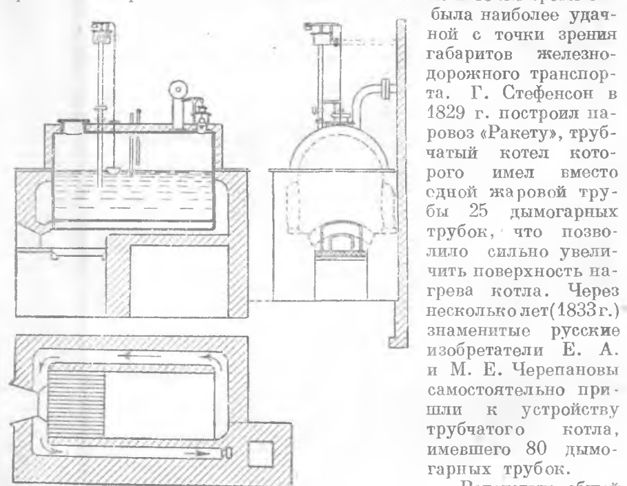
Фиг. 6. Вытянутый по горизонтальной оси «сундучный» паровой котел Уатта (80-е годы XVIII в.).
