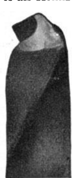
Fig. 6. An Ecke und Kante beschädigter Spiralbohrer.
