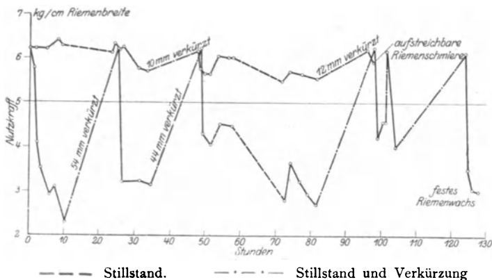
Fig. 3. Einfluß verschiedener Riemenbeschmiere auf die Umfangskraft. Die aufstreichbare Riemenbeschmiere (obere Linie) gibt eine bessere gleichzeitige Kraftübertragung, während das feste Riemenwachs (untere Linie) in kurzer Zeit nach jedem Nachspannen des Riemens versagt.
