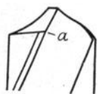
Fig. 4. Stumpfwerden des Bohrers an den Ecken.
