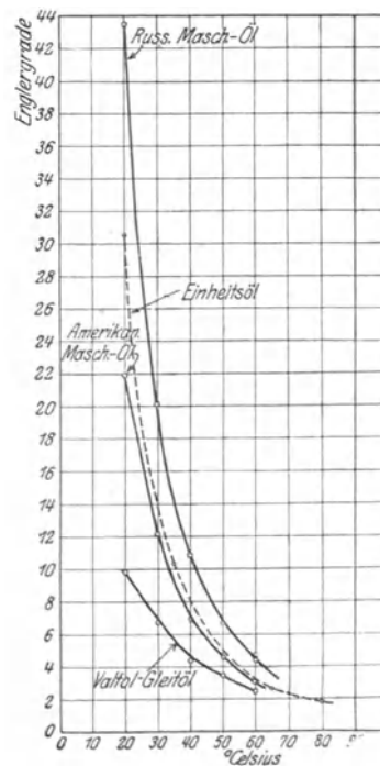
Fig. 7. Viskositätskurve des Einheits-öles im Vergleich zu anderen Schmier-ölen.
