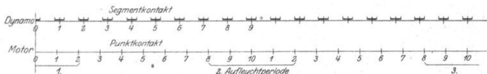
Fig. 13. Schematische Abwicklung der Kontakte bei der Schlupfmessung.
