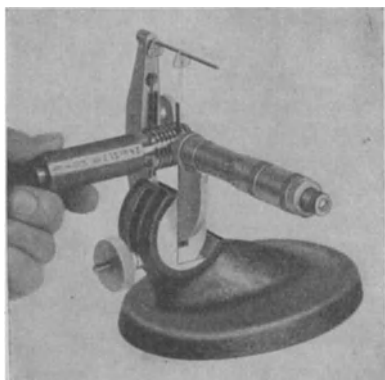
Abb. 14. Schraublehre zum Messen des Flankendurchmessers mit 3 Drähten. Carl Zeiss, Jena.)
