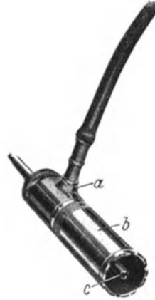
Abb. 23. Ausbohrapparat für Schleifscheiben. a = Wasserspülbuchse; b = äußerer Bohrer; c = innerer Bohrer.
