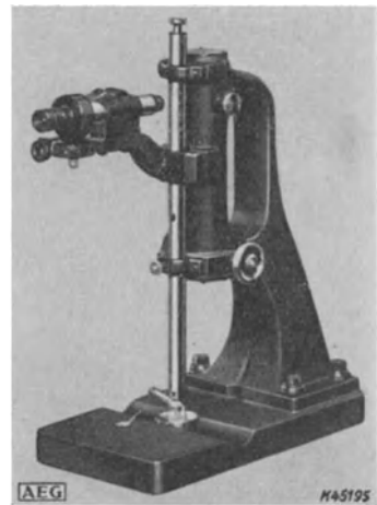
Abb. 20. Meßapparat für die Durchmesserbestimmung dreischneidiger Gewindebohrer ohne Körnerlöcher.
