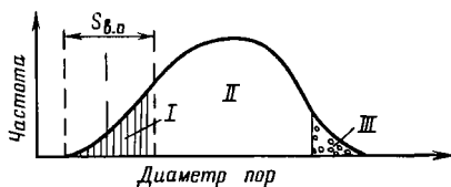
Рис. 4.37. Распределение насыщенности при наличии трех фаз.
