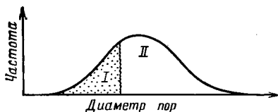
Рис. 4.35. Кривая распределения пор по размерам и флюидонасыщенность. Фазы: I — смачивающая; II — несмачивающая
