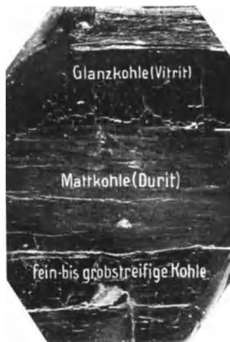
Abb. 310. Stückanschliff einer Streifenkohle.
