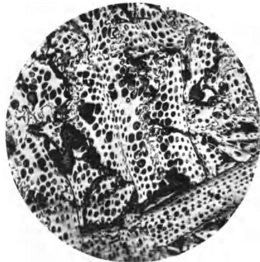
Abb. 313. Schnitt durch eine Fusitlinse. Hell: Zellwände; dunkel: Zellräume, vereinzelt mit sehr hell erscheinender Pyritausfüllung, trocken. Vergr. 81mal.
