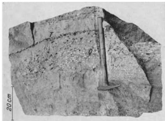
Abb. 73. Gesteinsblock aus dem Finefrau-Konglomerat mit lagenweise angeordneten Toneisenstein- (T) und Quarzgeröllen (Q). S.W.B.
