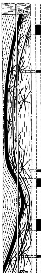
Abb. 202. Profil einer Bohrung, welche dieselben Flöze dreimal durchsunken hat. Aus KUKUK: Glückauf 1924.
