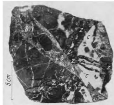
Abb. 645. Verwerfung eines älteren Zinkblendeganges durch einen jüngeren Bleiglanzgang. b Bleiglanz, z Zinkblende, c Quarz. Zeche Auguste Victoria. S.W.B.
