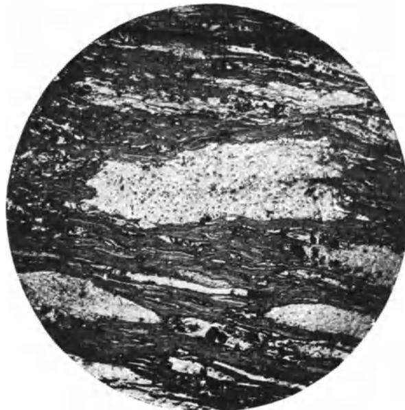
Abb. 311. Dichter Durit mit viel Übergangsstufen. Dunkel: Protobitumina (Exinit); hell: Vitrinsubstanz, Übergangsstufen und Opaksubstanz, die erst bei stärkerer Vergrößerung auseinander gehalten werden können. Milar. Vergr. 10mal.
