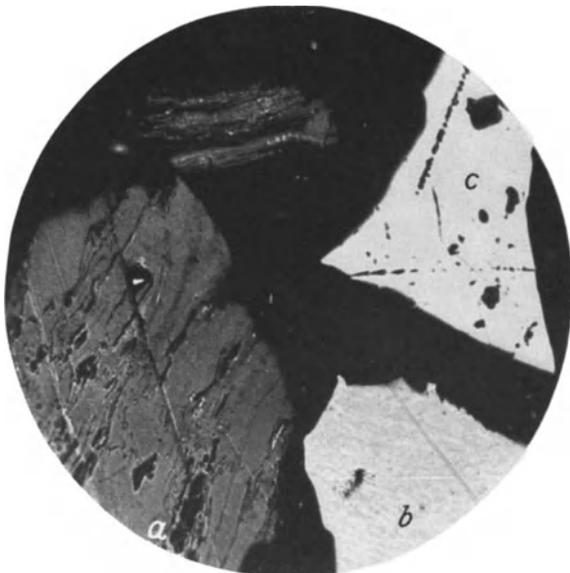
Abb. 327. Körnerschliff verschieden inkohlter Kohlen. Schwarz: Harzeinbettungsmasse. a Gasflammkohle; b untere Fettkohle; c Anthrazit. Ölimmersion. Vergr. 176mal.
