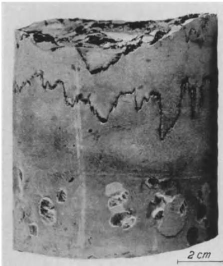
Abb. 491. Lamarckkalk (Bohrkern) mit „Schädelnahtstruktur“. Bohrung Westfalen 7 bei Dolberg. S.W.B.
