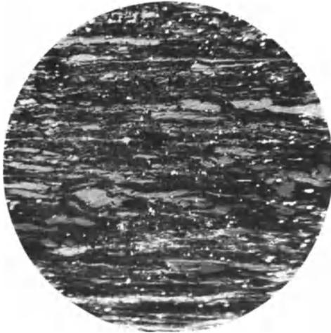
Abb. 234. Kennelschiefer der Zeche Bonifacius mit feinstreifiger Wechsellagerung von Kohlen- und Tonsubstanz, vereinzelt Mikrosporen, Blattoberhäuten sowie feinkörnigem Schwefelkies. Ölimmersion. Vergr. 100fach. Aufn. HOFFMANN.
