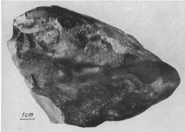
Abb. 231. Ecke eines Bogheadkohlengerölls aus dem Sandstein eines Flözes der Gasflammkohlschichten. Zeche Fürst Leopold. S.W.B.
