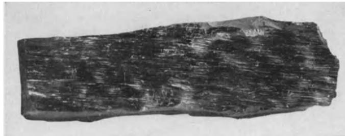
Abb. 357. Durch Faltung hervorgerufene Rutschstreifen auf einer Schichtfläche im Felde Zollverein.
