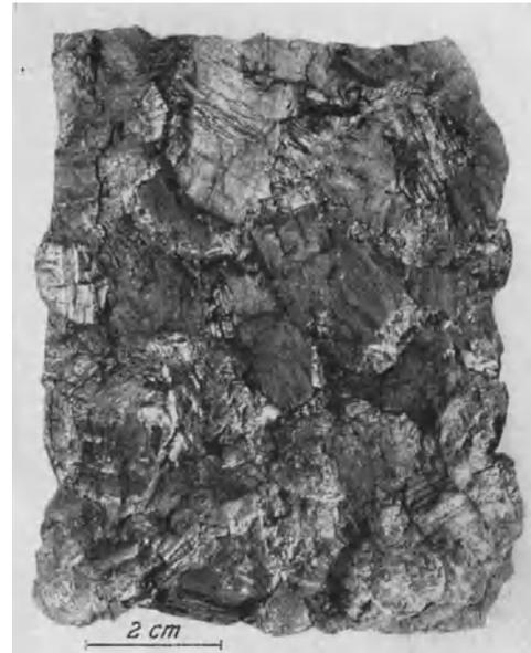
Abb. 222. Verschieden orientierte Faserkohlenpflaster auf einer Lösenfläche in Flöz Zollverein 4 der Zeche Sterkrade. S.W.B.
