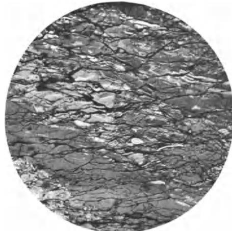
Abb. 263. Mylonit-Kohle aus einem Knallstreifen des Fettkohlenflözes Karl, Vergr. etwa 90mal. Ölimmersion. Aufn. Petrogr. Forschungsstelle Bochum.
