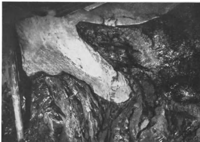
Abb. 274. Einlagerung von sandigem Schieferlan in Flöz Sonnenschein vom Hangenden aus. Zeche Helenc und Amalic. Aufn. der Zeche.
