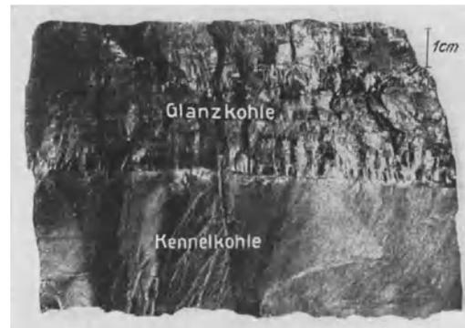
Abb. 224. Kennelkohlenpacken in einem Flöze der Gasflammkohlen-schichten. S.W.B.
