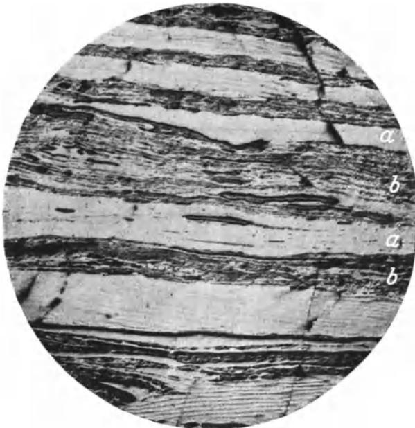
Abb. 312. Claritische Streifenkohle. *a* Vitritstreifen, zum Teil mit Holz Zellstruktur; *b* Claritstreifen mit Mikro- und Makrosporen. Milar. Vergr. 10mal.
