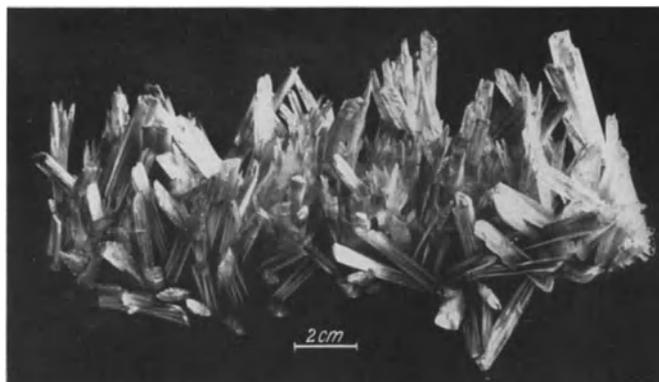
Abb. 711. Gipskristalle auf einer Grubenschiene (Bildungsdauer 1 1/2 Jahre). Zeche Victor I/II. S.W.B.
