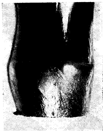
Рис. 6.7. Структура внешней поверхности сильно легированного монокристалла кремния.
