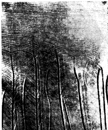
Рис. 6.3. Начальная стадия развития ячеистой структуры в продольном сечении сильно легированного монокристалла кремния.
