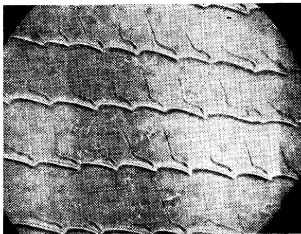
Рис. 5.12. Ячеистая структура в монокристалле сильно легированного кремния.
