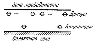
Рис. 1.9. Энергетическая диаграмма полупроводника с примесями.
