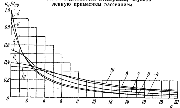
Рис. 3.10. Расчетные кривые холловской подвижности при смешанном механизме рассеяния электронов.
