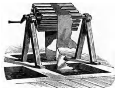
Abb. 12. Rollentransport von Hälften.
