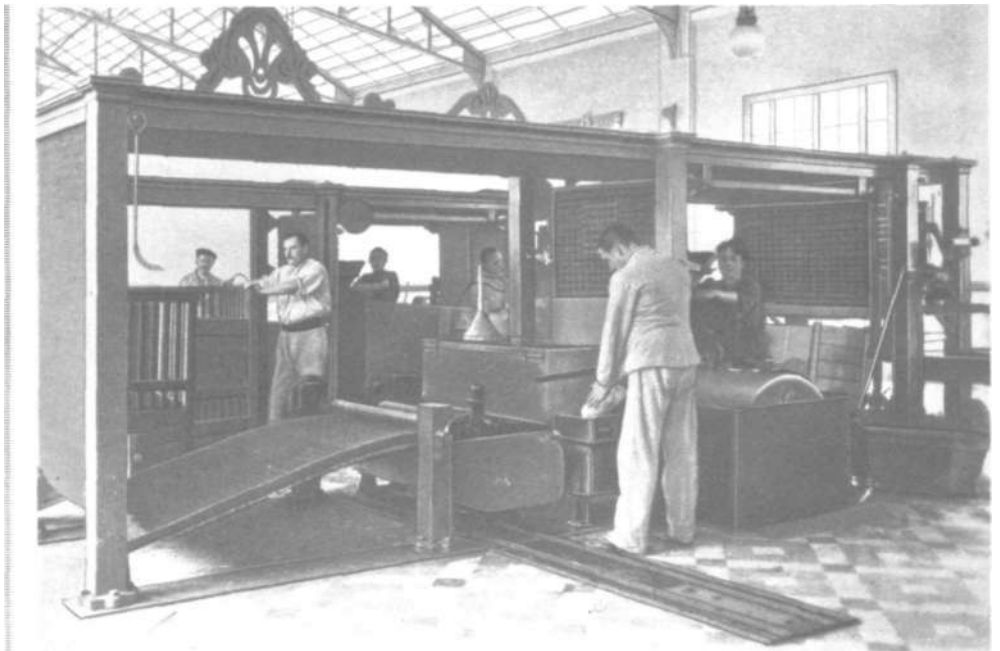
Moderne Maschine, in der die Zündhölzer am rollenden Band hergestellt werden Photos: Federmeyer
