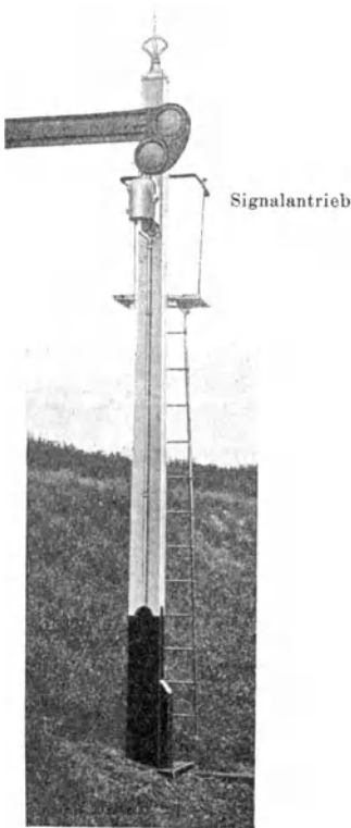
Abb. 8. Elektropneumatisch angetriebenes Signal der Londoner Distriktbahn (für Linksfahrt) Westinghouse Bremsen-Gesellschaft, London.)
