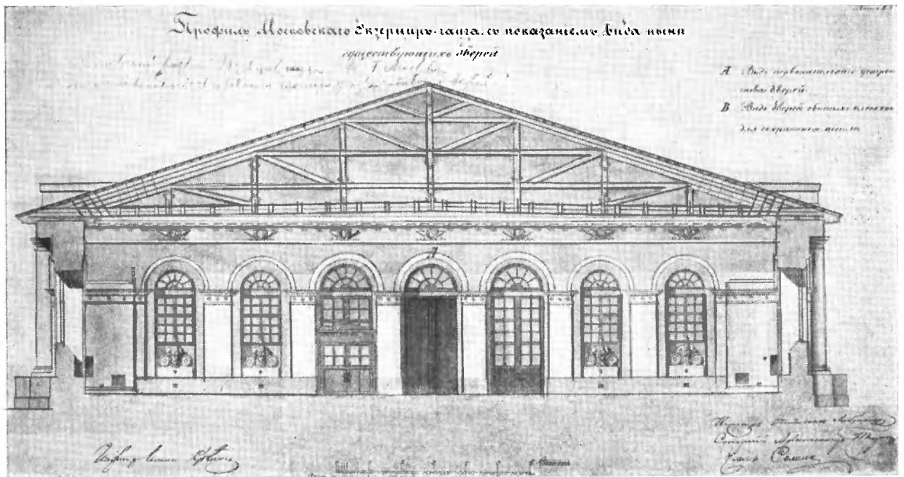
Рис. 8. Поперечный разрез манежа с изображением стропил 1939 г. Лепная отделка интерьера по рисункам О. И. Бове
