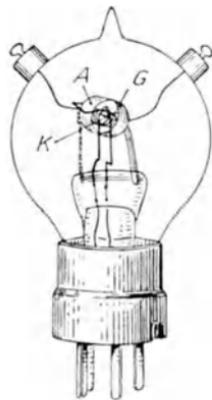
Abb. 90. „Gehörnte“ Elektrodenröhre.
