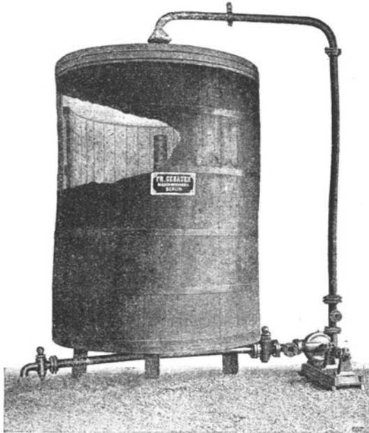
Fig. 72. Sektionsbleichkufe (Gebauer).
