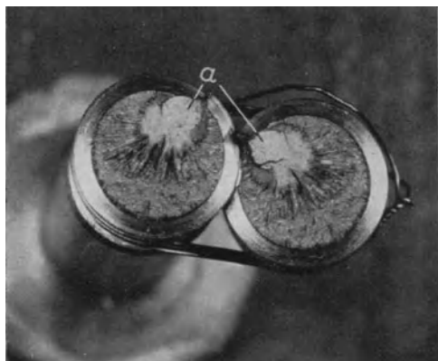
Abb. 18. Dauerbruch der Schraube 112 a a Statischer Restbruch
