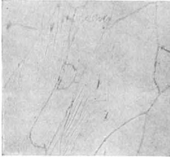
Abb. 414. Banale Fließlinien und Korndeformation in kalt deformiertem, reinem Eisen, Ätzung II, \times 200 .
