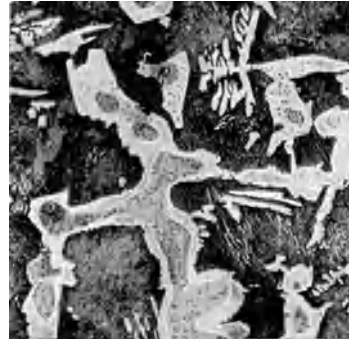
Abb. 313. Legierung mit 0,2% C und 0,6% P, ungleichmäßige Verteilung des Phosphors (Kristallseigerung), Ätzung II, \times 100 .
