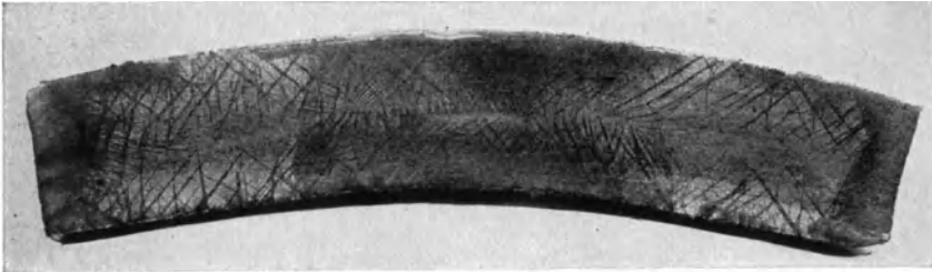
Abb. 424. Gebogenes Blech nach Fry geätzt.
