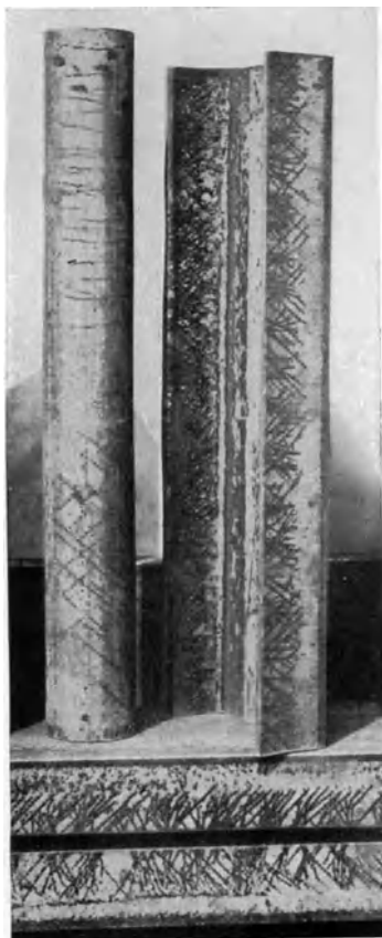
Abb. 422. Kalt gerichtetes Rohr und U-Eisen mit den durch Rosten entwickelten Fließfiguren.
