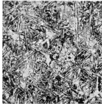
Abb. 398. Stahlguß mit 0,4 % C, bei 730° geglüht, Ätzung II, \times 100 .
