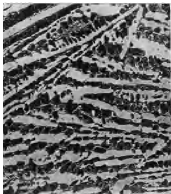
Abb. 106. Thomasroheisen, Ätzung II, \times 50 .
