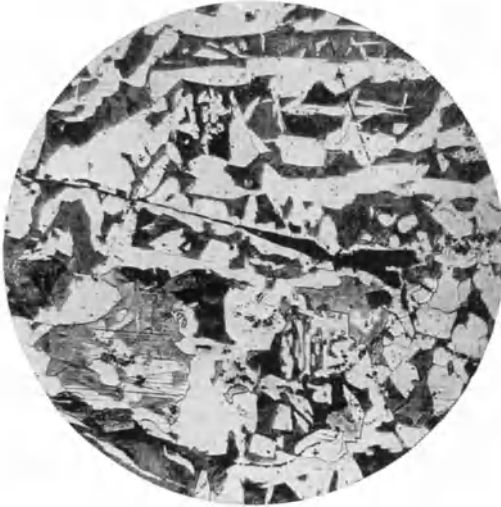
Abb. 482. Oxydreste am Ausläufer des Risses, Ätzung II, \times 100 .
