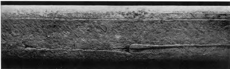
Abb. 483. Schienenlauffläche mit schuppiger Oberfläche, herrührend von Randblasen.
