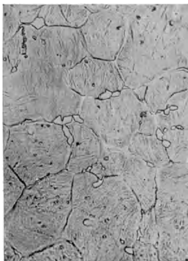
Abb. 598. Schnellarbeitsstahl, schwach überhitzt, Ätzung II, \times 500 [Pölguter (1)].
