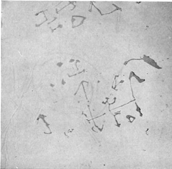
Abb. 359. Schwefelhaltige Einschlüsse innerhalb der Gasblasenseigerung Abb. 358, ungeätzt, \times 200 .
