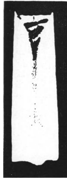
Abb. 346. Aus der gleichen Charge wie Abb. 345 gegossener Block, jedoch nicht komprimiert [Heyn und Bauer (2)].
