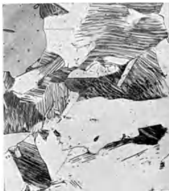
Abb. 629. Austenitisch. Nickelstahl (25 % Ni), Anlieferungszustand, Ätzung Ammonium-Persulfat, \times 500 .
