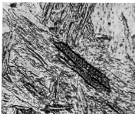
Abb. 563. Martensitisches Gefüge in einem Stahl mit 0,075 % C, Ätzung II, \times 1500 .
