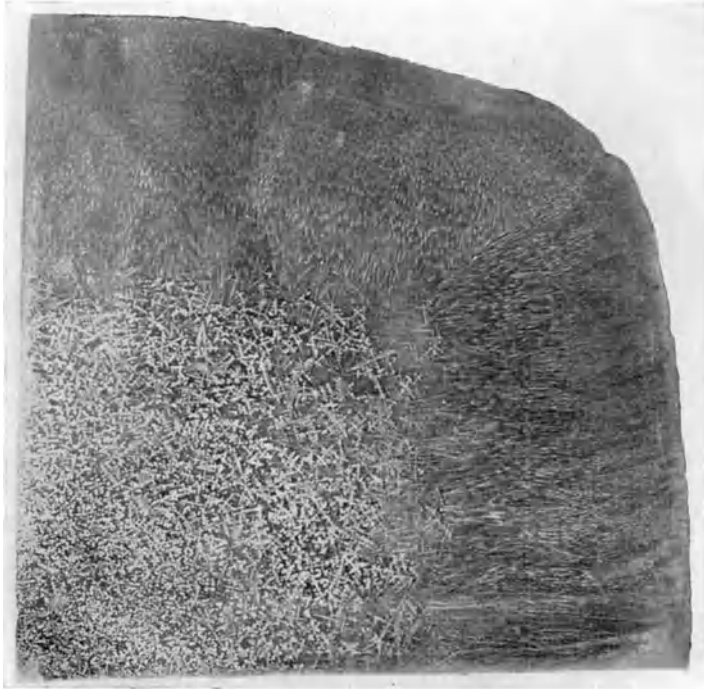
Abb. 307. Transformatorenmaterial, \frac{1}{4} Gußblock, Ätzung I, \times 1 .
