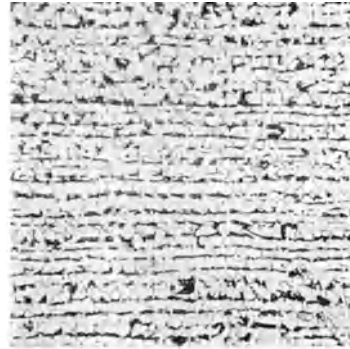
Abb. 513. Sekundre Zeilenstruktur, \text{tzung II} , \times 50 .
