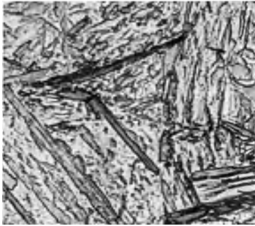
Abb. 567. Stahl mit 0,55% C, 0,26% Si und 0,61% Mn, nach überkritischer Abschreckung, Ätzung II, \times 1500 [Esser und Engelhardt (14)].
