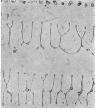
Abb. 112. Eisen-Schwefellegierung mit 2% S, ungeätzt, \times 50 .
