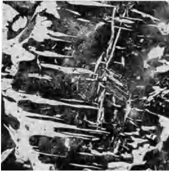
Abb. 397. Stahlguß mit 0,4 % C, ungeglüht, Ätzung II, \times 100 .
