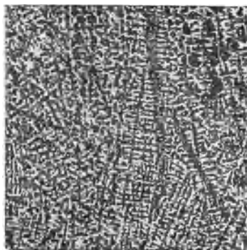
Abb. 330. Stahlguß mit dendritischer Anordnung von Ferrit und Perlit, Ätzung II, \times 5 .
