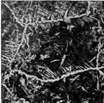
Abb. 320. Wie Abb. 318, jedoch Wandstärke größer als in Abb. 319. Grobmäsiges Ferritnetz, Auftreten paralleler Ferritstreifen, als erste Anzeichen der Widmannstätten-Struktur [Arend (1)].
