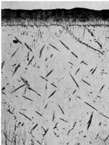
Abb. 238. Gefügebau einer bei 550° nitrierten und langsam abgekühlten Probe aus reinem Eisen [Meyer und Eilender (2)].
