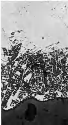
Abb. 724. „Schwarze Stelle“ am Lunker eines Tempergußstückes, Ätzung II, \times 10 .
