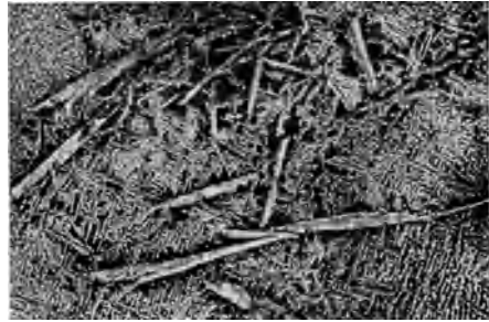
Abb. 170. 35,12% W, im Ofen abgekühlt, \varepsilon (primär aus der Schmelze abgeschieden, + \delta ; mit Pikrinsäure geätzt, \times 100 [Takeda (I)]
