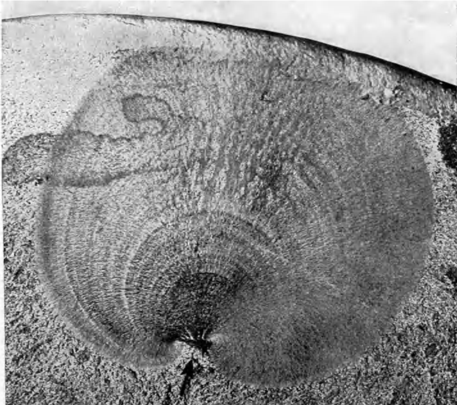
Abb. 463. Dauerbruch einer Feinblechwalze, \times 1 .
