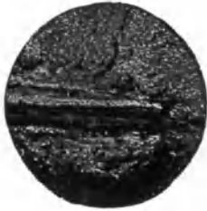
Abb. 489. Zerreißstab mit Schieferbruch, \times 3 .
