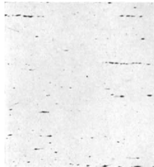
Abb. 492. Längsschnitt zu Abb. 491 mit zahlreichen Schlackeneinschlüssen, ungeätzt, \times 50 .
