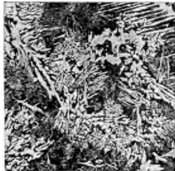
Abb. 321. Wie Abb. 318, jedoch Wandstärke größer als in Abb. 320. Äußerst grobmäsiges Ferritnetz, innerhalb der Maschen Ferrit-Perlitgemisch [Arend (1)].
