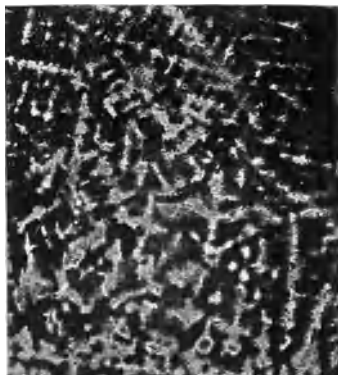
Abb. 104. Schichtkristalle in einer Eisen-Phosphorlegierung mit 0,8% P, Ätzung I, \times 4 .
