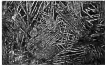
Abb. 545. Wie Abb. 544, jedoch von 1200 auf 785° rasch abgekühlt, 33 Minuten auf 785° gehalten und in Wasser abgeschreckt, kein Zementitnetzwerk. Ätzung II, \times 40 [Howe und Levy (3)].
