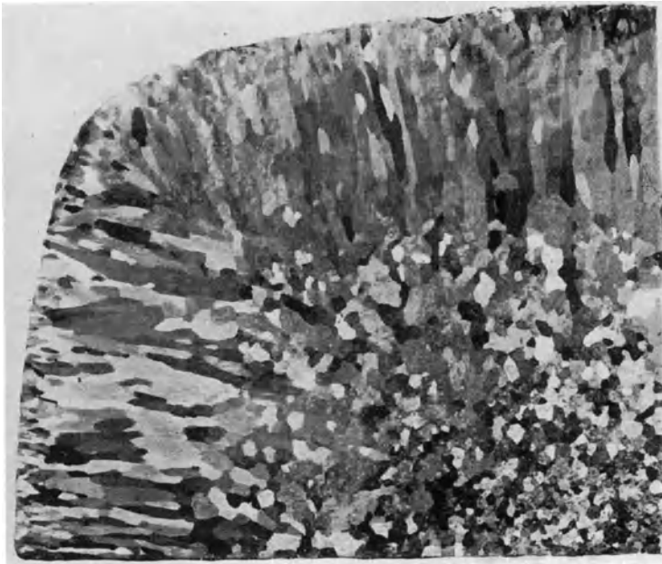
Abb. 308. Transformatorenmaterial, \frac{1}{4} Gußblock, Ätzung II, \times 1 .
