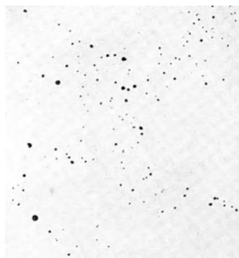
Abb. 222. Elektrolyteisen im Sauerstoffstrom geschmolzen, eutektische Anordnung der sauerstoffhaltigen Teilchen, ungeätzt, \times 50 .
