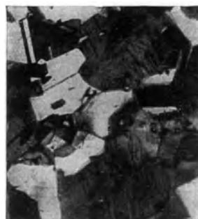
Abb. 143. Austenitischer Nickelstahl, 0,12% Kohlenstoff, 25% Nickel, Ätzung II, \times 150 [Guillet ( I )].
