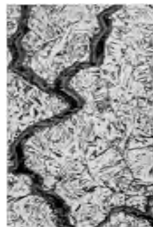
Abb. 555. Verbranntes Stahlblech, Ätzung 11, \times 5 .
