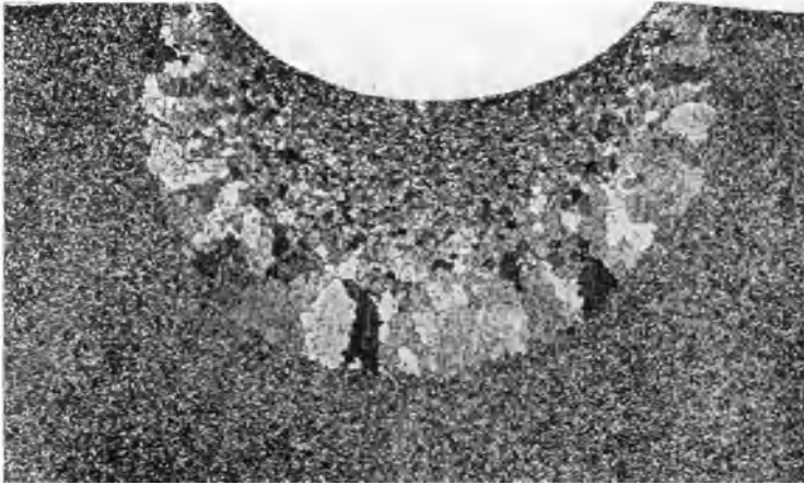
Abb. 450. Rekristallisation unterhalb eines Kugeleindrucks [Hanemann und Schrader (4)].
