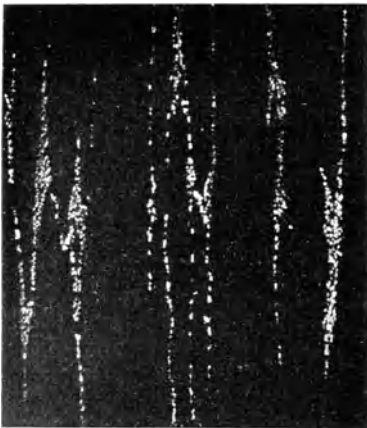
Abb. 472. Wie Abb. 469, jedoch neunfach gestreckter Querschnitt, Ätzung II, \times 100 .
