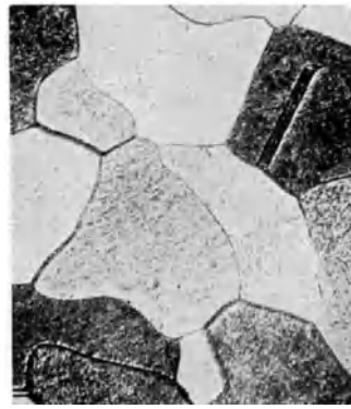
Abb. 413. Zwilling in deformiertem \alpha -Eisen, \times 100 .
