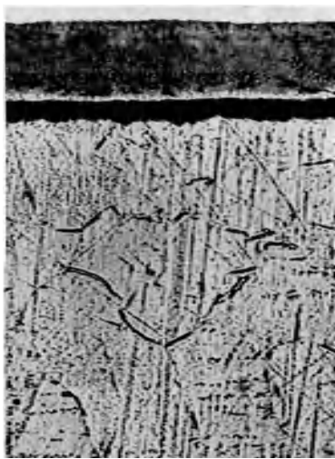
Abb. 237. Gefügebau einer bei 600° nitrierten und langsam abgekühlten Probe aus reinem Eisen [Meyer und Eilender (2)].
