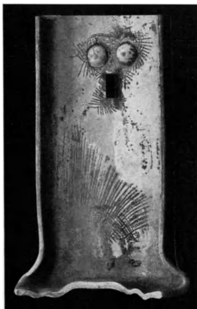
Abb. 423. Durch Rosten entwickelte Fließfiguren auf einer Eisenbahnschwelle, infolge von Stanzen, Nieten, Kappen.
