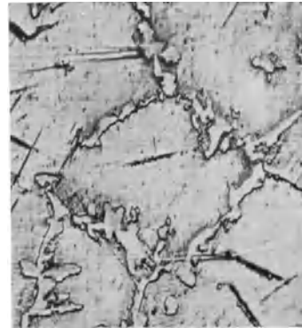
Abb. 628. Austenitischer Manganstahl auf 900^{\circ} erhitzt und verhältnismäßig langsam abgekühlt, Ätzung II, \times 200 (Rapatz).
