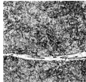
Abb. 514. Einflu der Streckung der Schlackeneinschlüsse auf die Form der Ferritausscheidung bei der sekundren Zeilenbildung. Stahl mit 0,4% C bei 750° abgeschreckt, \text{tzung II} , \times 150 .
