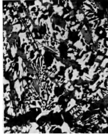
Abb. 107. Grobe Ausbildung des ternären Eutektikums nach langsamer Abkühlung (2,24% C und 6,9% P), \times 150 .
