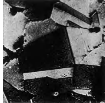
Abb. 587. Stahl mit 1,94 % C, 2,24 % Mn bei 1050° abgeschreckt, reiner Austenit, Ätzung II, \times 400 [Maurer (8)].
