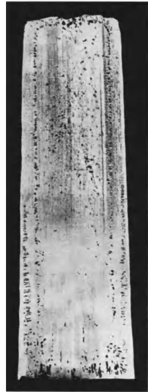
Abb. 355. Gasblasenanordnung in einem Block aus weichem, unberuhigtem Stahl (Längsschnitt).
