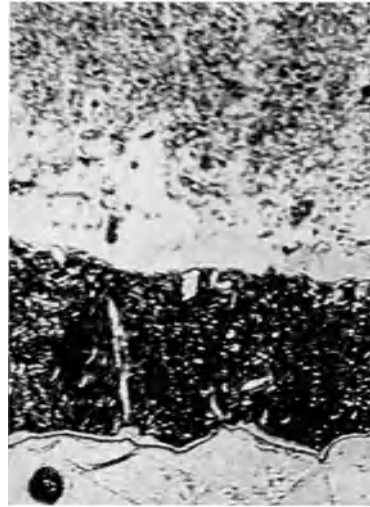
Abb. 237. Gefügebau einer bei 600° nitrierten und langsam abgekühlten Probe aus reinem Eisen [Meyer und Eilender (2)].
