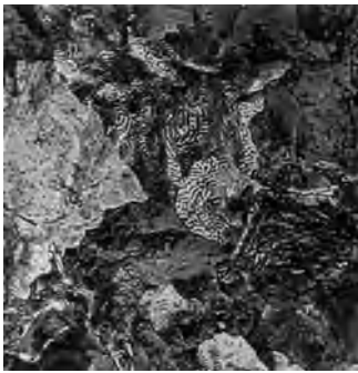
Abb. 53. Sorbit mit feinlamellarem Perlit, Ätzung II, \times 300 .
