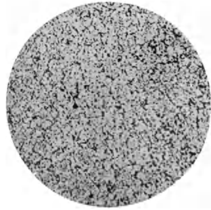
Abb. 623. Stahl mit 1,05 % C, 1,6 % Cr, 10 min auf 800° erhitzt, in Öl abgeschreckt, Natriumpikrat-ätzung. \times 500 [Oberhoffer und Emicke (28)].
