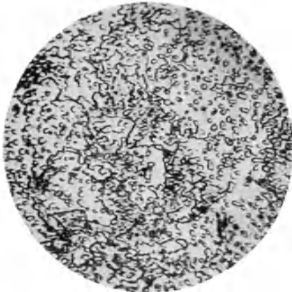
Abb. 622. Stahl mit 1,05 % C, 1,6 % Cr, 2 min auf 750° erhitzt, in Wasser abgeschreckt, Ätzung II, \times 1000 [Oberhoffer und Emicke (28)].
