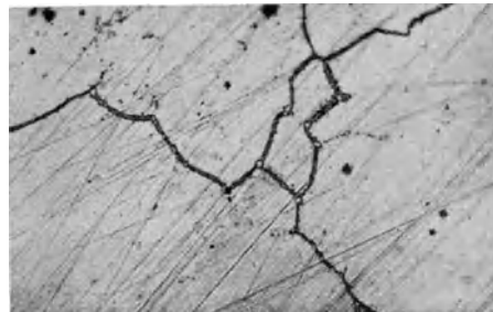
Abb. 172. Wie Abb. 171, von 1510^\circ abgeschreckt, \varepsilon + \alpha ; mit Pikrinsäure geätzt, \times 100 [Takeda (I)].
