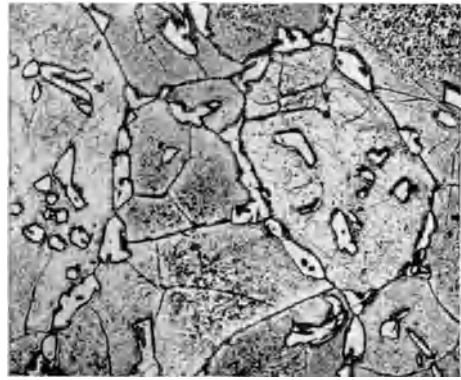
Abb. 154. Dieselbe Probe wie Abb. 153, weitere 5 h bei 1200° gegläht und abgeschreckt, \times 100 [Wever und Jellinghaus (7)].
