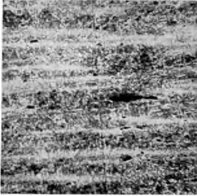
Abb. 550. Dasselbe Stück wie Abb. 548, auf 1250° erhitzt, an der Luft abgekühlt, Ätzung I, \times 50 .
