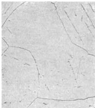
Abb. 41. Dieselbe Stelle wie 40, jedoch mit Natriumpikrat geätzt.
