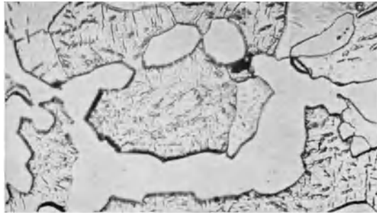
Abb. 57. Wie 56, jedoch langsam abgekühlt [Piwowarsky (I)].
