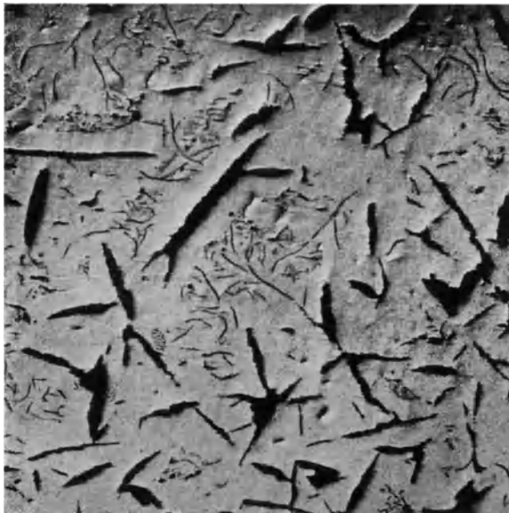
Abb. 62. Eisen-Kohlenstofflegierung mit 7% C, Garschaumgraphit und Graphiteutektikum. Ungeätzt, \times 20 (P. Goerens).
