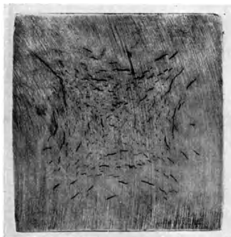
Abb. 529. Beizscheibe eines Co-Ni-Stahles mit Flocken [P. Goerens (8)].
