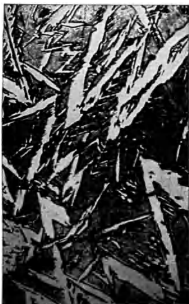
Abb. 581. Stahl mit 1,66 % C bei 1050° abgeschreckt, \frac{2}{3} Austenit, \frac{1}{3} Martensit, Ätzung II, \times 400 [Maurer (8)].
