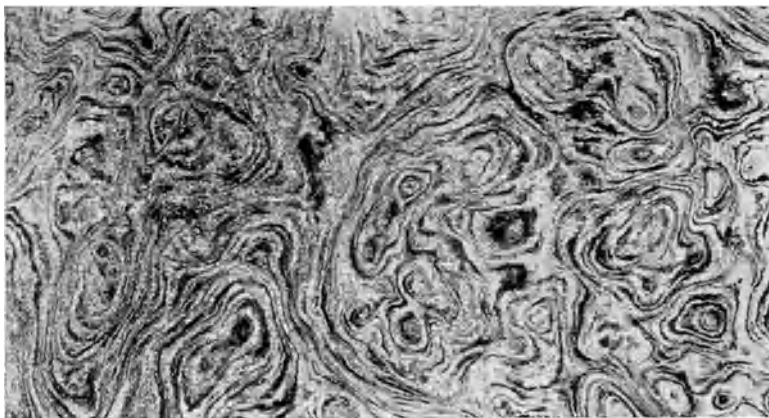
Abb. 510. Künstlich in einem Kesselblech erzeugtes Damastgefüge, Ätzung I, \times 2 .
