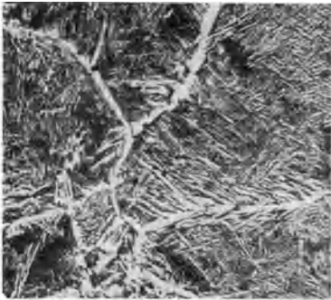
Abb. 536. Überhitzter Stahl mit 0,25 % C. Ätzung II, \times 50 .
