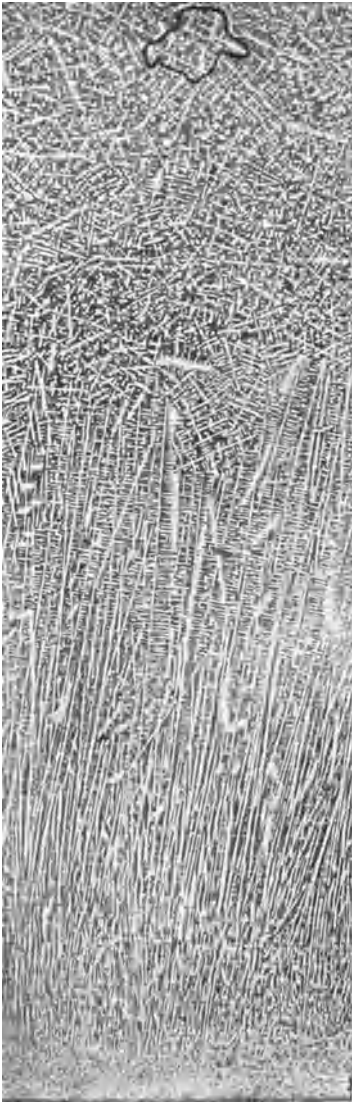
Abb. 306. Teilquerschnitt vom Rand (links) bis zur Mitte eines Gußblocks mit 0,8% C, 1% Mn, 0,1% P, Ätzung I, \times 1 .
