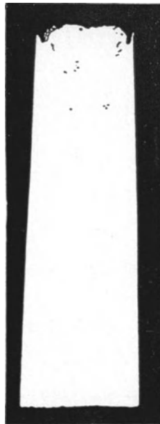
Abb. 345. Nach dem Harmet-Verfahren komprimierter Block [Heyn und Bauer (2)].
