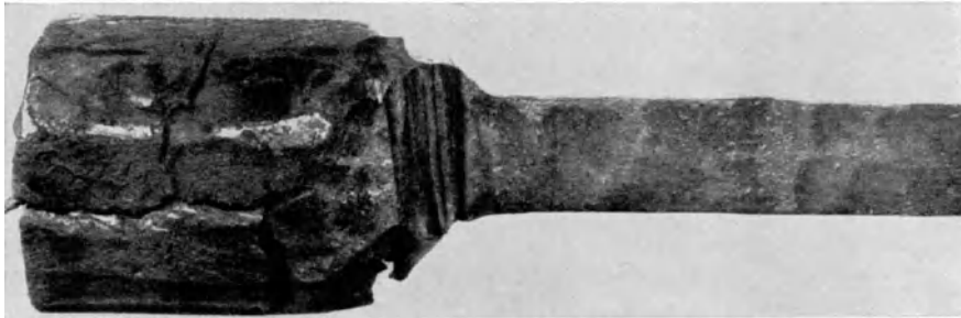
Abb. 522. Stahl entsprechend Abb. 521, zum Teil im, zum Teil oberhalb des Rotbruch-, aber unterhalb des Heißbruchgebietes geschmiedet [Niedenthal (1)].
