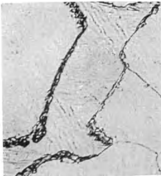
Abb. 589. Stahl mit 0,15 % C wenig über A_{c_1} in Wasser abgeschreckt, Ätzung II, \times 50 .
