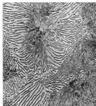
Abb. 34. Perlit, Ätzung II, \times 100 .
