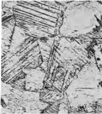
Abb. 627. Austenitischer Manganstahl, bei 1000^{\circ} in Wasser abgeschreckt, Ätzung II, \times 200 (Rapatz).
