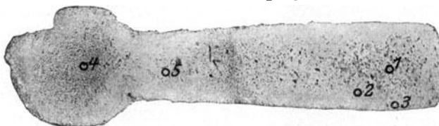
Abb. 705. Querschnitt durch einen richtig getemperten Schlüssel. Ätzung II, \times 3 .
