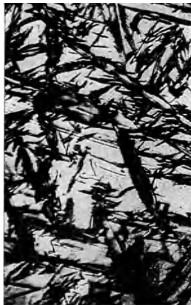
Abb. 582. Wie Abb. 581 jedoch auf 150° angelassen, Austenit noch nicht zerfallen, Ätzung II, \times 400 [Maurer (8)].
