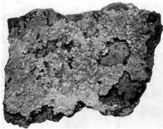
Abb. 286. 60 Ni/15 Cr-Stahl, durch schwefelhaltige Ofengase zerstört [Scherer und Riedrich (2)].
