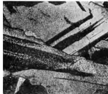
Abb. 18. Bei 1000° in Chlorkalzium heißgeätztes Elektrolyteisen. ( \gamma -Eisen.)
