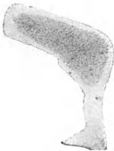
Abb. 713. Querschnitt durch eine richtig getemperte Gewindemuffe, Ätzung II, \times 2 .
