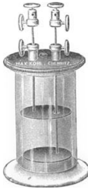
77. Normalgefäß zur Bestimmung des Widerstandes von Flüssigkeiten.
