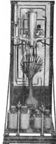
244. Quecksilberdampfgleichrichter der A. E. G. für Batterieladung (Rückseite).
