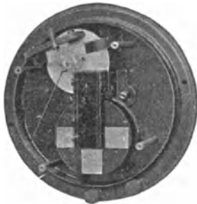
136. Innerer Aufbau des Induktions-Amperemeters der AEG.
