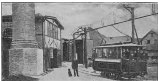
428. Erste elektrische Straßenbahn in Offenbach a. M. mit oberirdischer Stromzuführung mittels geschligter Röhren.
