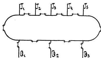
422. Schema einer Anlage mit Ringsammelschiene.
