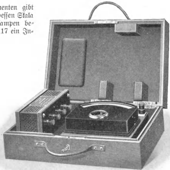
115. Drehspulen-Präzisions-Millivoltmeter von Siemens & Halske mit Vorschaltwiderständen zur Verwendung als Präzisions-Voltmeter.
