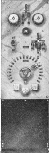
243. Quecksilberdampfgleichrichter der A. E. G. für Batterieladung (Vorderansicht).
