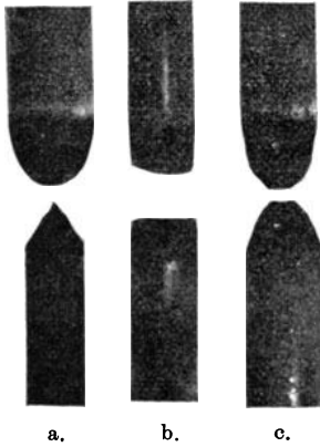
245. Brennflächen der Kohlen a) bei Gleichstrom unter Luftzutritt. b) bei Gleichstrom unt. Luftabschluß. c) bei Wechselstrom unter Luftzutritt.
