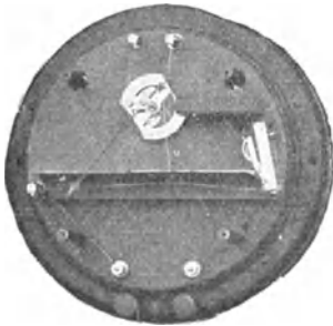
143. Innere Anordnung eines Schalttafel-Hitzdrahtvoltmeters der AEG.
