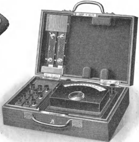
114. Drehspulen-Präzisions-Millivoltmeter von Siemens & Halske mit verschiedenen Nebenschlüssen zur Verwendung als Präzisions-Amperemeter.
