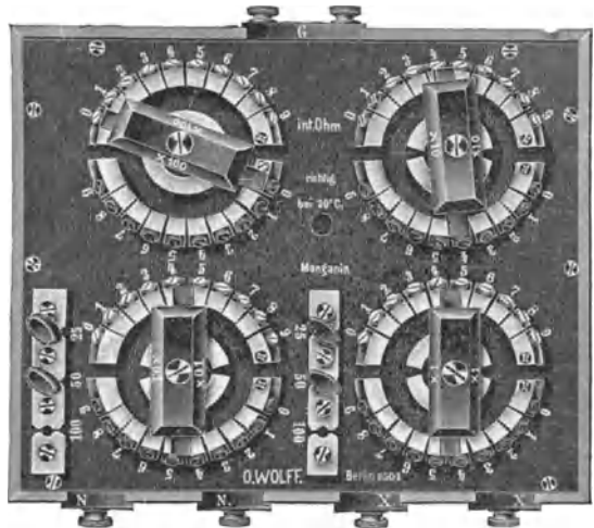
81. Thomsonsche Doppelbrücke (Ansicht der Widerstandskontakte).
