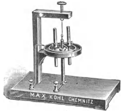
32. Rotation eines Magneten unter dem Einfluß eines stromdurchflossenen Leiters.
