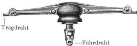
441. Verbindung des Fahrdrabhtes mit dem Tragdrabht.
