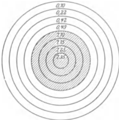
Abb. 137. Abfließen des Kohlenstoffs aus dem Kern nach dem Rande zu.
