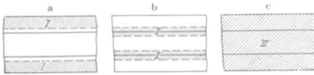
Abb. 122. Probenahme aus einem Kesselblech.
