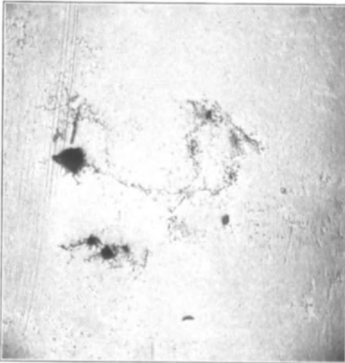
Abb. 36. Tonerde ( \text{Al}_2\text{O}_3 ) im Flußeisen.
