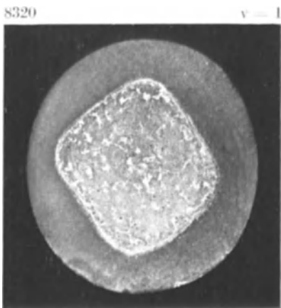
Abb. 28. Rundeisen mit dem von Oberhoffer verbesserten Rosenhain'schen Ätzmittel geätzt.
