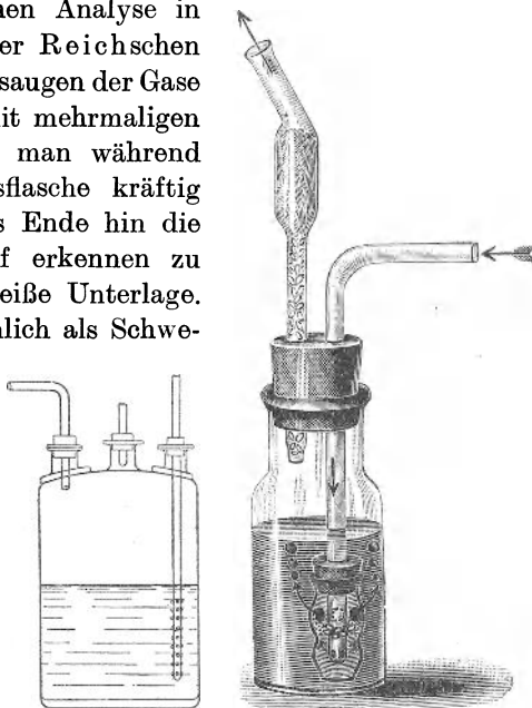
Abb. 20 u. 21. Absorptionsflaschen zum Reichschen Apparat.
