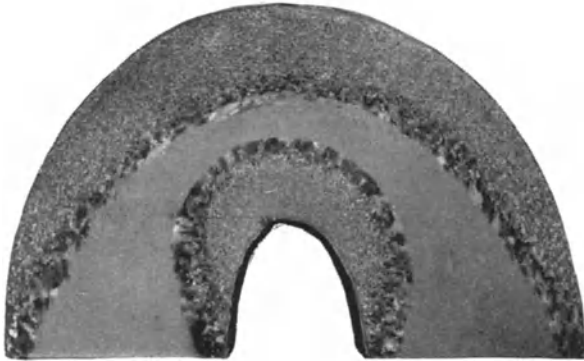
Abb. 101. Biegeprobe aus sehr weichem Flußeisen mit 0,05 v.H. Kohlenstoff, 6 Stunden bei 730^{\circ}\text{C} geblüht. Rückkristallisation. Nat. Größe.
