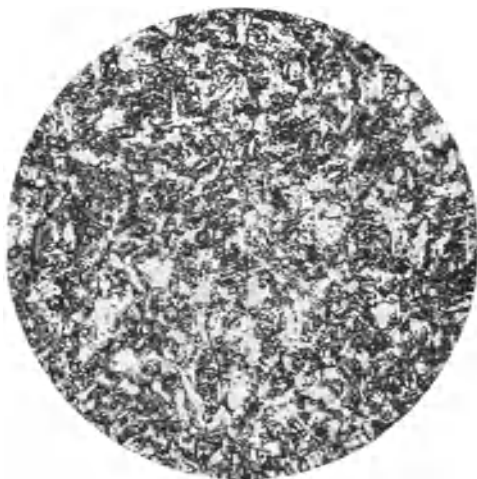
Abb. 192. Nickelstahl mit 0,14 v.H. Kohlenstoff und 8,1 v.H. Nickel. Ferrit und Perlit. V = 200 .
