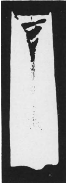
Abb. 53. Rohblock, nicht gepreßt.
