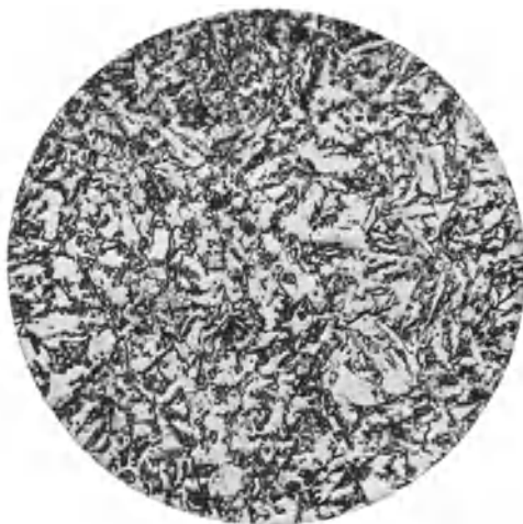
Abb. 201. Chromnickelstahl mit 0,13 v.H. Kohlenstoff, 2 v.H. Chrom und 3,8 v.H. Nickel. V = 200 .
