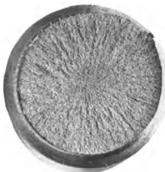
Abb. 19. Bruchfläche einer zerrissenen Schraube. V = 1\frac{1}{2} .
