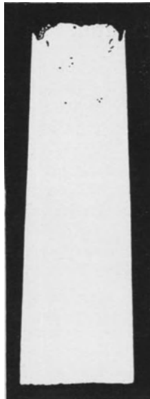
Abb. 54. Nach dem Harmetverfahren gepreßter Block.
