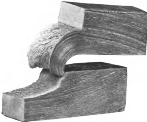
Abb. 197. Nickelstahl mit etwa 30 v.H. Nickel. \frac{1}{2} nat. Größe.
