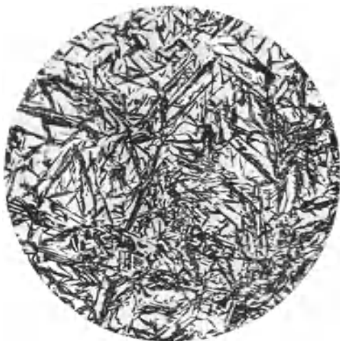
Abb. 193. Wie Abb. 192, eingesetzt. Randschicht. Martensit. V = 200 .
