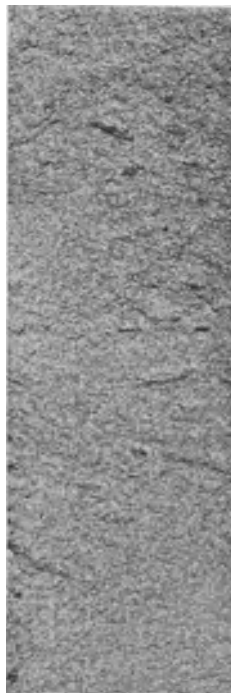
Abb. 140. Sonderstahlguß, geglüht. Bruchgefüge. Nat. Größe.
