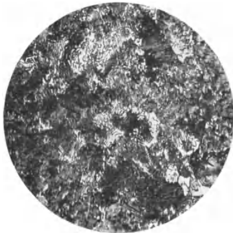
Abb. 7. Flußstahl mit 0,83 v.H. Kohlenstoff. Perlit, wenig Ferrit. V = 200.
