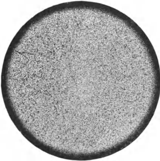
Abb 110. Rundstab aus Flußeisen mit 0,14 v.H. Kohlenstoff während 5 Stunden bei 900° C eingesetzt. V = 5.
