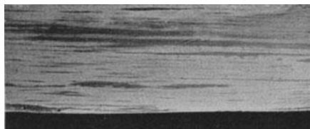
Abb. 88. Seigerungszeilen in einem gehärteten Ritzel aus Siemens-Martin-stahl. Längsschnitt durch den Zahn. Mit Kupferammoniumchlorid geätzt. Nat. Größe.
