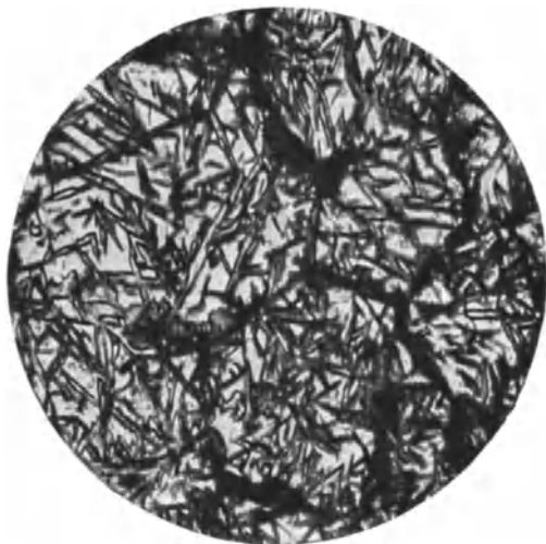
Abb. 94. Überhitzter Stahl mit 1,34 v.H. Kohlenstoff. Grobes Korn. V = 200 .
