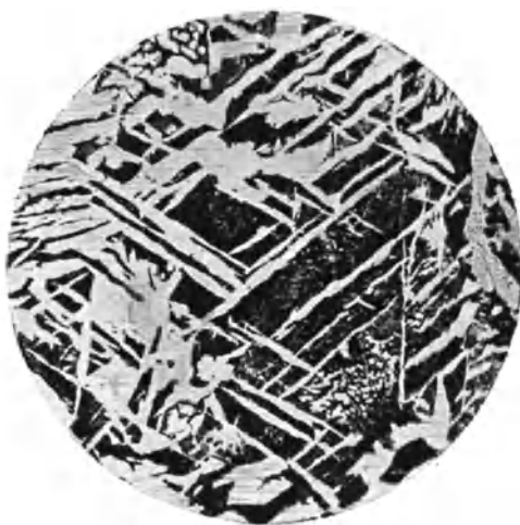
Abb. 131. Stahlguß mit 0,35 v.H. Kohlenstoff. Gußstruktur. Widmann- stättensches Gefüge. V = 80.
