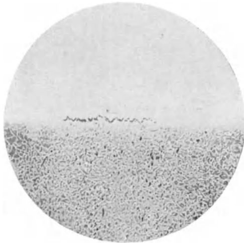
Abb. 75. Verschweißung von weichem Eisen (obere Bildhälfte) mit Stahl. Riß in der Schweißnaht. V = 20 .
