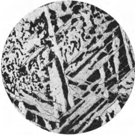
Abb. 1. Ungleichmäßige Kornlagerung. Stahlguß, ungeglüht. Vergrößerung (V) = 80.
