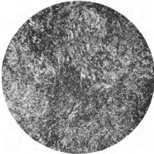
Abb. 8. Flußstahl mit 0,98 v.H. Kohlenstoff. Perlit. V = 200 .
