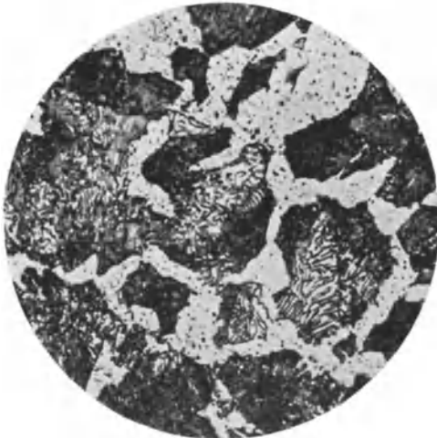
Abb. 92. Überhitzter Stahl mit 0,57 v.H. Kohlenstoff. Grobes Gefüge. V = 200 .
