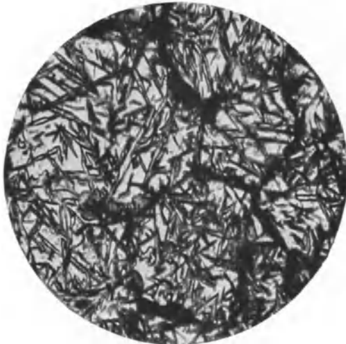
Abb. 31. Gehärteter Werkzeugstahl. Heller Austenit zwischen den Martensitnadeln. V = 200 .
