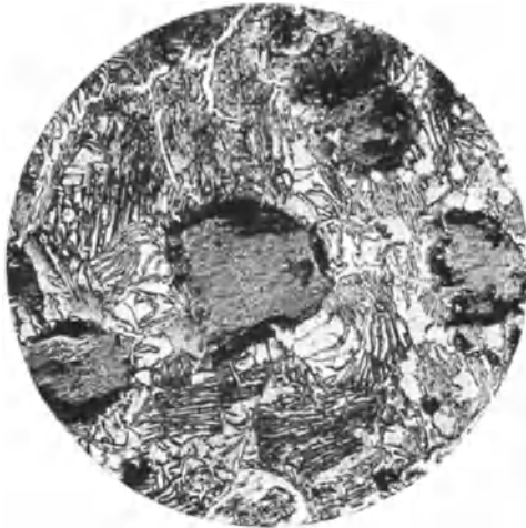
Abb. 17. Temperguß. Temperkohle, Ferrit und Perlit. V = 100 .
