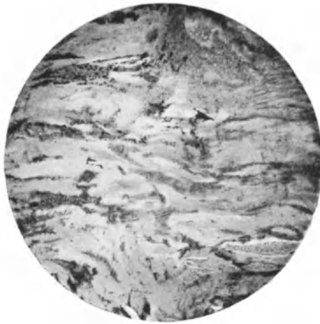
Abb. 152. Rundstab aus Schweiß Eisen. V = 7 .
