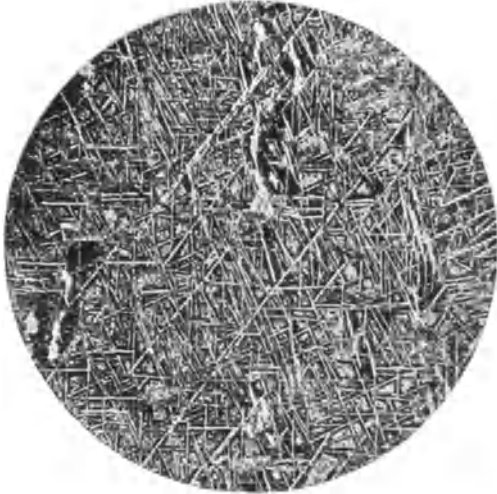
Abb. 106. Nadelförmiger Zementit in der Außenschicht eines im Einsatz gehärteten weichen Stahls. V = 100 .
