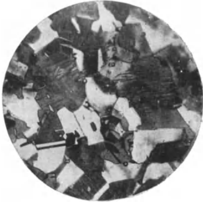
Abb. 187. Polyedrischer (austenitischer) Nickelstahl mit 0,12 v.H. Kohlenstoff und 25 v.H. Nickel. V = 150 .
