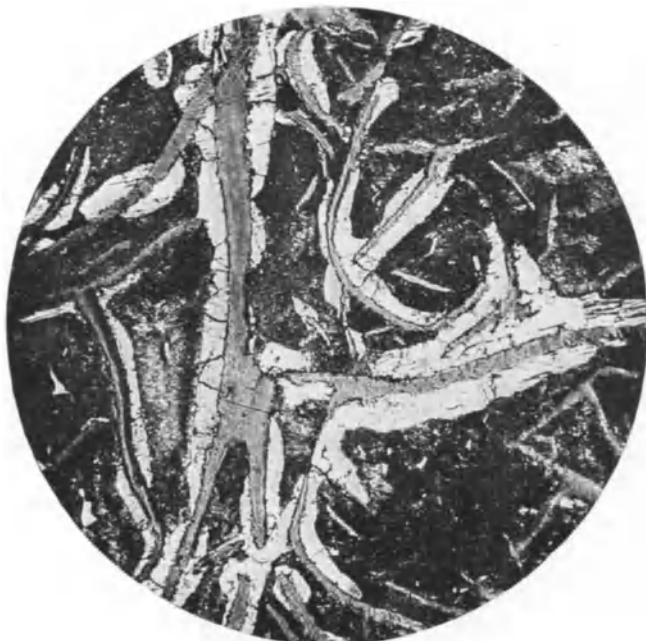
Abb. 13. Graues Roheisen. Graphit (graue Adern), Ferrit (weiße Höfe) und Perlit (dunkel). V = 100 .
