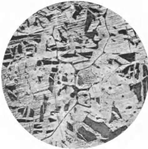
Abb. 57. Flußeisen mit 0,24 v.H. Kohlenstoff und 0,40 v.H. Schwefel. Ferrit, Perlit und Schwefeleiseneutektikum (netzartig). V = 100 .
