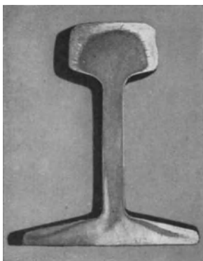
Abb. 56. Querschliff einer Grubenschiene. Seigerung. \frac{1}{2} nat. Größe.
