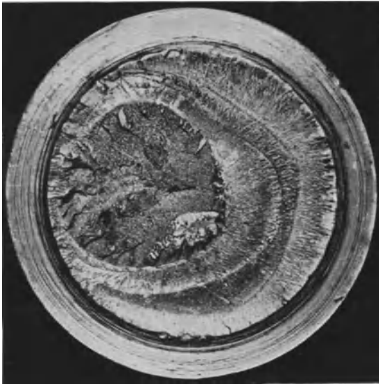
Abb. 24. Bruchfläche einer im Betriebe gebrochenen Achse eines Elektromotors. Dauerbruch. V = 3\frac{1}{2} .
