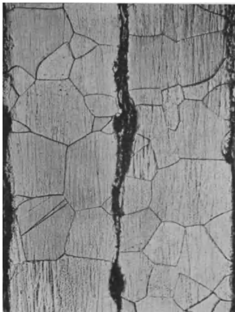
Abb. 156. Dynamobleche aus Elektrolyteisen. Ferrit. V = 100 .
