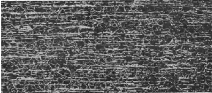
Abb. 81. Zeilenstruktur in einem mittelharten Kohlenstoffstahl. Helle Ferrit- und dunkle Perlitstreifen. V = 14 .
