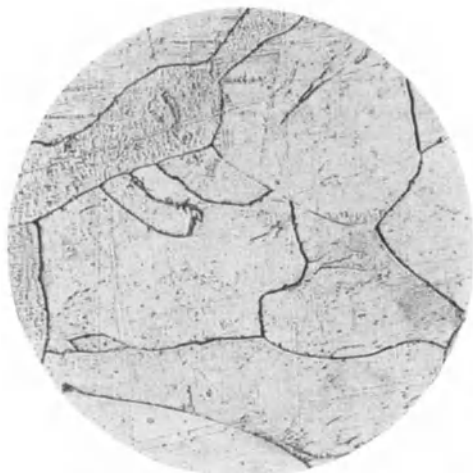
Abb. 95. Wie Abb. 4. Reines Eisen 3 Stunden bei 1200° C geglüht. Grober Ferrit. V = 200 .
