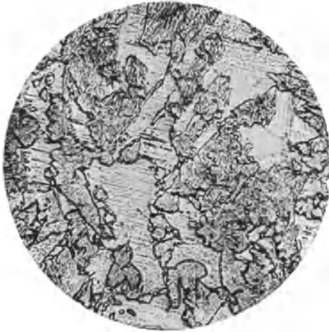
Abb. 34. Weicher Stahl mit 0,35 v.H. Kohlenstoff bei 750° C in Wasser abgeschreckt. Ferrit und Martensit. V = 200 .
