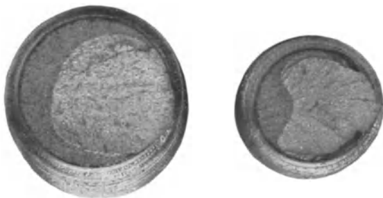
Abb. 21. Bruchflächen von zerrissenen Schrauben. Nat. Größe.
