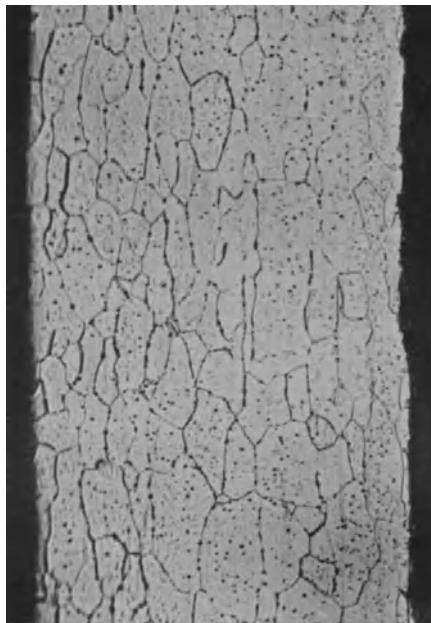
Abb. 164. Gewöhnliches Dynamoblech. V = 100 .
