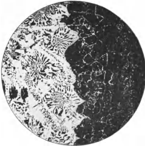
Abb. 123. Gefüge eines im Einsatz gehärteten Stahls nach der Aufnahme von Phosphor aus dem Härtemittel (links). V = 100 .
