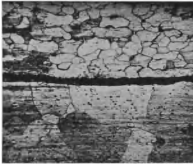
Abb. 74. Hammerschlag in der Schweißnaht. V = 50 .
