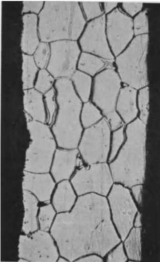
Abb. 165. Siliziertes Dynamoblech. V = 100.
