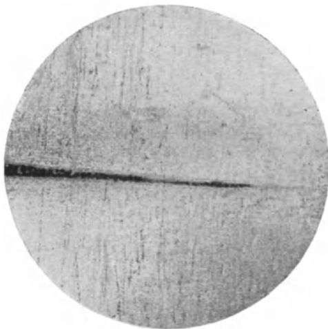
Abb. 85. Seigerungsstreifen im Siemens-Martinstahl. Mit Kupferammoniumchlorid geätzt. V = 7 .
