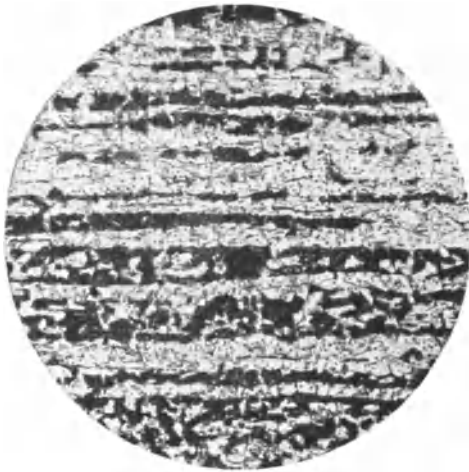
Abb. 76. Gezogener Eisendraht mit 0,28 v.H. Kohlenstoff. V = 100 .
