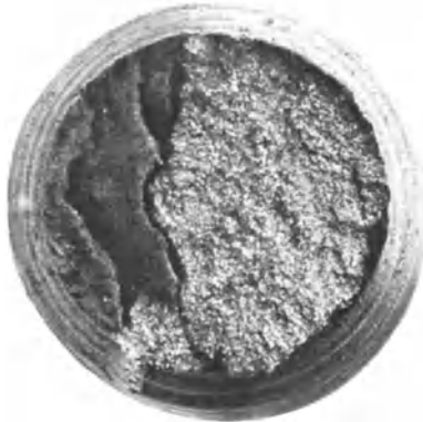
Abb. 23. Bruchfläche einer zerrissenen Schraube. Schieferbruch. V = 2 .
