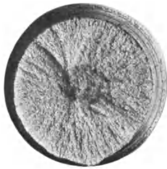
Abb. 20. Bruchfläche einer zerrissenen Schraube. V = 1\frac{1}{2} .
