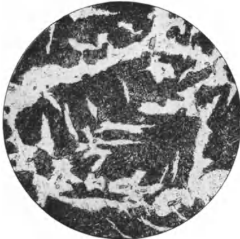
Abb. 115. Siemens-Martinstahl für im Einsatz zu härtende Zahnräder. Ferrit und Perlit. V=200 .
