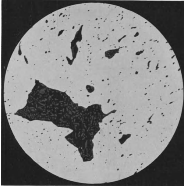
Abb. 150. Schweißisen, ungeätzt. Schweißschlacke, kristallisiert. V = 100 .
