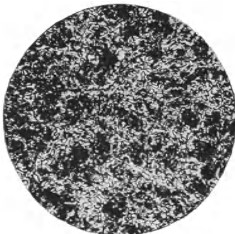
Abb. 69. Wie Abb. 68. Nach der Glühung geschmiedet. Feines Gefüge. V = 200 .
