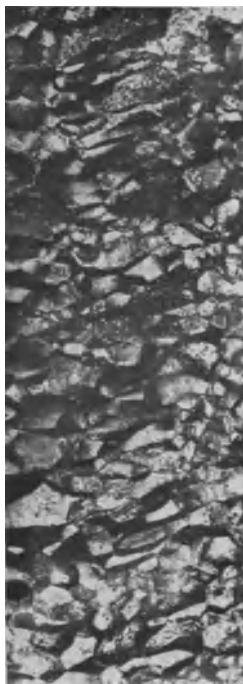
Abb. 139. Sonderstahlguß, ungeglüht. Bruchgefüge. Nat. Größe.
