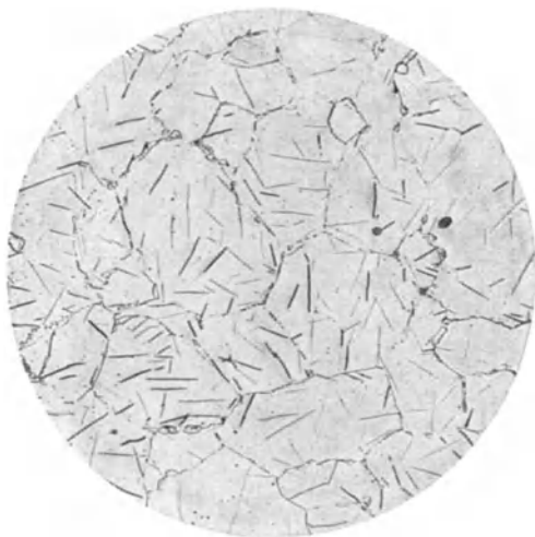
Abb. 66. Eisen-Stickstofflegierung mit geringem Stickstoffgehalt. V = 100 .
