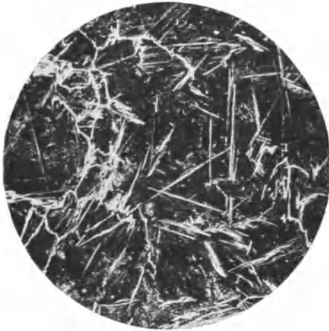
Abb. 10. Kohlenstoffstahl mit 1,54 v.H. Kohlenstoff. Perlit (dunkel) und Zementit (hell). V = 200 .
