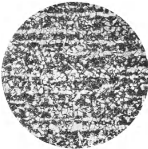
Abb 77 Gezogener Stahldraht mit 0,52 v.H. Kohlenstoff. V = 100 .
