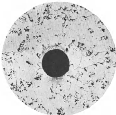
Abb. 65. Gasblase im Stahlguß. V = 80 .
