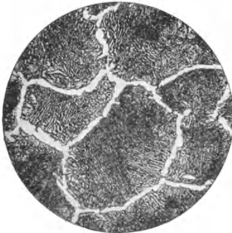
Abb. 104. Zementstahl mit 1,30 v.H. Kohlenstoff. Perlit und Zementit. 12 Tage in Buchenholzkohle bei 1100 C zementiert. V = 200 .
