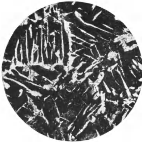
Abb. 133. Stahlguß mit 0,68 v.H. Kohlenstoff. Gußstruktur. V = 80.
