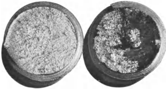
Abb. 22. Bruchflächen von zerrissenen Schrauben. Nat. Größe.
