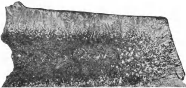
Abb. 12. Halbiertes Roheisen. Bruchfläche. Nat. Größe.
