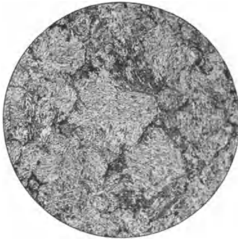
Abb. 118. Zu Abb. 116. Kleingefüge der Zone 2. V = 200.
