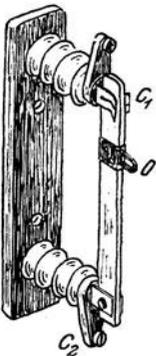
Fig. 248. Einfacher Trennschalter.
