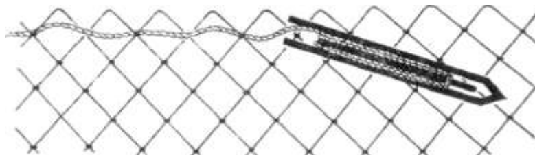
4. Веревку каркаса тайника пропускают по краю сети через каждую ячейку.
