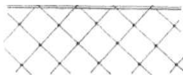
14. Ячейя правильно посаженной паутинной сети имеет форму квадрата.
