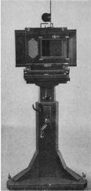
Abb. 16. Photographische Kamera von hinten mit einem Rahmen, der eine dreiteilige Aufnahme gestattet. \frac{1}{18} n. Gr.
