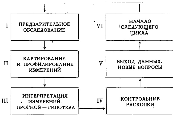
Рис. 12. Схема цикла геофизического исследования археологического объекта
