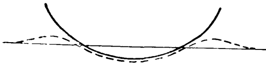
Рис. 186. Течение металла под индентором при испытании на твердость
