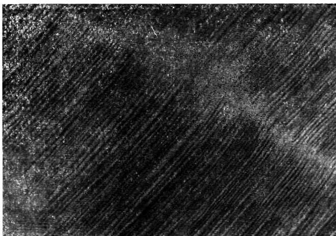
Рис. 122. Деформационные полосы в алюминии, возникающие при 10%-ной деформации растяжения. \times 100
