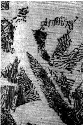
Рис. 354. Микроструктура доэктоидного феррита (сталь с 0,35% С, медленное охлаждение. \times 450 )
