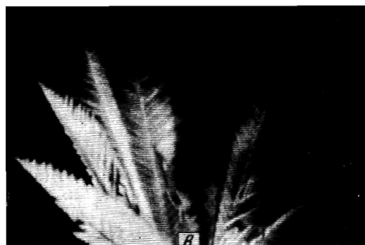
Рис. 197. Примеры дендритного затвердевания: а — свинец. \times 1,1 ; б — нержавеющая сталь; шлиф протравлен. \times 9/4 ; в — лед. \times 1,4
