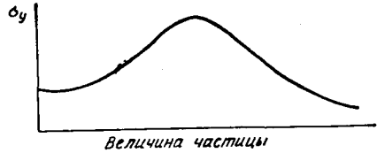
Рис. 136. Влияние размеров частиц на величину предела текучести
