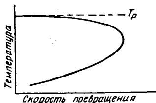
Рис. 366. Влияние температуры на скорость эвтектоидного превращения
