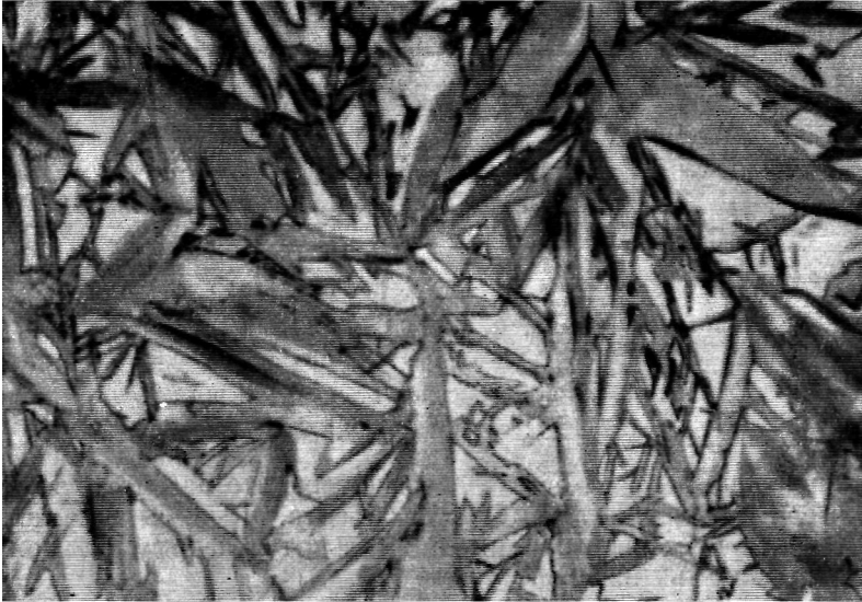
Рис. 318. Микроструктура мартенсита. \times 1660
