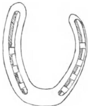
Abb. 71. Eisen für einen stark bodenengen Huf.
