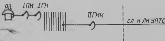
Соединительные линии к учрежденческим телефонным станциям ручного обслуживания небольшой емкости включаются в поле ЛИ (см. рис. 13.8).
