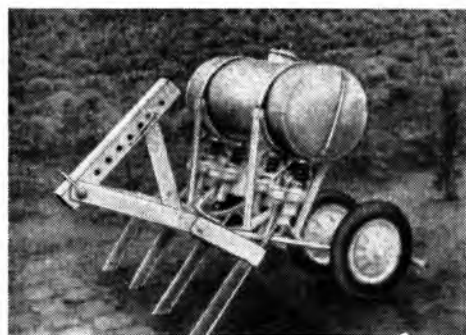
Рис. 33. Прицепная машина для обеззараживания почвы (Гентская модель).
