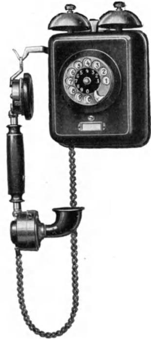
Abb. 61b. Wandfernsprecher für Selbstanschlußbetrieb.
