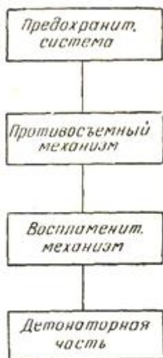
Рис. 59. Схема комплектования взрывателей-ловушек
