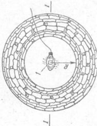
Рис. 167. Круговой защитный вал из мешков с песком (размер мешка: 40 \times 70 см; вес 15-25 кг):
