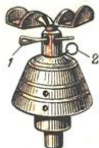
Рис. 66. Закрепление ветрянки и ударника взрывателя:
