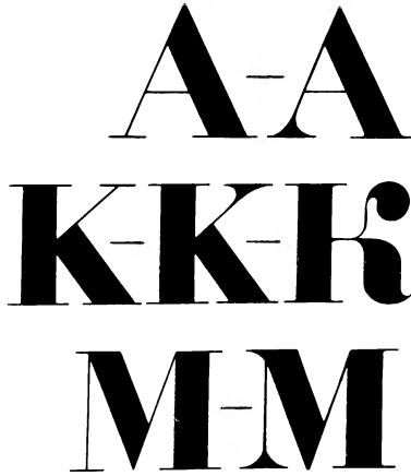
Рис. 83. Изменение формы засечек некоторых букв шрифта типа новой антиквы с целью выравнивания цветности элементов.
