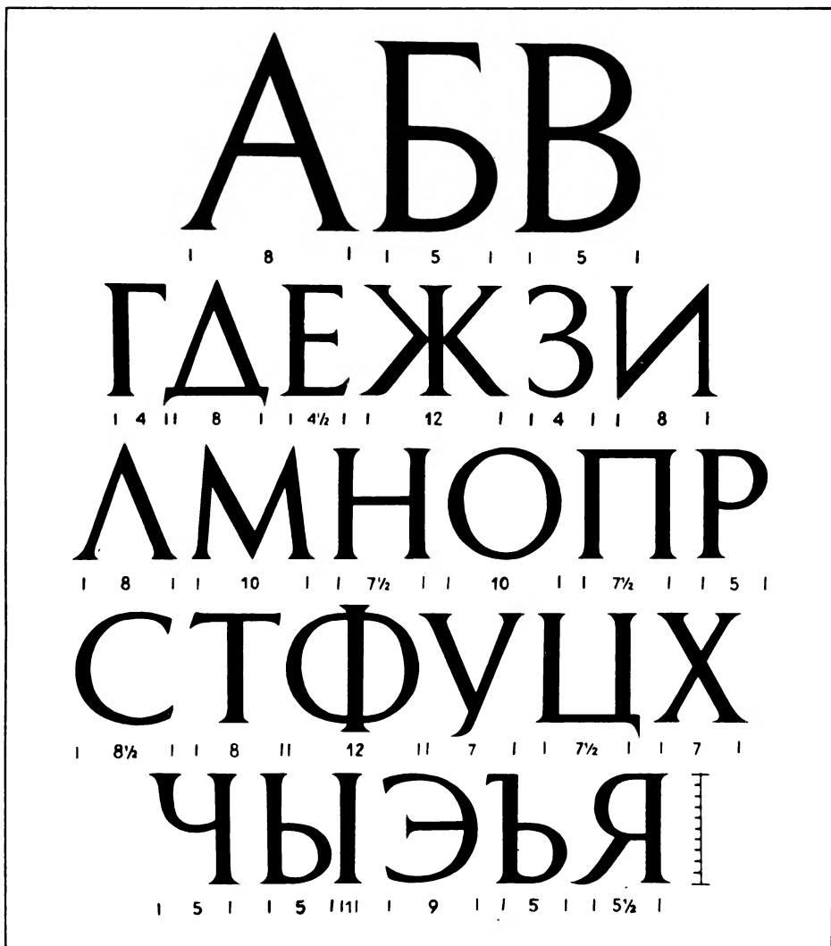
Рис. 63. Построение шрифта типа антиквы по модулю. Цифрами указана ширина букв относительно толщины основного штриха, т. е. модуля.
