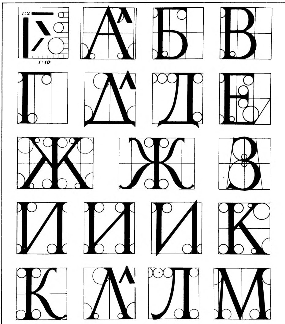
Рис. 61—62. Построение шрифта типа антиквы.
