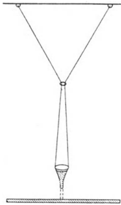
Abb. 5. Zusammensetzung von Pendelschwingungen.
