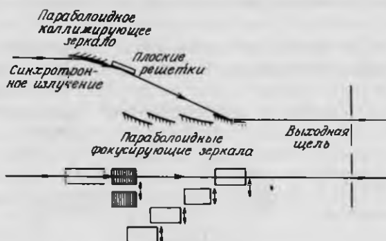
Рис. 10.7. Монохроматор с плоской решеткой, установленный на накопительном кольце NSLS [19].
