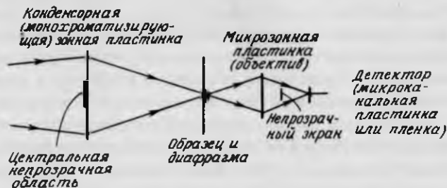
РИС. 10.13. Схема изображающего рентгеновского микроскопа на зонных пластинках.
