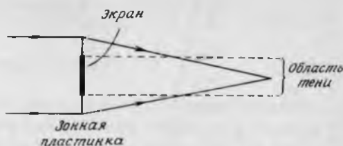
РИС. 8.14. Формирование изображения в тени экранирующей зонной пластинки.
