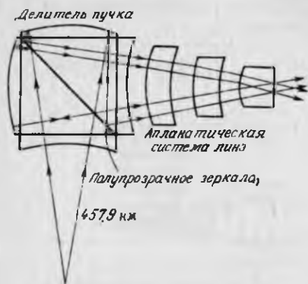
РИС. 9.20. Апланатическая система линз, формирующая дифракционную картину в виде структуры конденсорной зонной пластинки для рентгеновской сканирующей микроскопии [28].
