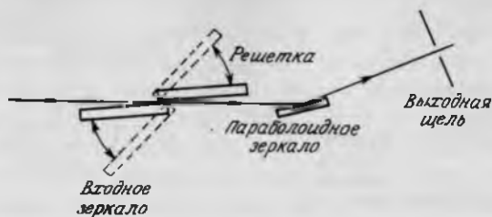
РИС. 10.6. Монохроматор с вращающейся плоской решеткой [18].
