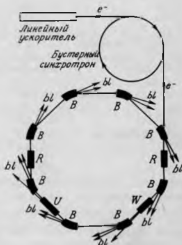
Рис. 1.8. Схема источника синхротронного излучения: B – поворотные магниты, bl – каналы синхротронного излучения, R – радиочастотные резонаторы, U – ондулятор, W – виглер.
