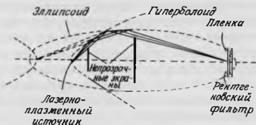
РИС. 10.22. Рентгеновский микроскоп скользящего падения типа Вольтера I, используемый в лазерно-плазменных исследованиях [67].
