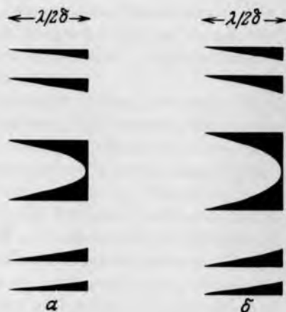
РИС. 8.38. Профили фазовых зонных пластинок с оптимизированными профилями при \beta = 0.5\delta (а) и при \beta = \delta (б).
