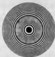
РИС. 8.19. Составная зонная пластинка с числом зон 20 в каждой части (20, 20).
