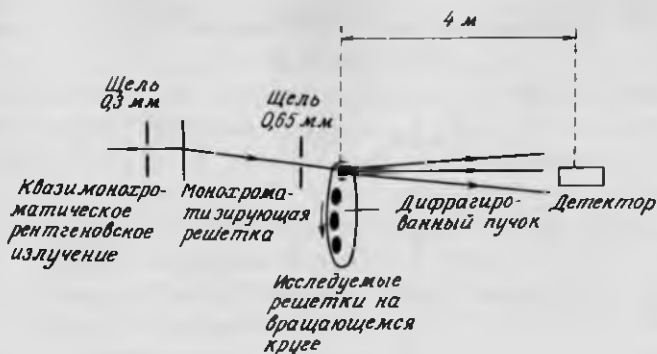
РИС. 11.2. Схема эксперимента по измерению оптических констант с помощью пропускающей решетки [30].
