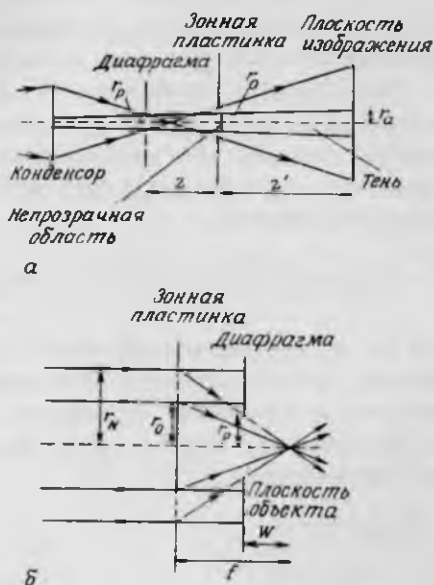
РИС. 10.18. К выводу соотношения между радиусом непрозрачной области зонной пластинки и размером входного зрачка (микродиафрагмы) для изображающего (а) и сканирующего (б) микроскопов.
