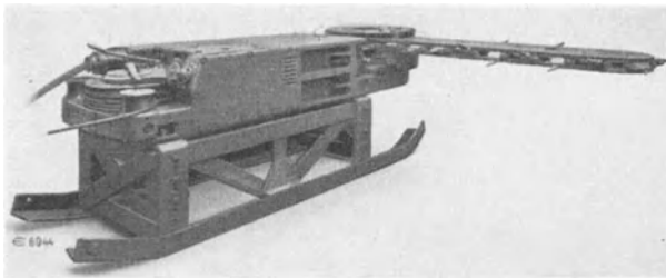
Abb. 152. Elektrische Kettenschrämmaschine auf Untergestell.
