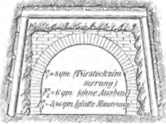
Abb. 473. Streckenquerschnitte mit gleichem Widerstande für den Durchzug der Luft.
