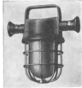
Abb. 576. Elektrische Abbauleuchte der SSW.
