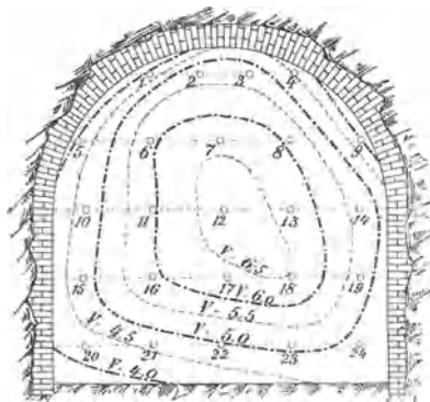
Abb. 464. Kurven gleicher Wettergeschwindigkeit in einem Streckenquerschnitt.
