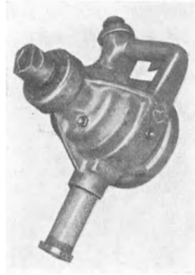
Abb. 176. Ansicht einer Flottmann-Freihand-Bohrmaschine.
