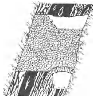
Abb. 368. Feldortstrecke mit Gewölbemauerung.
