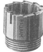
Abb. 104. Bohrkrone mit Hartmetallprismen.
