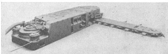
Abb. 150. Mit Preßluft angetriebene Kettenschrämmaschine von Eickhoff.
