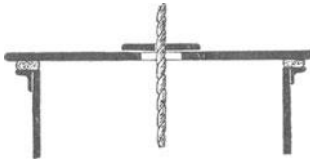
Abb. 499. Schachtdeckel mit kleinerem Deckel für das Seilloch.
