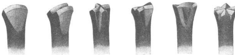
Abb. 181. Bohrerschneider für stoßendes Bohren.
