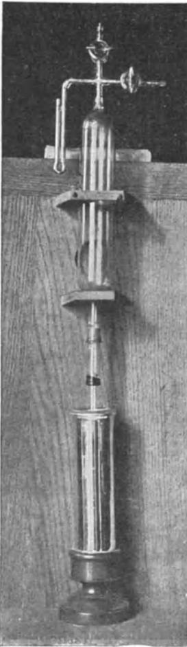
Fig. 5. Kondensator für die Emanation (nach Danne).
