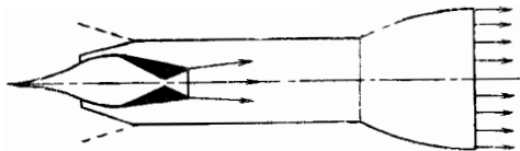
Рис. 7.17. Схема эжекторного насадка, работающего на сверхзвуковых скоростях полета
