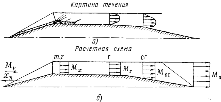
Рис. 6.49. Физическая картина течения (а) и расчетная схема течения (б) в камере ГПВРД
