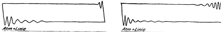
Fig. 51. Diagramme der Pumpe I. (Eichung mit Abfalleitung beim Betriebsversuch vom 17. Dezember 1903.)
