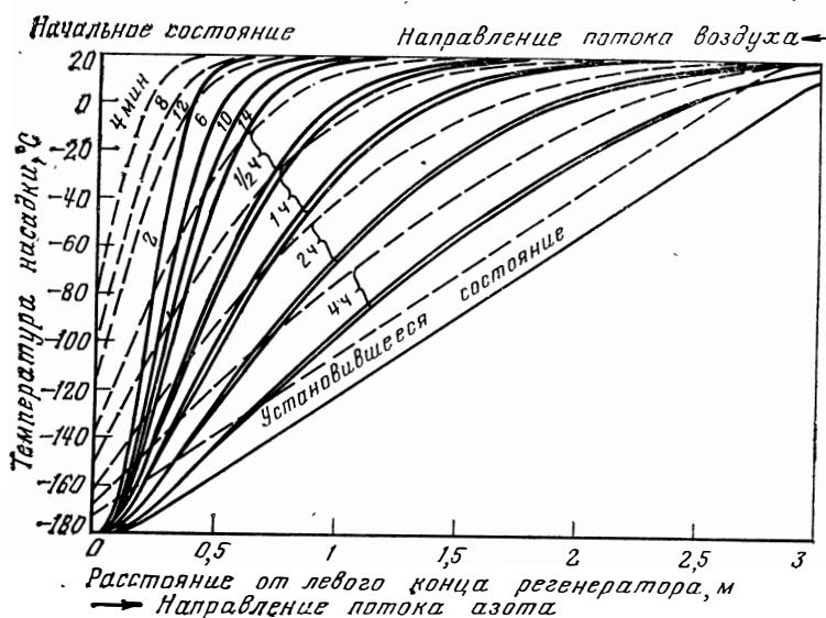
Рис. 197. Пуск криогенного регенератора при периодическом переключении через каждые 2 мин.
