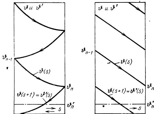
Рис. 103. Распределение температуры в перекрестно-противоточном теплообменнике при  $C=C'$  и  $\epsilon=1$ .
