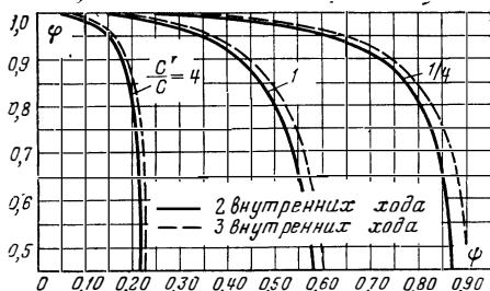
Рис. 113. Сравнение рекуператоров с двумя и тремя внутренними ходами.
