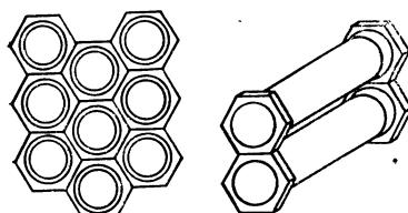
Рис. 84. Автомобильный радиатор с движением по трубкам воздуха (сотовый холодильник).
