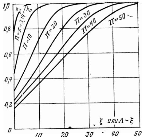
Рис. 182. Коэффициент теплопередачи  $k_\xi$  в произвольном сечении регенератора  $\xi$  или  $\Lambda - \xi$  при различной приведенной продолжительности периода  $\Pi$ .  $k_\xi$  — коэффициент теплопередачи, соответствующий нулевой собственной функции.
