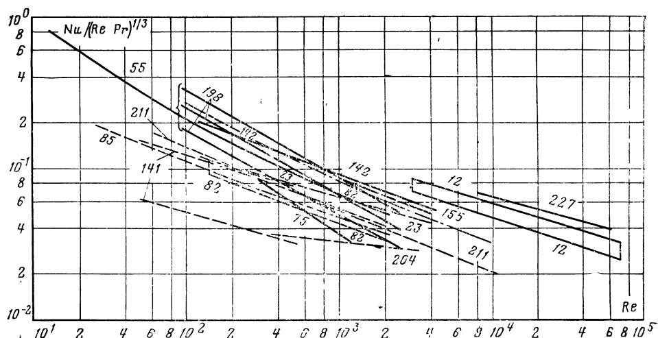
Рис. 27. Теплоотдача в насадках регенераторов.
