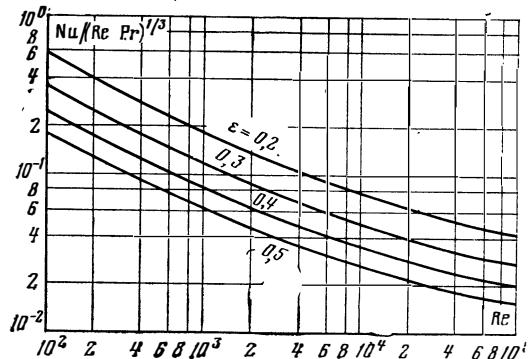
Рис. 30. Теплоотдача в шаровых засыпках по уравнению Ешара при  $Pr=0,73$ ;  $\varepsilon$  — относительный объем пустот.
