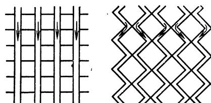
Рис. 85. Автомобильный радиатор с движением по трубкам воды.
