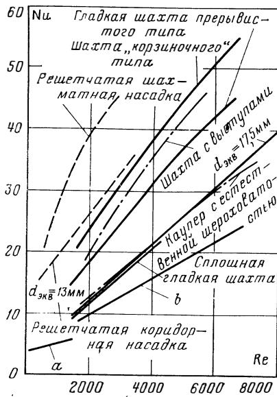
Рис. 24. Теплоотдача в различных насадках регенераторов.
