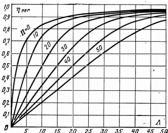
Рис. 167. Коэффициент полезного действия противоточных регенераторов при  $C=C'$  и  $T=T'$ .
