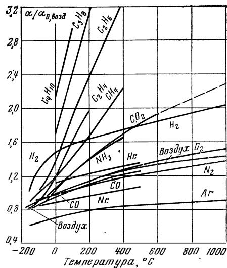
Рис. 4. Коэффициенты теплоотдачи различных газов  $\alpha$ , отнесенные к коэффициенту теплоотдачи воздуха при 0°C  $\alpha_0, \text{возд}$ .
