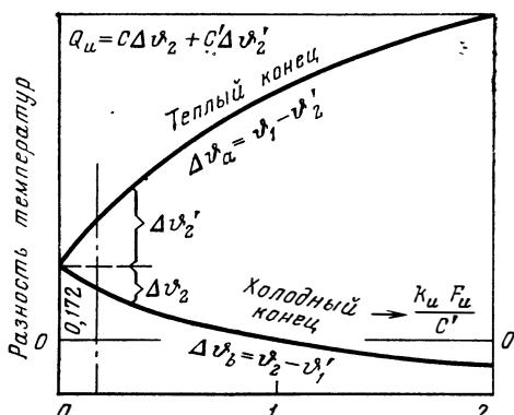
Рис. 79. Разности температур на концах противоточного теплообменника  $\Delta\theta_2$  и  $\Delta\theta'_2$  в зависимости от комплекса  $k_u F_u / C'$ , определяющего тепловые потери в окружающую среду.
