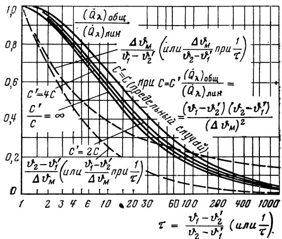
Рис. 82. Зависимость отношения  $(\dot{Q}_\lambda)_{\text{общ}} / (\dot{Q}_\lambda)_{\text{лин}}$  от  $\tau = \Delta\theta_a / \Delta\theta_b$  при  $\alpha = \alpha'$ .
