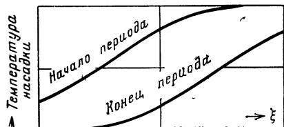
Рис. 161. Точечная симметрия распределения температуры в насадке в начале и в конце одного периода при  $\Lambda=\Lambda'$  и  $\Pi=\Pi'$ .
