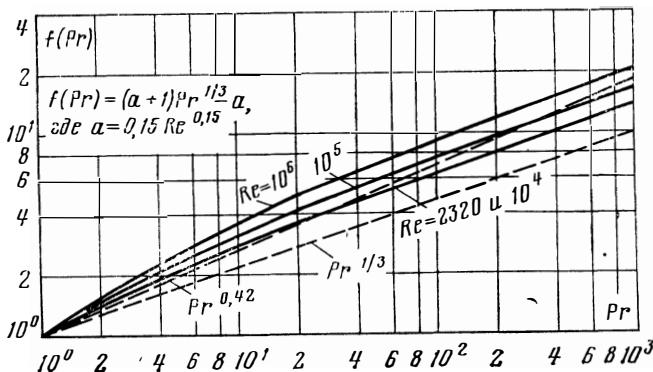
Рис. 8. Теплоотдача в трубах (зависимость числа  $Nu$  от  $Pr$  согласно уравнению Б. С. Петухова, а также в соответствии со степенными соотношениями  $Pr^{1/3}$  и  $Pr^{0,42}$ ).
