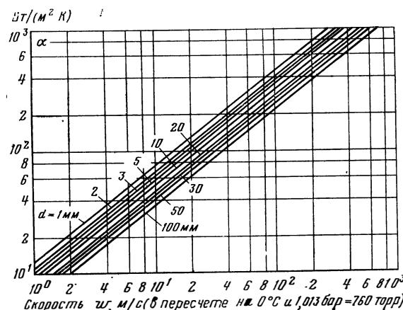
Рис. 3. Коэффициент теплоотдачи при турбулентном течении воздуха согласно уравнению Нуссельта.
