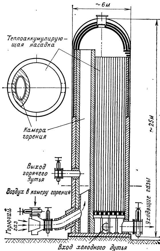
Рис. 124. Продольный и поперечный разрез воздухонагревателя доменной печи (каупера).
