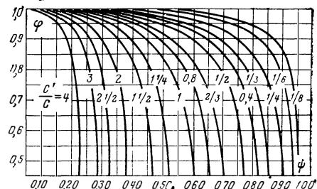
Рис. 114. Поправочный коэффициент для трехходовых рекуператоров.
