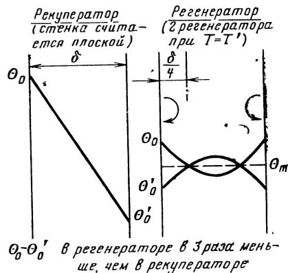
Рис. 147. Сравнение распределения температуры в кирпиче в рекуператоре и регенераторе.
