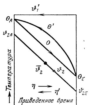
Рис. 188. Оценка изменения во времени температур на теплом конце регенератора, когда кроме температуры горячего газа на входе  $\theta'_1$  известна только средняя температура другого газа на выходе  $\bar{\theta}_2$ .
