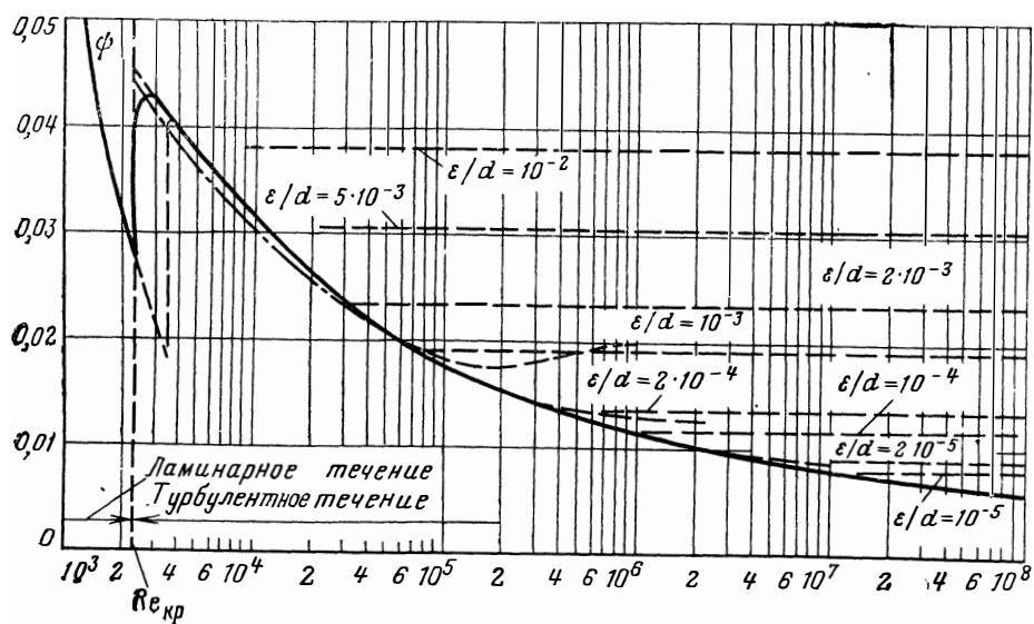
Рис. 47. Коэффициент гидравлического сопротивления  $\psi$  в гладких и шероховатых трубах.
