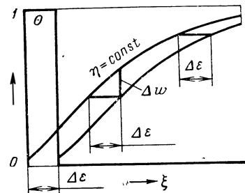
Рис. 181. Получение функции теплового полюса путем сдвига изображенной на рис. 155 кривой для момента времени  $\eta$  на расстояние  $\Delta\varepsilon$ .
