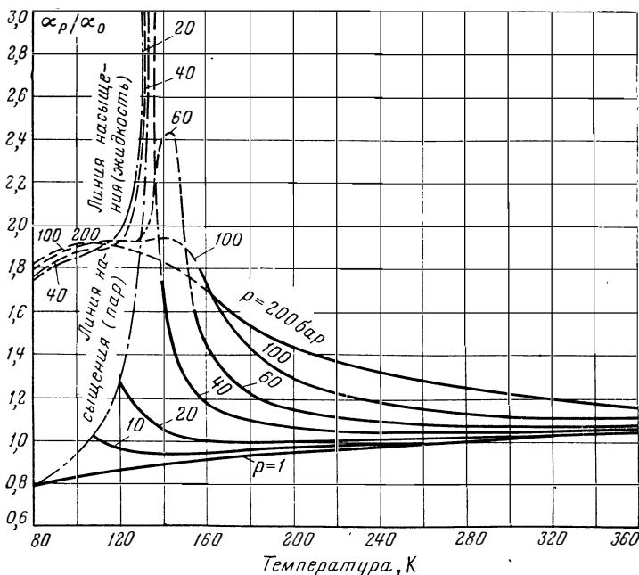
Рис. 6. Коэффициент теплоотдачи воздуха при различных давлениях.
