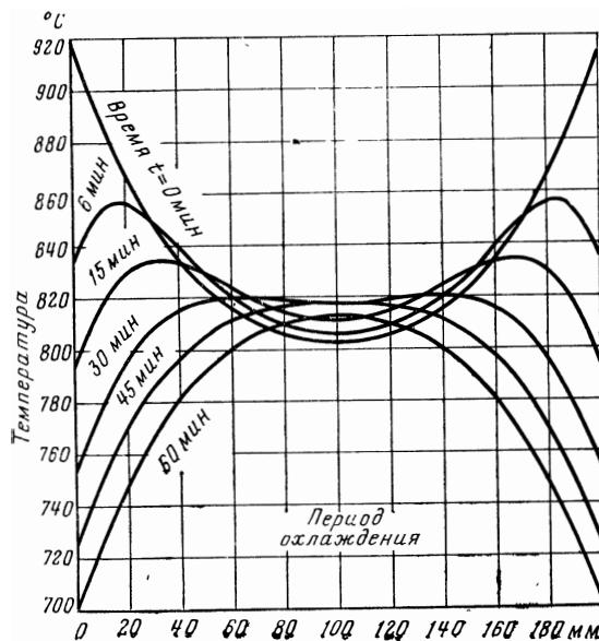
Рис. 143. Распределение температуры в кирпиче толщиной 200 мм.
