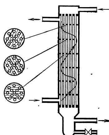
Рис. 89. Кожухотрубчатый перекрестно-противоточный теплообменник с направляющими перегородками.
