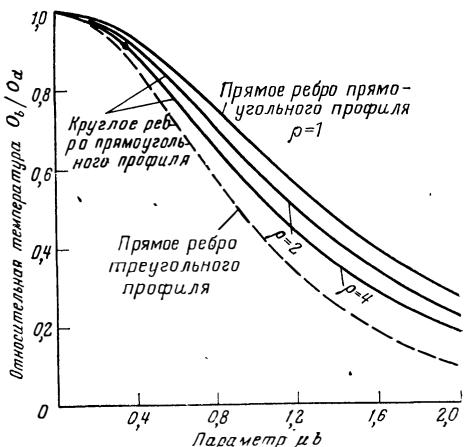
Рис. 108. Температура у вершины ребра  $\Theta_b$ .
