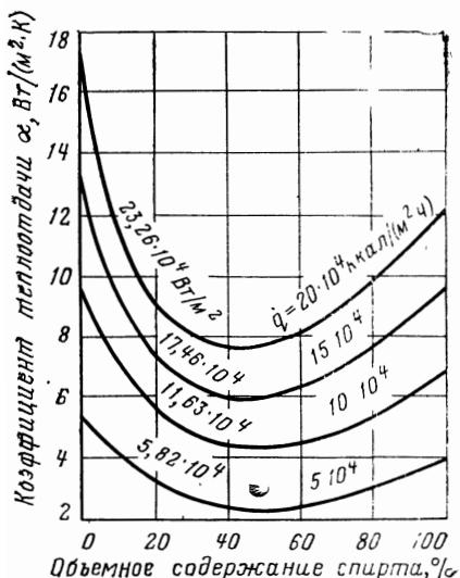
Рис. 35. Теплоотдача при кипении смесей этанол — вода.
