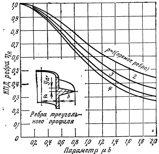
Рис. 110. Коэффициент полезного действия ребер треугольного профиля.
