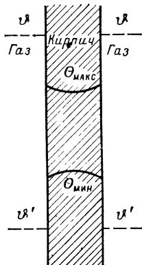
Рис. 127. Колебание температуры в поперечном сечении кирпича.
