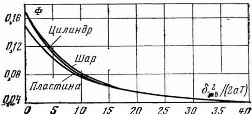
Рис. 150. Вспомогательная функция  $\Phi$  в зависимости от эквивалентной толщины пластины  $\delta_{\text{экв}}=R+V/F=\delta/2+V/F$ .
