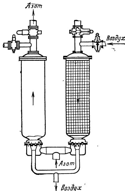
Рис. 123. Регенераторы.
