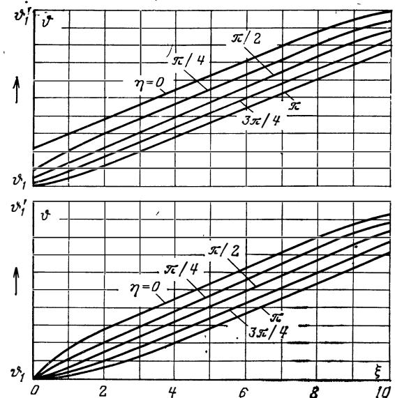
Рис. 166. Распределение температур насадки и газа вдоль регенератора при  $\Lambda=10$  и  $\Pi=\pi$ .
