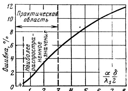
Рис. 152. Наибольшая ошибка при расчете количества теплоты, передаваемого при  $\theta = \text{const}$ , когда в качестве коэффициента теплоотдачи используется  $\alpha$ , рассчитываемый по уравнению (521).
