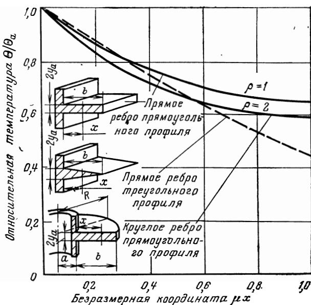
Рис. 107. Распределение температуры в ребрах при  $\mu b=1$ , где  $\mu = \sqrt{\alpha_R / (\lambda_s y_a)}$ .
