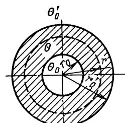
Рис. 57. Падение температуры в стенке трубы.
