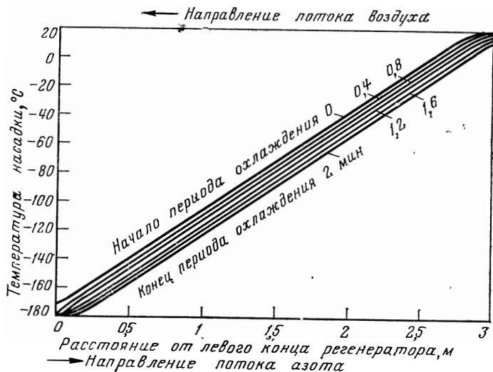
Рис. 199. Установившееся состояние криогенного регенератора без отклонений влаги и двуокиси углерода (сравнить с рис. 210—215).
