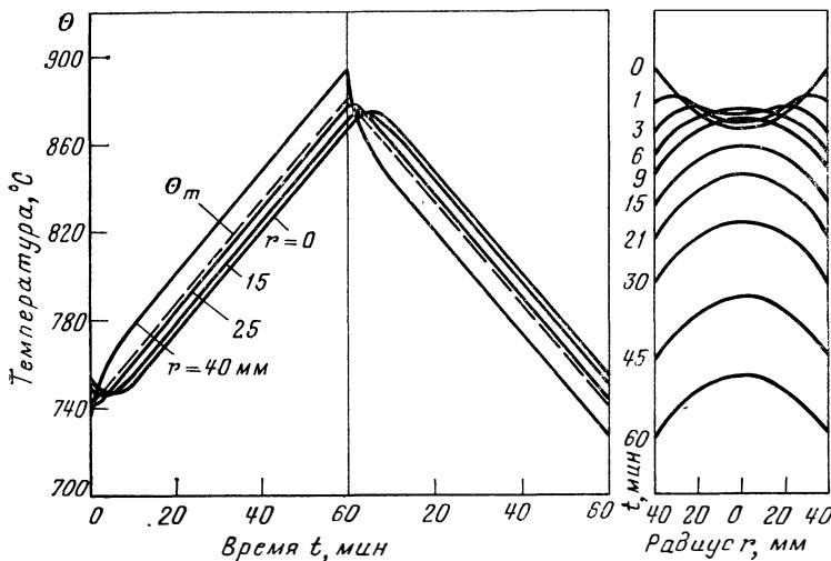
Рис. 148. Распределение температуры в цилиндрическом элементе насадки (диаметр цилиндра 80 мм).
