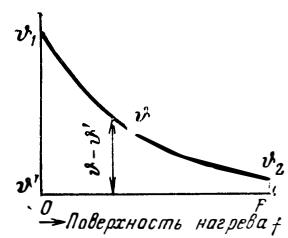
Рис. 59. Распределение температуры в воздухоохладителе, показанном на рис. 58.
