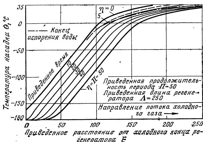
Рис. 213. Работа регенератора на влажном воздухе с температурой насыщения 35°C (период охлаждения, установившееся состояние).
