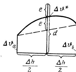
Рис. 73. К определению средней разности температур  $\Delta\vartheta_m$  при параболическом распределении  $\vartheta - \vartheta'$ .
