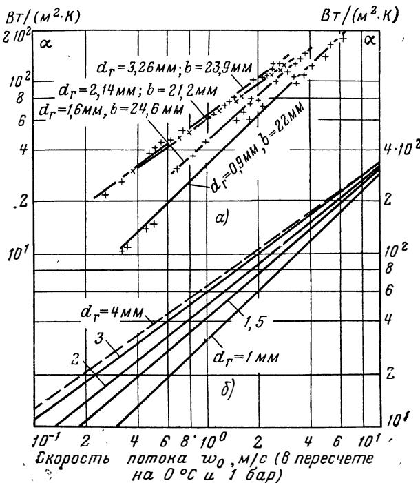
Рис. 29. Теплоотдача в насадке из гофрированной ленты (см. рис. 22) по опытным данным Глязера.
