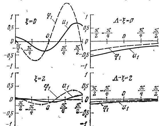
Рис. 162. Собственные функции  $u_1$  и  $\phi_1$  для  $\Pi=\pi$ .
