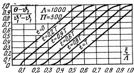
Рис. 205. Распределение температуры насадки при  $\Lambda=1000$  и  $\Pi=500$ .
