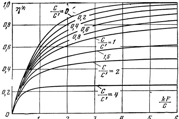
Рис. 93. Функция КПД  $\eta^*$  при чисто перекрестном токе.
