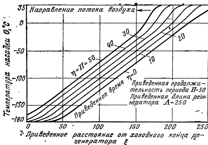
Рис. 211. Перевод регенератора с сухого на влажный воздух (первый «влажный» период нагрева; давление в период нагрева 5 бар, в период охлаждения 1,1 бар).
