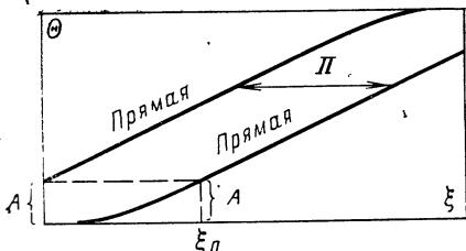
Рис. 193. Регенератор с очень большой продолжительностью периода  $\Pi$ .
