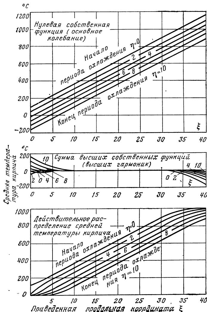
Рис. 132. Построение распределения температур вдоль регенератора по основному колебанию и высшим гармоникам.
