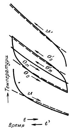
Рис. 160. Изменение температур насадки и газа во времени при  $CT = 2C'T'$  в соответствии с точным расчетом (сплошные линии) и по упрощенному методу нулевой собственной функции (штриховые линии).
