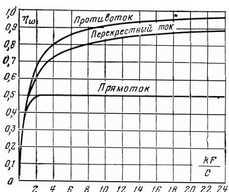
Рис. 95. Коеффициент полезного действия теплообменника  $\eta_w$  при противотоке, прямотоке и перекрестном токе при  $C=C'$ .
