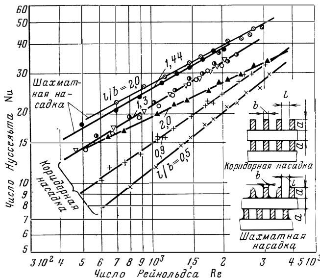
Рис. 25. Теплоотдача в насадках решетчатого типа по опытным данным Лянгханса.
