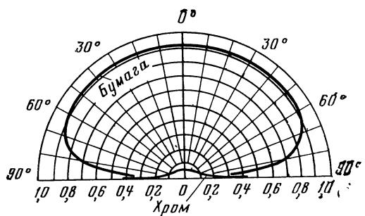
Рис. 39. Угловое распределение теплового излучения непроводника (бумаги) и металла (хрома).
