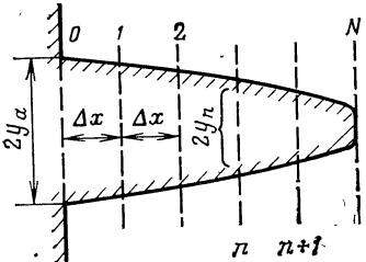
Рис. 106. Деление ребра на  $N$  участков одинаковой ширины  $\Delta x$ .
