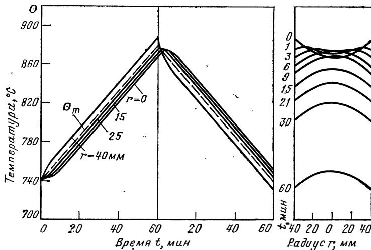
Рис. 149. Распределение температуры в шаровом элементе насадки (диаметр шара 80 мм).
