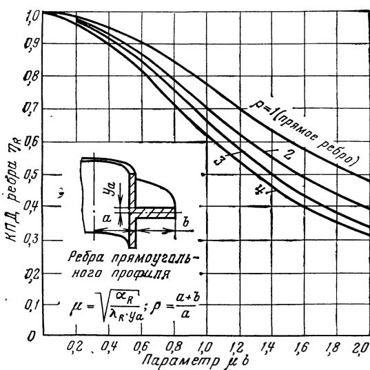
Рис. 109. Коэффициент полезного действия ребер прямоугольного профиля.
