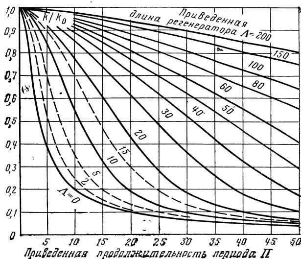
Рис. 135. Отношение действительного коэффициента теплопередачи  $k$  к коэффициенту теплопередачи  $k_0$ , обусловленному основным колебанием.
