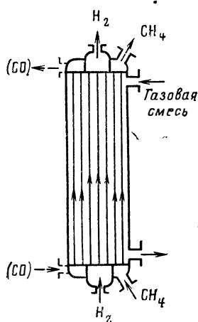
Рис. 120. Рекуператор для одновременной теплопередачи от газовой смеси к водороду и метану.
