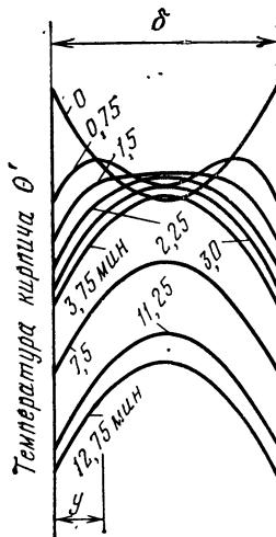
Рис. 128: Распределение температуры по толщине кирпича в различные моменты времени при изменяющейся во времени температуре газа  $\theta'$ .
