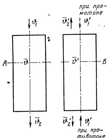
Рис. 126. Температуры газов в регенераторах.
