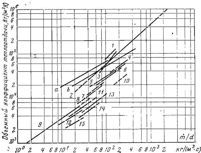
Рис. 26. Теплоотдача в различных засыпках согласно данным, собранным Вайсхауптом.
