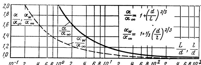
Рис. 7. Зависимость коэффициента теплоотдачи при турбулентном течении газа от длины трубы.
