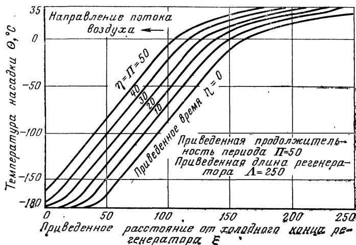
Рис. 212. Работа регенератора на влажном воздухе с температурой насыщения 35°C (период нагрева, установившееся состояние).
