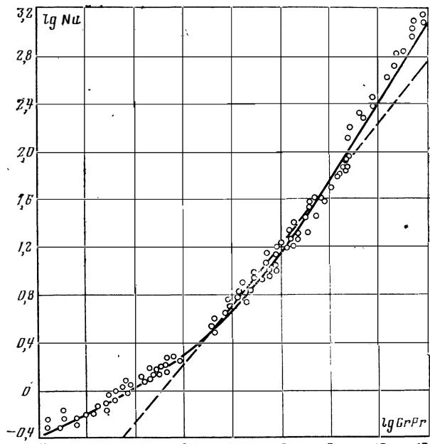
Рис. 12. Теплоотдача при свободной конвекции.
