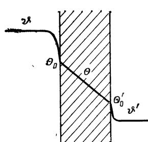
Рис. 1. Теплопередача через плоскую стенку.
