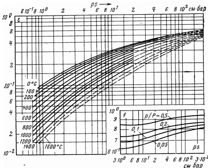
Рис. 43. Зависимость степени черноты водяного пара от произведения  $ps$ , температуры и парциального давления, по данным Э. Шмидта, Хоттеля и Эккерта.
