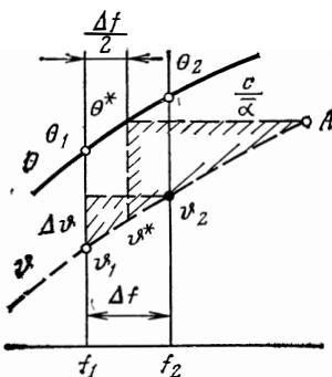
Рис. 186. Графическое определение температуры газа  $\vartheta$  при известном распределении температуры насадки  $\Theta$ .
