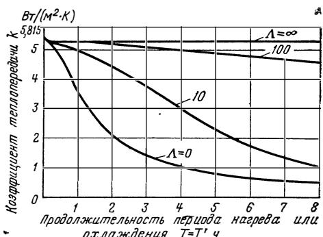
Рис. 136. Зависимость коэффициента теплопередачи  $k$  от продолжительности периода  $T = T'$  для различных значений приведенной длины регенератора  $\Lambda$ . Толщина кирпича  $\delta = 30 \text{ мм}$ .
