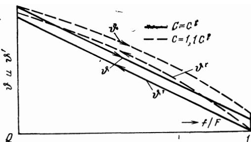
Рис. 65. Распределение температур в рекуператоре при противотоке.
