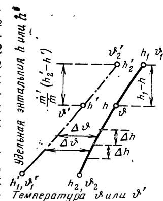
Рис. 72. Определение средней разности температур при противотоке в общем случае путем приближенного вычисления интеграла
