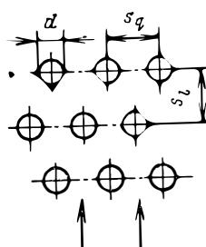
Рис. 15. Поперечное обтекание труб в шахматном пучке.
