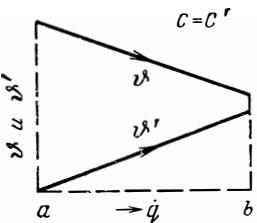
Рис. 61. Зависимость температур  $\vartheta$  и  $\vartheta'$  в поперечном сечении  $x$  от передаваемого теплового потока  $\dot{q}$  при прямотоке и  $C=C'$ .
