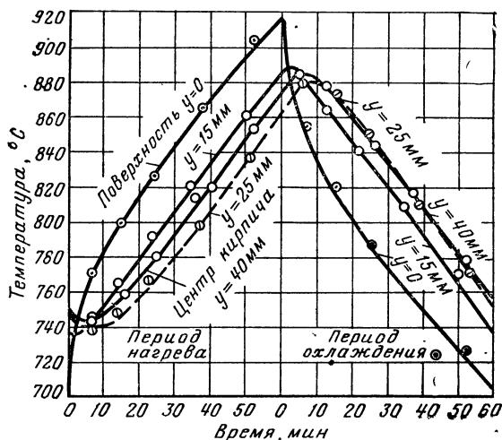
Рис. 142. Распределение во времени температуры в кирпиче насадки регенератора по опытным данным Шумахера.
