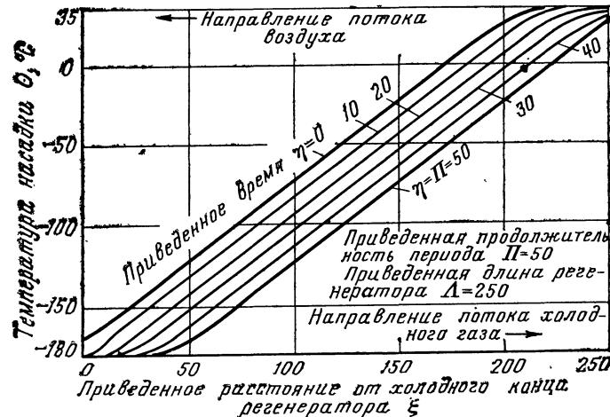
Рис. 210. Распределение температуры насадки в регенераторе, работающем на сухих газах (период охлаждения, установившееся состояние).
