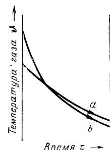
Рис. 154. Изменение во времени температуры газа в период охлаждения (схематический график). a — расчет по  $a$ ; b — расчет по  $\alpha$
