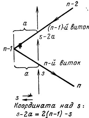
Рис. 102. Два расположенных один над другим витка с противоположным направлением движения потока в них (плоский змеевик).
