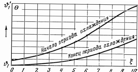
Рис. 196. Установившееся состояние регенератора при  $\Lambda=\Lambda'=10$ ,  $\Pi=5$  и  $\Pi'=-\pi$ .
