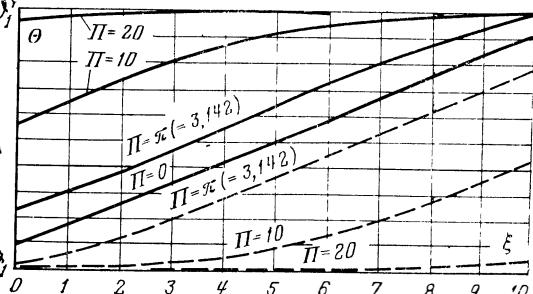
Рис. 194. Распределение температуры насадки противоточного регенератора в установившемся состоянии при  $\Lambda=\Lambda'=10$  и  $\Pi=\Pi'$ .
