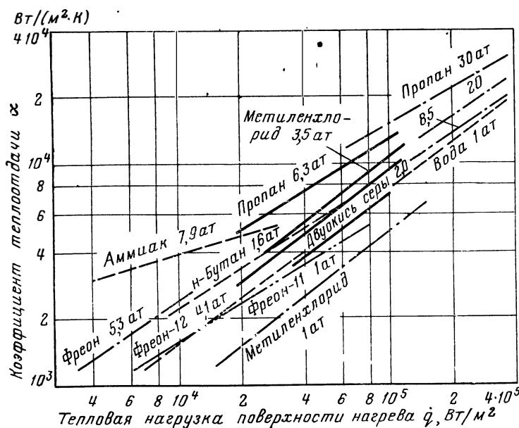
Рис. 33. Теплоотдача при пузырьковом кипении различных жидкостей, главным образом хладоагентов.
