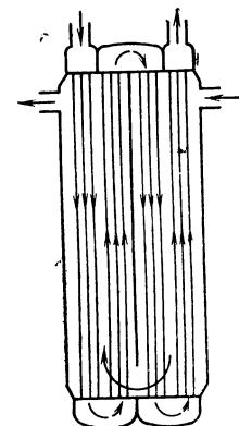
Рис. 115. Рекуператор с четырьмя внутренними и двумя внешними ходами.
