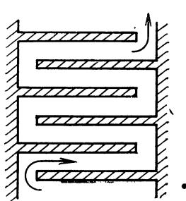
Рис. 51. Кирпичный рекуператор с зигзагообразным каналом для газового потока.
