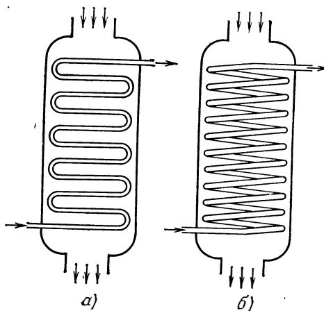
Рис. 97. Общий противоток с перекрестным током как вспомогательным процессом.
