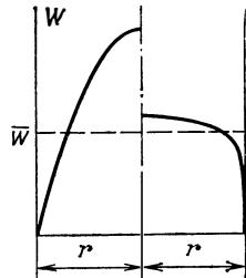
Рис. 46. Распреде-ление скоростей по-поперечному сече-нию трубы.
