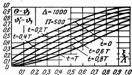
Рис. 203. Распределение температуры насадки при  $\Lambda=10$  и  $\Pi=5$ .
