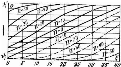
Рис. 195. Распределение температуры насадки регенератора в установившемся состоянии при  $\Lambda=\Lambda'=40$  и  $\Pi=\Pi'$ .
