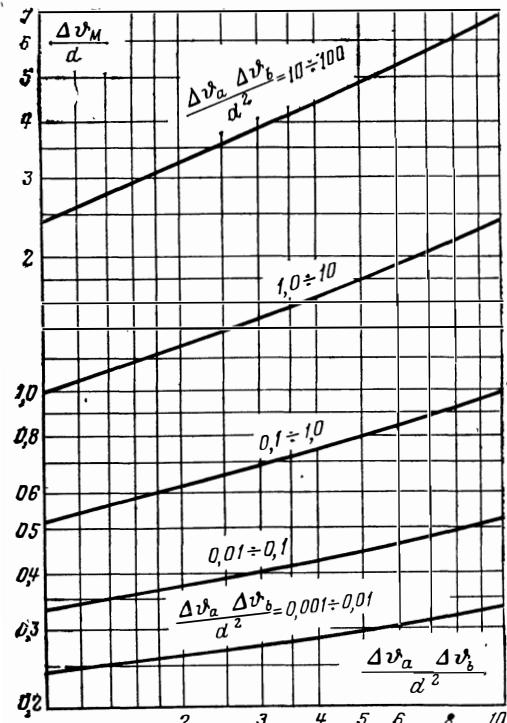
Рис. 74. Диаграмма для определения средней разности температур  $\Delta\vartheta_M$  при параболическом распределении  $\Delta\vartheta = \theta - \theta'$ .
