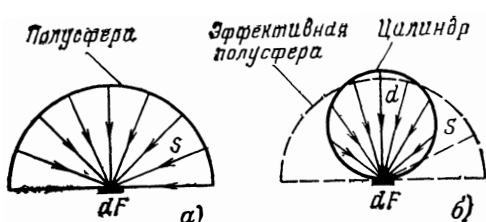
Рис. 44. Излучение газового объема на элемент поверхности  $dF$ .
