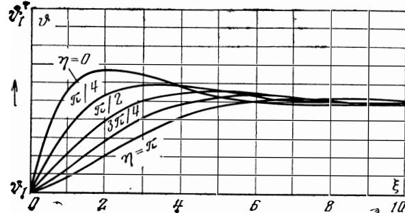
Рис. 170. Распределение температуры газа в течение периода охлаждения при прямотоке.
