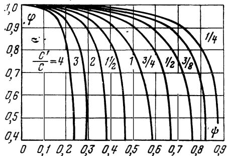
Рис. 112. Поправочный коэффициент для двух-, четырех-, шести- и многоходовых рекуператоров.
