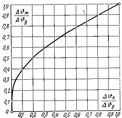
Рис. 68. Кривая для определения  $\Delta\vartheta_m$  по отношению разностей температур  $\Delta\vartheta_k$  и  $\Delta\vartheta_g$ .
