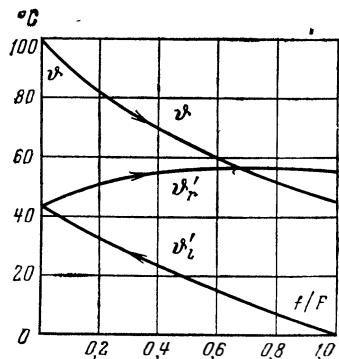
Рис. 118. Рекуператор с двумя внутренними ходами  $\Psi=0,55$ ;  $\varphi=0,661$  (первый ход противоточный, второй — прямоточный).
