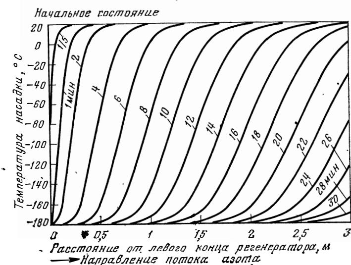
Рис. 198. Охлаждение насадки регенератора без переключения.
