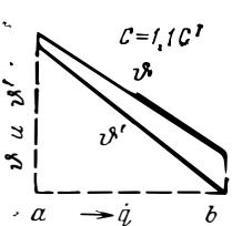
Рис. 64. Зависимость  $\vartheta$  и  $\vartheta'$  от  $\dot{q}$  при противотоке и  $C=1,1C'$ .
