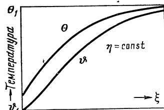
Рис. 155. Распределение температур в насадке к определенному моменту времени  $\eta$  при первом охлаждении (схематический график).
