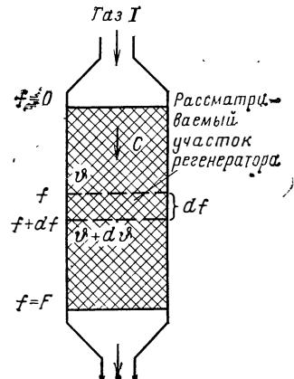
Рис. 138. Регенератор и участок регенератора с поверхностью нагрева  $df$ .
