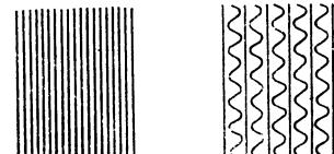
Рис. 20. Элементы кирпичной насадки.
