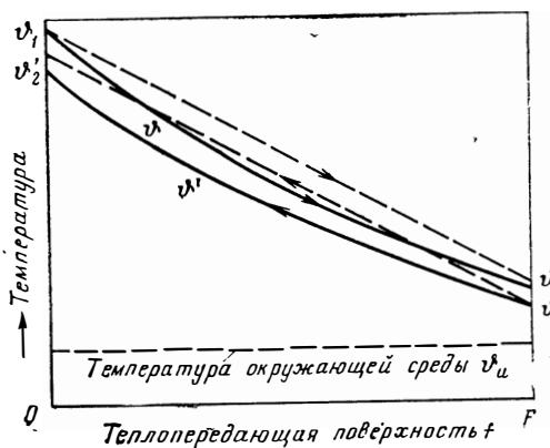
Рис. 76. Распределение температур в противоточном теплообменнике с тепловыми потерями в окружающую среду.
