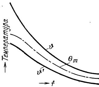
Рис. 81. Влияние продольной теплопроводности стенок на распределение температур в противоточном теплообменнике в случае, когда стени труб на концах теплоизолированы.
