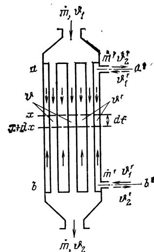
Рис. 60. Кожухотрубчатый теплообменник.
