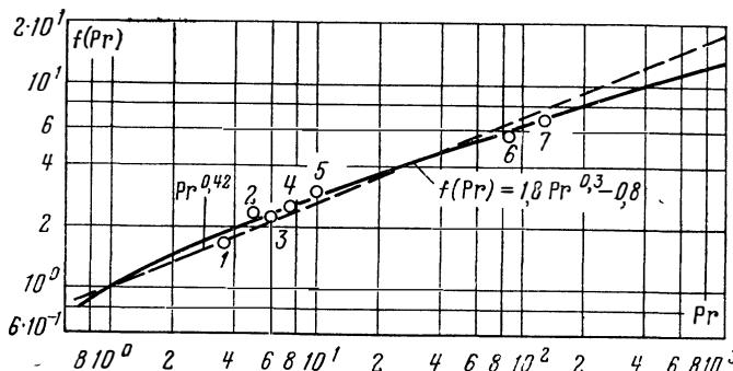
Рис. 9. Теплоотдача при турбулентном течении в трубах (зависимость от  $\text{Pr}$ ).
