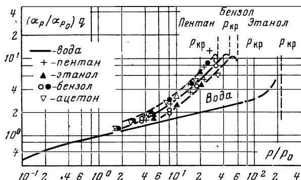
Рис. 36. Зависимость коэффициента теплоотдачи при кипении воды и органических жидкостей от давления.
