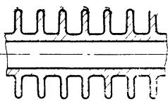
Рис. 17. Труба с плоскими ребрами.
