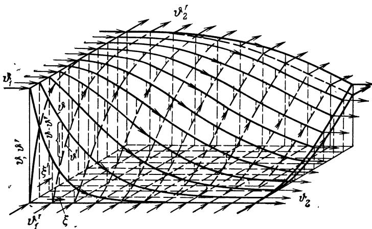
Рис. 92. Распределение температур при чисто перекрестном токе.
