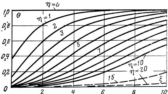
Рис. 157. Температура насадки при первом охлаждении.
