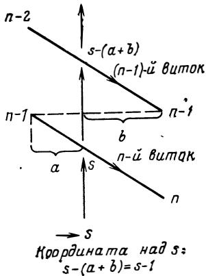
Рис. 101. Два расположенных один над другим витка с одинаковым направлением движения потока в них (витой змеевик).
