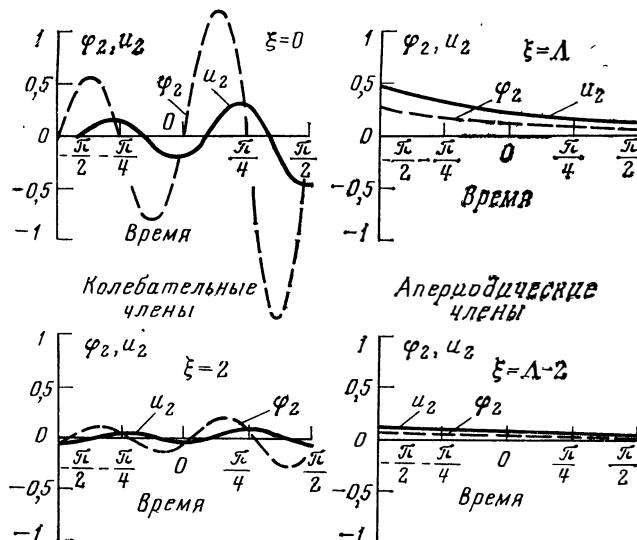
Рис. 131. Высшие гармоники колебаний температуры в регенераторе; собственные функции  $u_2$  и  $\varphi_2$  для  $k=2$ .
