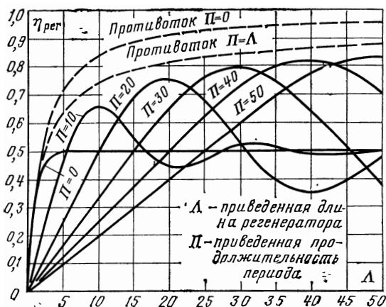
Рис. 171. Коэффициент полезного действия прямоточного регенератора.
