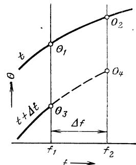
Рис. 187. К расчетному определению температур газа и насадки. Температуры газа не показаны.
