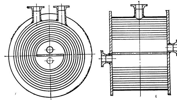
Рис. 56. Спиральный теплообменник (в ФРГ изготавливается фирмой «Альфа — Лаваль-Рока» в Дюрене).
