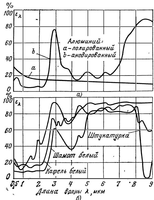
Рис. 38. Зависимость спектральной поглощающей способности  $\epsilon_\lambda$  различных твердых поверхностей от длины волн  $\lambda$ .
