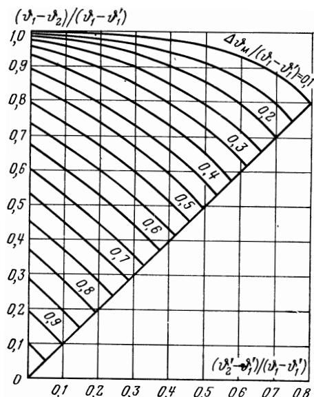
Рис. 94. Диаграмма Кюне для определения средней разности температур  $\Delta\vartheta_M$  при чисто перекрестном токе (построена согласно уточненному расчету Рётцеля).
