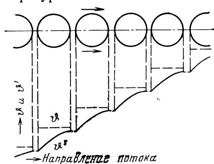
Рис. 98. Распределение температуры  $\vartheta'$  газа, движущегося в межтрубном пространстве перекрестно-противоточного теплообменника.
