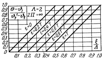
Рис. 206. Распределение температуры насадки при  $\Lambda=2$   $\Pi=\infty$ , т. е. при бесконечно большом коэффициенте теплоотдачи или бесконечно большой поверхности нагрева.
