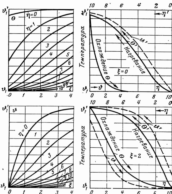
Рис. 202. Установившееся состояние очень короткого регенератора ( $\Lambda=\Lambda'=4$ ,  $\Pi=\Pi'=10$ ).
