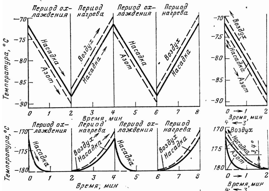
Рис. 200. Изменение температур насадки и газов во времени в установившемся состоянии в середине и на холодном конце регенератора.
