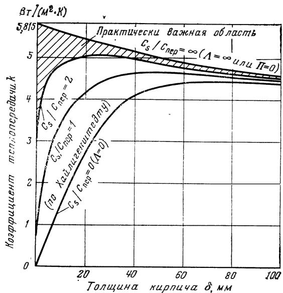
Рис. 137. Зависимость коэффициента теплопередачи  $k$  от толщины кирпича  $\delta$  для продолжительности периода  $T=T'=1$  ч.
