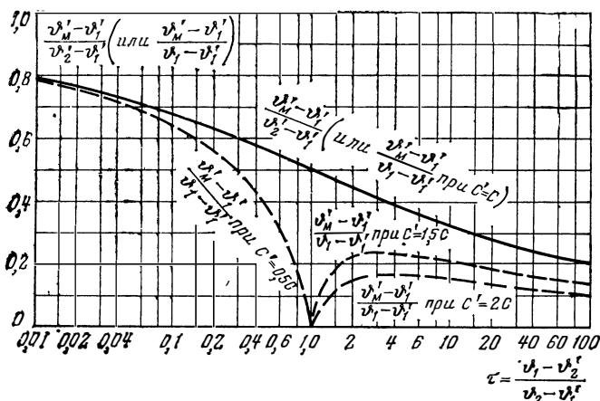
Рис. 77. Диаграмма для определения средней температуры  $\vartheta'_M$  газа, движущегося в межтрубном пространстве теплообменника.
