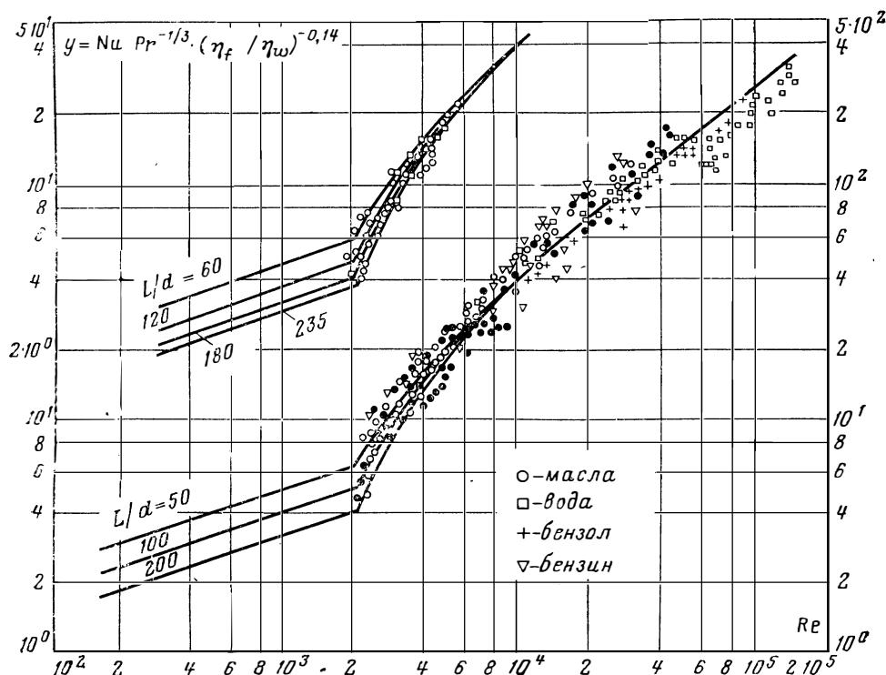
Рис 10. Зависимость коэффициента теплоотдачи от числа  $\text{Re}$  по Зидеру и Тэйту.
