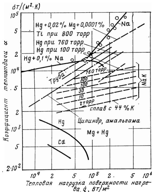
Рис. 34. Теплоотдача при пузырьковом кипении жидких металлов.
