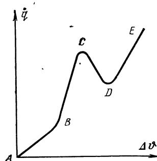
Рис. 32. Зависимость плотности теплового потока  $\dot{q}$  при кипении жидкостей от разности температур  $\Delta\vartheta$  поверхности стенки и кипящей жидкости.
