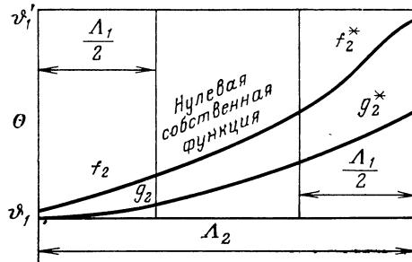
Рис. 192. Длинный регенератор при  $CT > C'T'$  (по сравнению с рис. 191 здесь в середине вставлен участок, соответствующий нулевой собственной функции).
