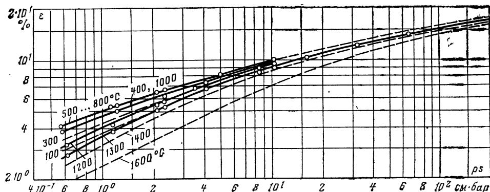
Рис. 42. Зависимость степени черноты двуокиси углерода от произведения  $ps$  и температуры газа (по данным Эккерта).
