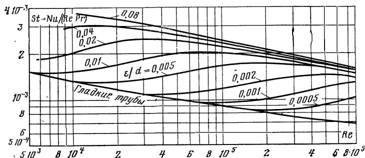
Рис. 13. Теплоотдача в шероховатых трубах.
