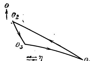
Рис. 208. Изменение температуры насадки во времени во «влажном» регенераторе.
