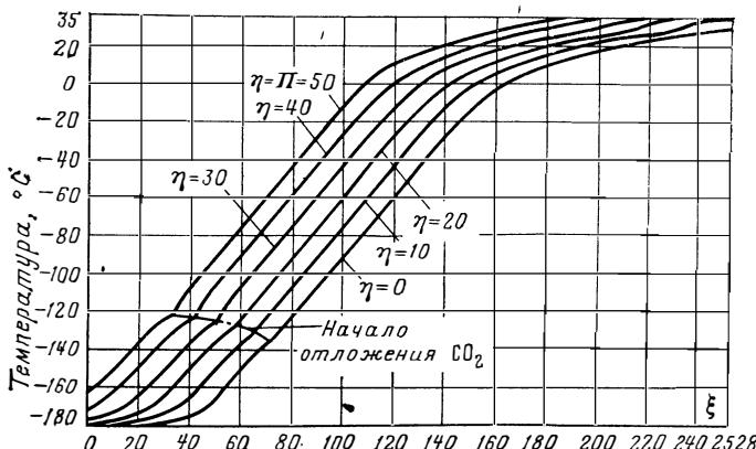
Рис. 215. «Влажный» регенератор с отложением двуокиси углерода; период нагрева.
