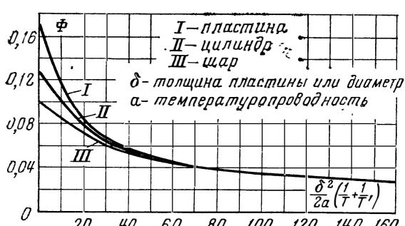
Рис. 134. Вспомогательная функция  $\Phi$  для расчета коэффициента теплопередачи.
