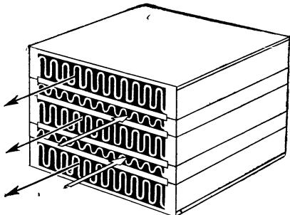
Рис. 55. Рекуператор, изготовленный из гладких и волнистых металлических листов (часто используется в криогенной технике в качестве реверсивного теплообменника).
