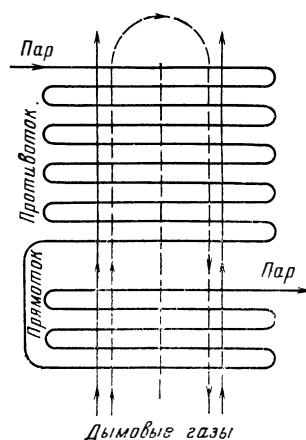
Рис. 88. Пароперегреватель с противоточным и прямоточным движением пара и дымовых газов с наложением перекрестного тока.
