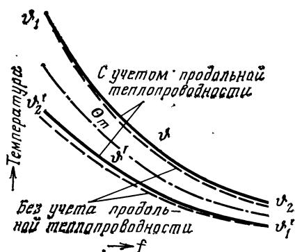
Рис. 80. Влияние продольной теплопроводности стенок на распределение температур в противоточном теплообменнике при  $C' > C$ .
