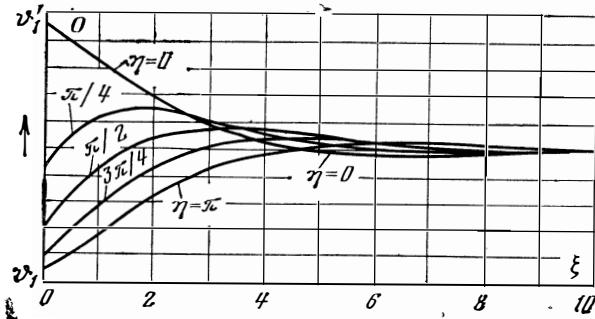
Рис. 169. Распределение температуры насадки  $\Theta$  в течение периода охлаждения при прямотоке и  $\Pi = \pi$ .
