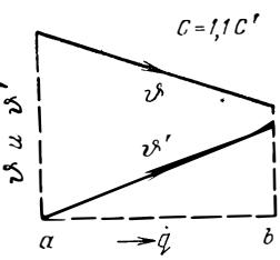
Рис. 63. Зависимость  $\vartheta$  и  $\vartheta'$  от  $\dot{q}$  при прямотоке и  $C=1,1C'$ .
