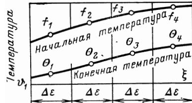
Рис. 177. Деление регенератора на участки одинаковой ширины  $\Delta\xi$  со средними температурами  $f_1, f_2, \dots$  и  $\theta_1, \theta_2, \dots$  и т. д.
