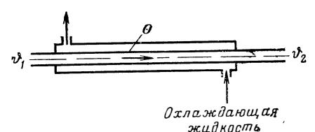
Рис. 2. Принципиальная схема измерения коэффициента теплоотдачи.
