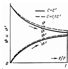
Рис. 66. Распределение температур в рекуператоре при прямотоке.
