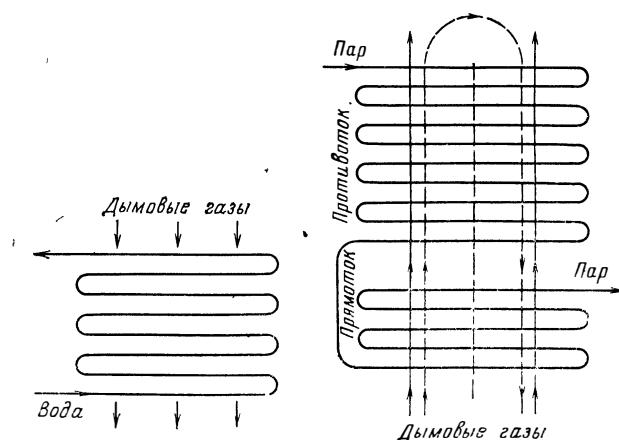
Рис. 87. Направление движения воды в подогревателе питательной воды.
