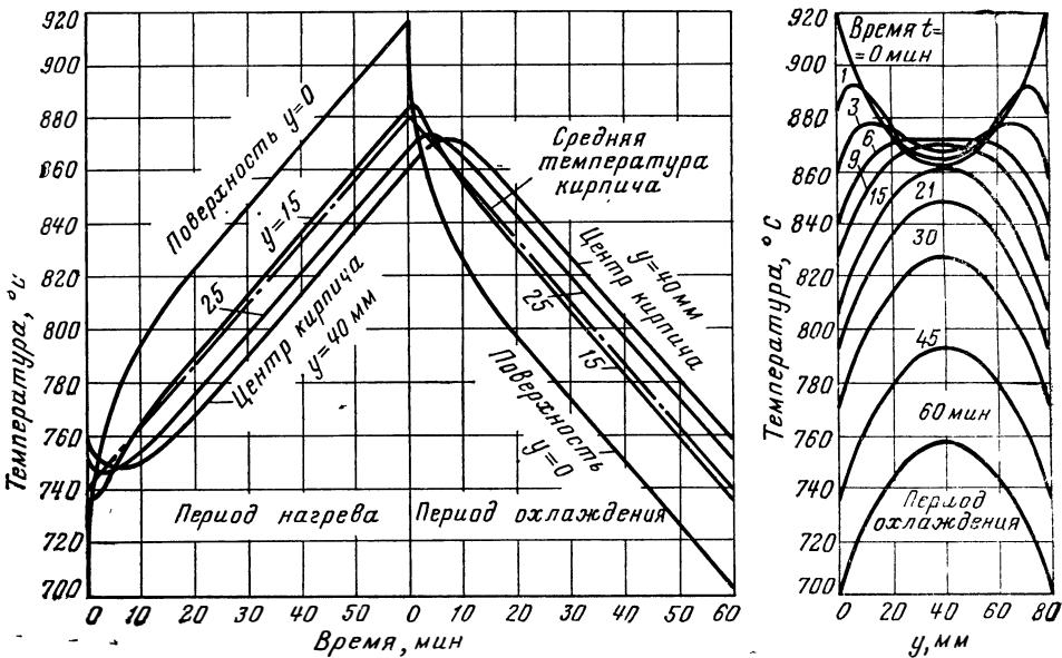
Рис. 141. Расчетное распределение температуры в кирпиче регенератора толщиной 80 мм.
