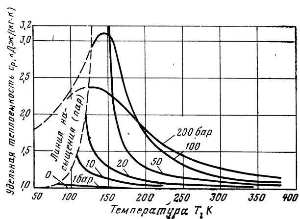
Рис. 5. Зависимость удельной теплопроводности воздуха  $c_p$  от температуры и давления.
