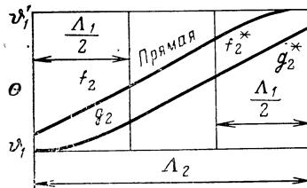
Рис. 190. Длинный регенератор при  $C=C'$  и  $T=T'$  (по сравнению с рис. 189 в середине вставлен прямолинейный участок).
