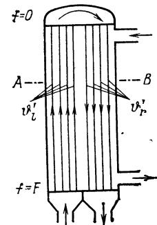
Рис. 117. Рекуператор с двумя внутренними ходами.
