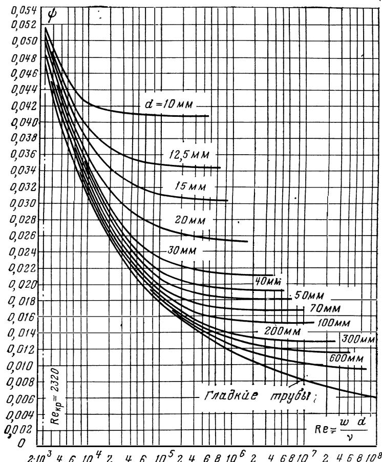
Рис. 49. Коэффициент гидравлического сопротивления цельнотянутых стальных труб.
