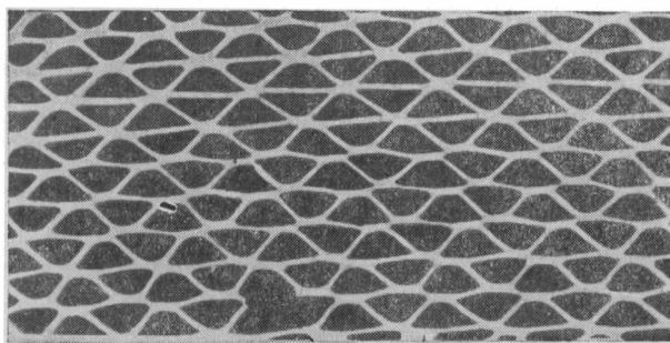
Рис. 23. Керамическая высокотемпературная насадка.
