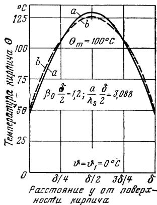
Рис. 153. Распределение температуры в насадке при экспоненциальном (a) и линейном (b) изменении  $\Theta_m$  во времени.
