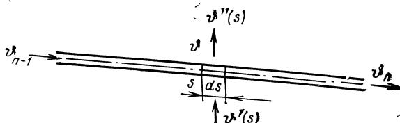
Рис. 100. Теплопередача в витке перекрестно-противоточного теплообменника.
