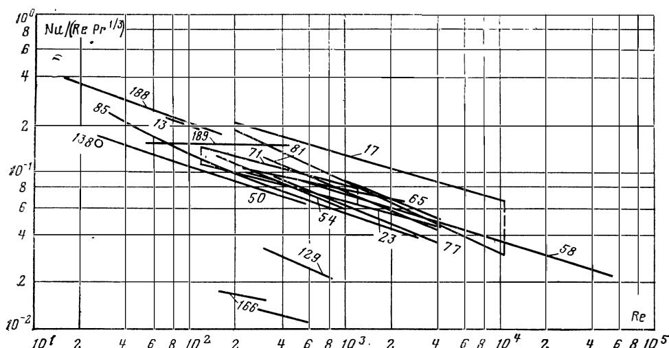
Рис. 28. Теплоотдача в неупорядоченных засыпках из шаров. Номера относятся к таблице и списку литературы из статьи Баркера [1.95]
