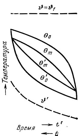
Рис. 130. Распределение температуры во времени на теплом конце регенератора.
