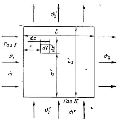
Рис. 91. Теплообмен при перекрестном токе на плоской пластине.
