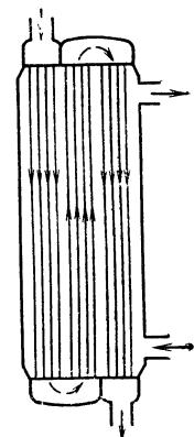
Рис. 111. Рекуператор с тремя последовательно включеными внутренними ходами.
