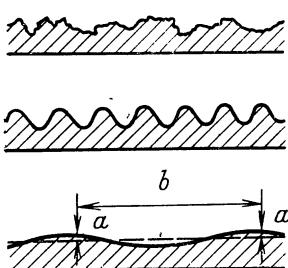
Рис. 48. Два типа шероховатости стенок каналов.
