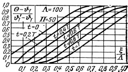
Рис. 204. Распределение температуры насадки при  $\Lambda=100$  и  $\Pi=50$ .
