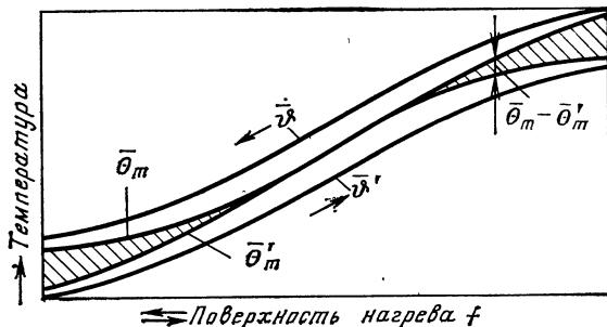
Рис. 133. Средние во времени значения температур в регенераторе.
