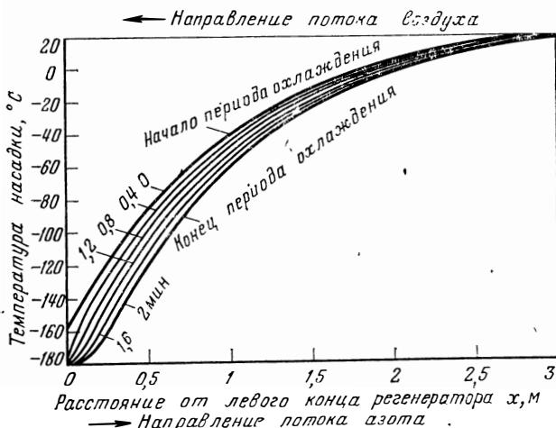
Рис. 201. Установившееся состояние регенератора при неодинаковой теплоемкости проходящих через него газов.
