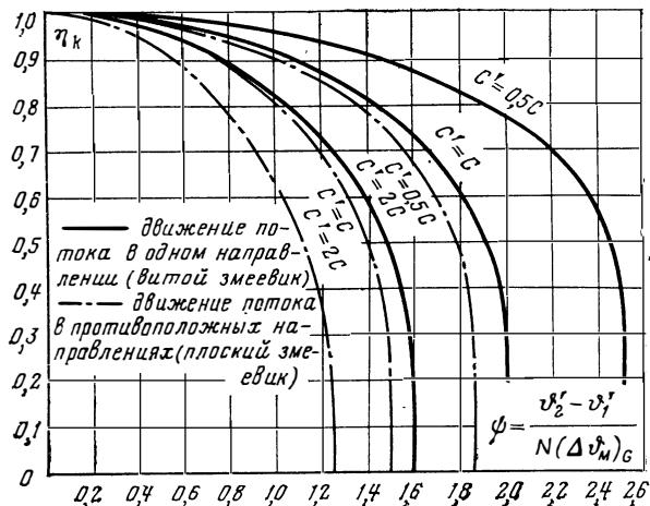
Рис. 104. Эффективность  $\eta_K$  перекрестно-противоточного теплообменника по сравнению с чисто противоточным при одинаково и противоположно направленном движении потока в соседних витках.
