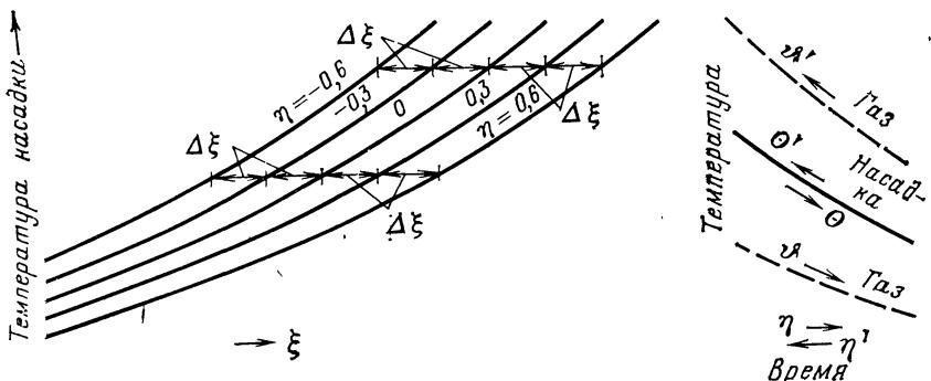
Рис. 159. Распределение температуры в насадке в соответствии с упрощенным методом нулевой собственной функции при  $CT > C'T'$ .
