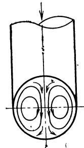
Рис. 50. Два сцепленных вихря в изогнутой трубе.
