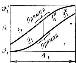
Рис. 189. Короткий регенератор при  $C=C'$  и  $T=T'$ .
