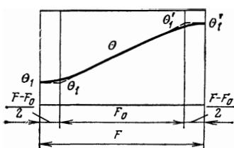
Рис. 184. Приближенное распределение температуры насадки в середине периода нагрева или охлаждения при  $CT=C'T'$ .
