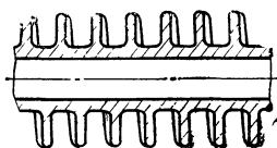
Рис. 18. Труба с винтообразно навитым ребром.
