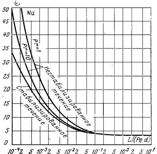
Рис. 11. Теплоотдача при ламинарном течении в трубах.
