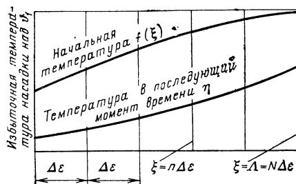
Рис. 175. Деление регенератора на  $N$  полос равной ширины.
