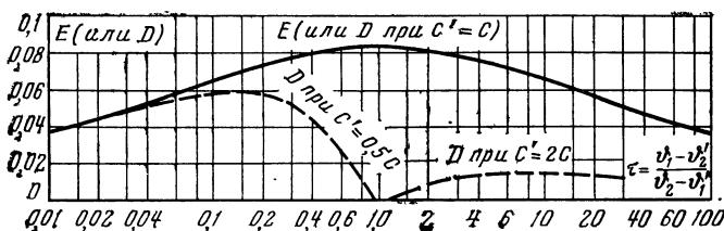
Рис. 78. Вспомогательные величины  $E$  или  $D$  для определения распределения температур в теплообменнике с учетом тепловых потерь в окружающую среду.
