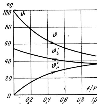
Рис. 119. Рекуператор с двумя внутренними ходами  $\Psi=0,55$ ;  $\varphi=0,661$  (первый ход — прямоточный, второй — противоточный).
