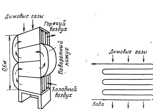
Рис. 86. Пластинчатый воздухоподогреватель, включенный по смешанной схеме. Отдельные элементы состоят из параллельных плоских пластин.
