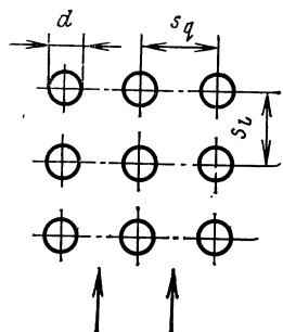
Рис. 14. Поперечное обтекание труб в коридорном пучке.
