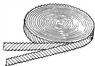
Рис. 22. Насадка низкотемпературных регенераторов из гофрированных металлических лент («галета») по Френклю.
