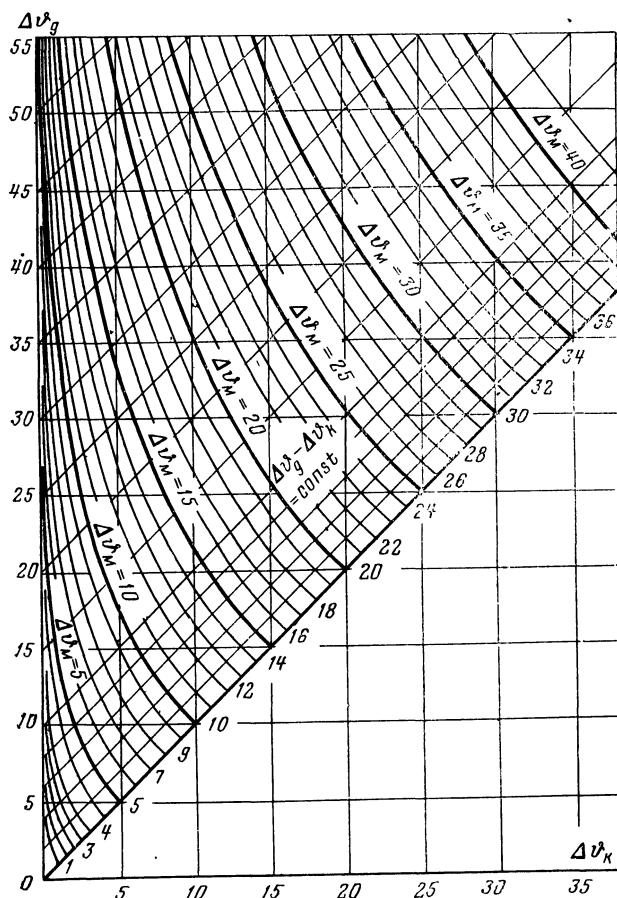
Рис. 67. Диаграмма для определения средней разности температур  $\Delta\vartheta_M$  при прямотоке и противотоке по значениям большей и меньшей разностей температур  $\Delta\vartheta_g$  и  $\Delta\vartheta_k$  на концах теплообменника.
