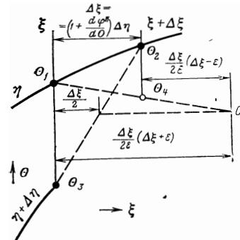
Рис. 209. Графический конечно-разностный метод для определения температуры насадки «влажного» регенератора.
