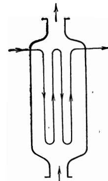
Рис. 96. Общий перекрестный ток с параллельным током как вспомогательным процессом.
