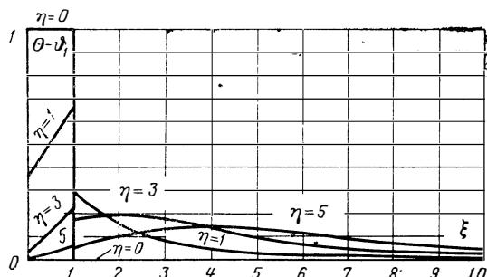
Рис. 180. Функция теплового полюса  $\Delta\omega$  для теплового полюса шириной  $\Delta\varepsilon = 1$ .
