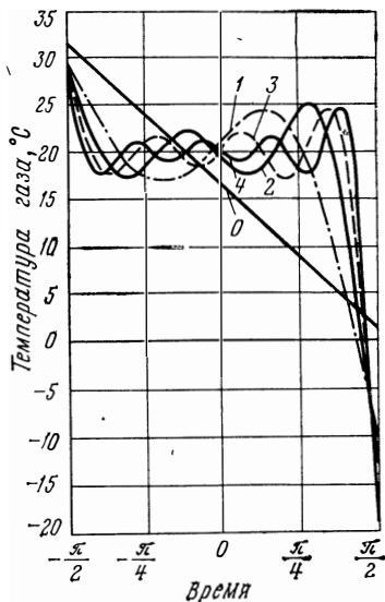
Рис. 164. Осциллирующее приближение к неизменной температуре на входе  $\theta_1=20^\circ\text{C}$  при  $\Lambda=10$  и  $\Pi=\pi$ .
