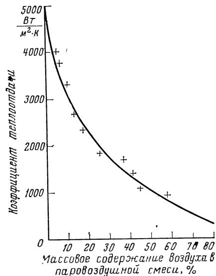
Рис. 31. Коэффициент теплоотдачи при охлаждении насыщенных смесей водяного пара с воздухом.
