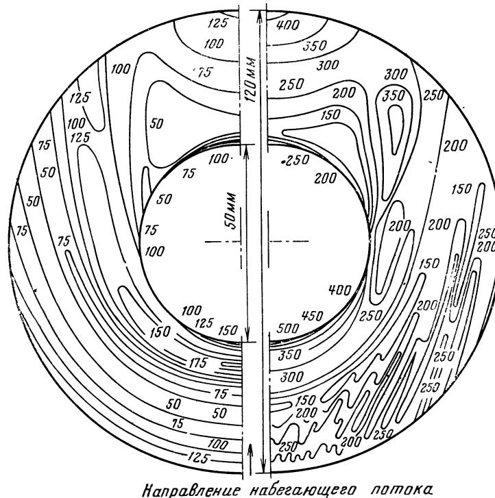
Рис. 19. Распределение коэффициента теплоотдачи  $\alpha$  по поверхности одиночного кольцевого ребра [скорость набегающего потока: слева 2 м/с, справа 10 м/с,  $\alpha$  — в ккал/(\mathbf{м}^2\cdot\text{ч}\cdot\text{К})], значения в  $\text{Bt}/(\text{м}^2\cdot\text{K})$  на 16,3% выше].
