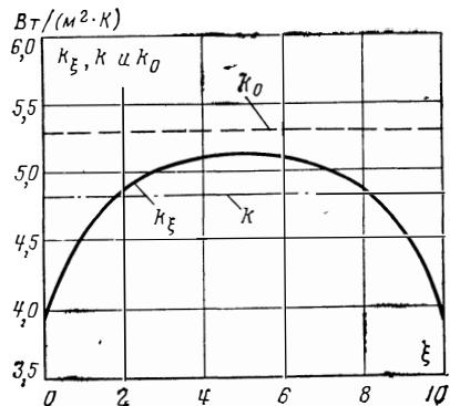
Рис. 183. Зависимость  $k_\xi$  от  $\xi$  при  $\Lambda = \Lambda' = 10$  и  $\Pi = \Pi' = \pi$ .  $k$  — средний коэффициент теплопередачи;  $k_0$  — то же, что и на рис. 182.
