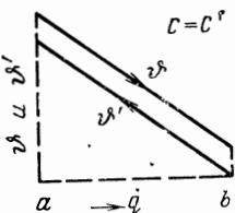
Рис. 62. Зависимость  $\vartheta$  и  $\vartheta'$  от  $\dot{q}$  при противотоке и  $C=C'$ .
