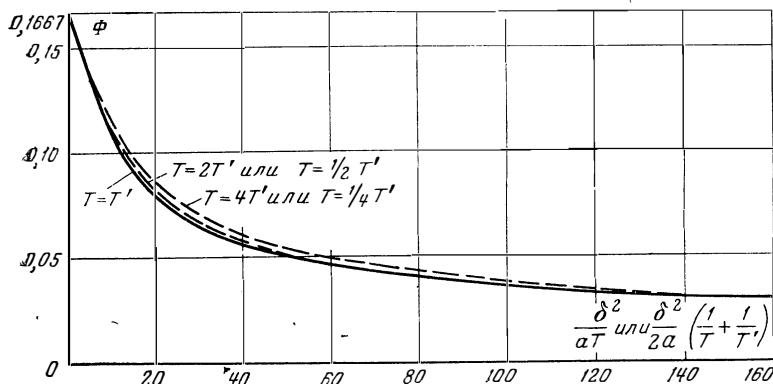
Рис. 146. Вспомогательная функция  $\Phi$  для расчета коэффициента теплопередачи.
