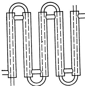
Рис. 52. Двухтрубный теплообменник (типа «труба в трубе»).
