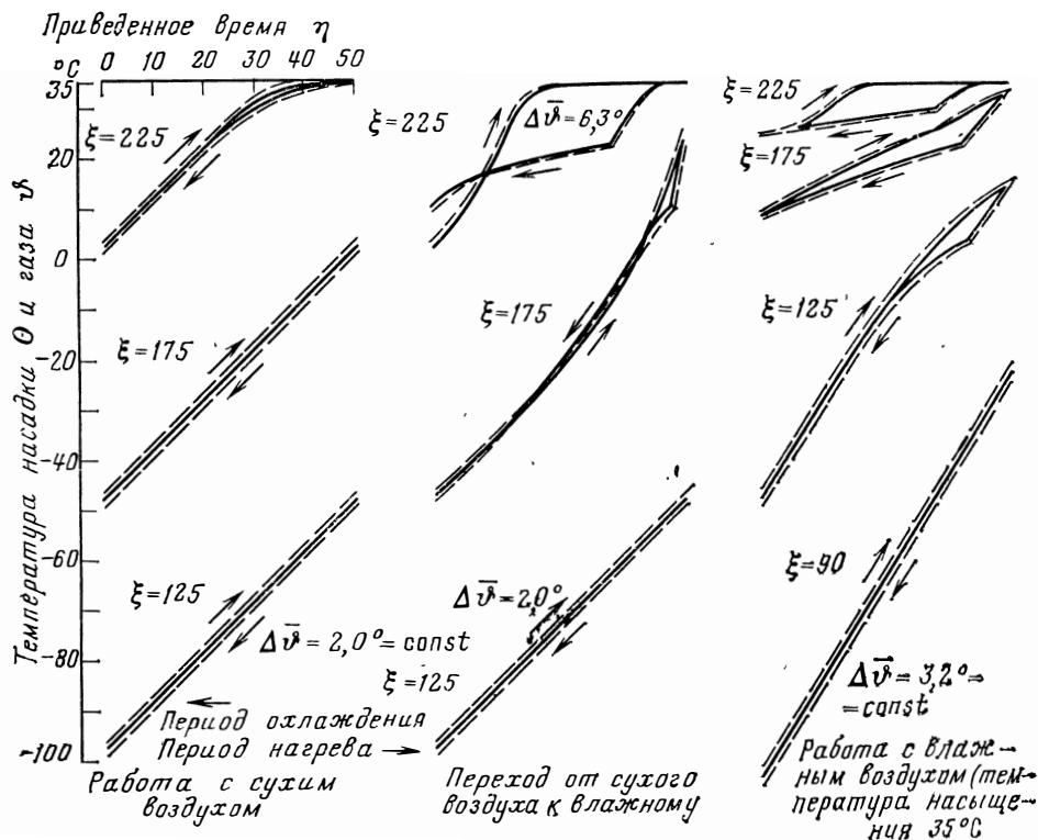
Рис. 214. Изменение температур насадки и газов во времени в различных сечениях регенератора при работе на сухом и влажном воздухе.
