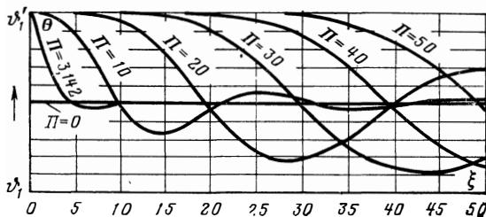
Рис. 168. Температура насадки в начале периода охлаждения при прямотоке в установившемся состоянии.
