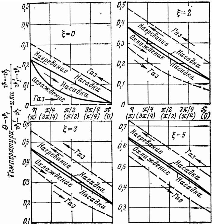
Рис. 165. Изменение температуры в регенераторе во времени при  $\Lambda=10$  и  $\Pi=\pi$ .
