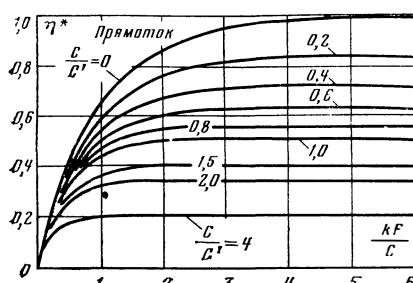
Рис. 70. Функция КПД  $\eta^*$  при прямотоке.
