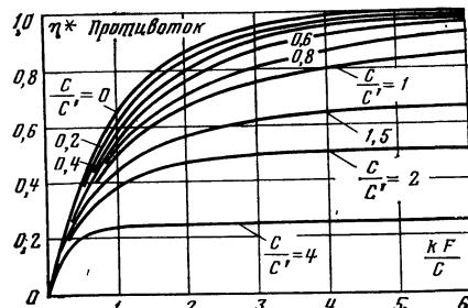
Рис. 71. Функция КПД  $\eta^*$  при противотоке.
