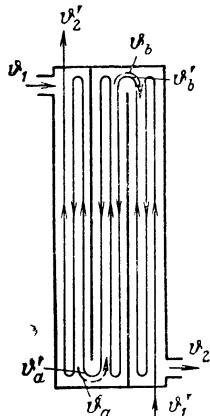
Рис. 116. Температуры в рекуператоре с несколькими внешними ходами.
