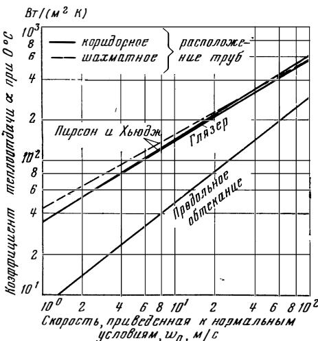
Рис. 16. Теплоотдача при поперечном и продольном обтекании труб.
