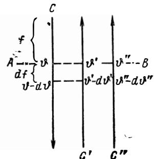
Рис. 121. Теплообмен между тремя потоками.
