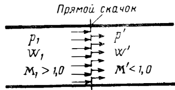
Рис. 4.7. Прямой скачок уплотнения в цилиндрической трубе
