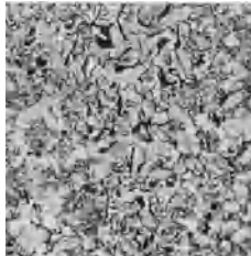
Abb. 68. Geätzt mit alc. \text{HNO}_3 \times 40 bei 1350^\circ \frac{1}{4} Stunde geschmolzen, teils scheineutektischer, teils eutektischer Graphit.
