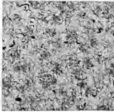
Abb. 57. Geätzt mit alc. HNO 3 , × 40 Scheineutektischer Graphit feinblättrig.
