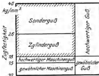
Abb. 8. Einteilung von Guß nach der Zugfestigkeit.
