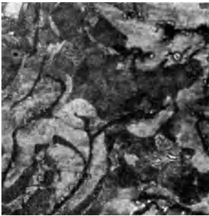
Abb. 91. Grauguß mit etwa 50% Ferrit. 100 × Vergr.
