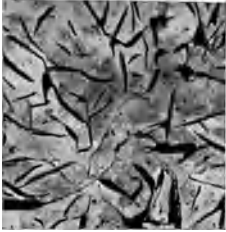
Abb. 56. Geätzt mit alc. HNO 3 , × 40 Scheineutektischer Graphit groblättrig.
