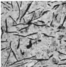
Abb. 67. Geätzt mit alc. \text{HNO}_3 \times 40 Grauguß mit scheineutektischem Graphit bei 1250^\circ geschmolzen.
