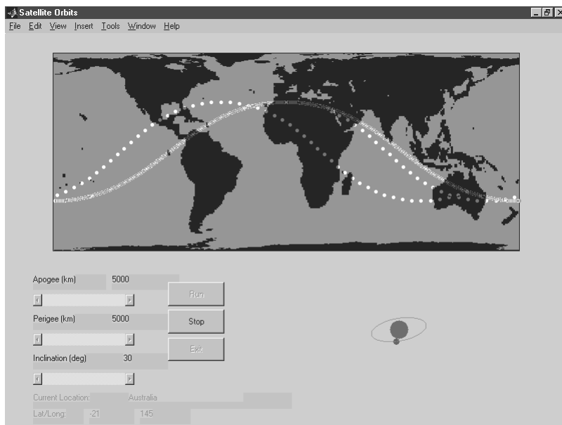
Рис. 13.33. Пример построения анимационных орбит спутника Земли на фоне ее карты (пакет Mapping)
