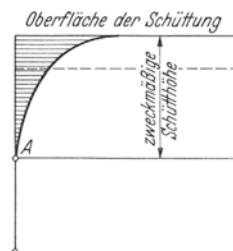
Abb. 20. Schematisches Spannungsdiagramm: Abscheren in der Schüttung bei Einsatz von Walzen.
