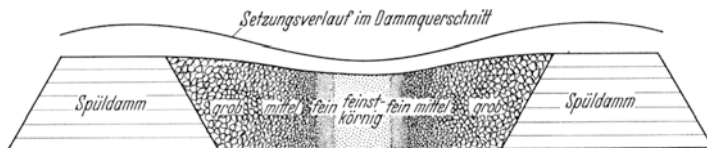
Abb. 116. Darstellung der Massenaufbereitung bei ungenügender Wasserzugabe und zu geringer Stromstärke beim Einspülen.
