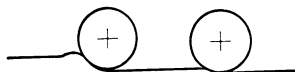
Abb. 84. Walze und zu weiche Massen, wulstförmige Stauung der Massen vor dem vorderen Walzkörper, die Verdichtung leidet oder wird unter Umständen unmöglich.
