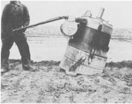
Abb. 107. Frosch mit Sprungbrett. Man sieht deutlich, daß die Massen ungleichmäßig und unvollständig verdichtet werden.
