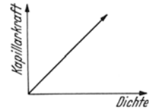
Abb. 14. Schematische Darstellung der Zunahme der Kapillardruckkraft in Abhängigkeit von der Zunahme der Dichte einer Kornanhäufung.
