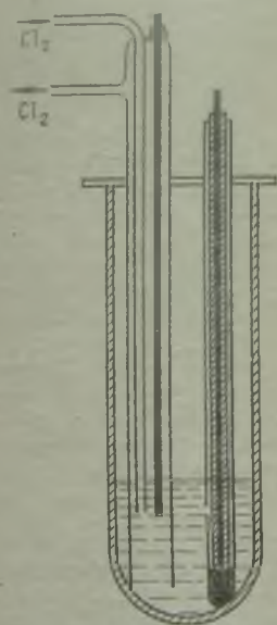
Рис. 96. Элемент для измерения э. д. с. в расплавленных хлоридах
