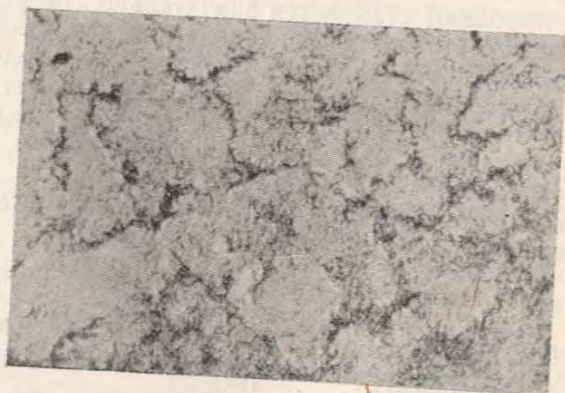
Рис. 185. Микроструктура той же стали, что и на рис. 184, после выдержки в течение месяца при 600° в водороде под давлением 150 атм. Сильное обезуглероживание границ зерен. \times 200
