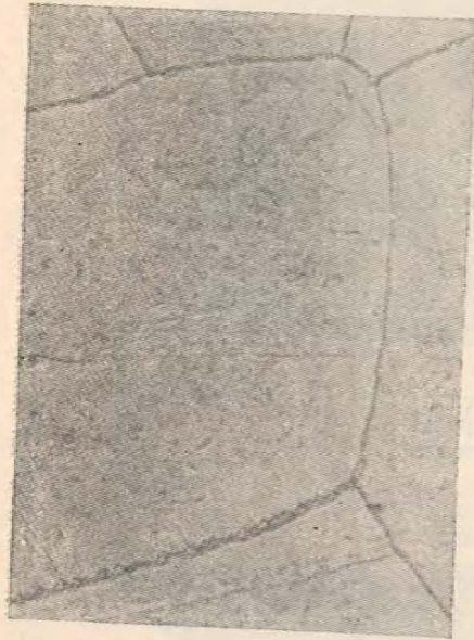
Рис. 59. То же, что на рис. 58. Травление в царской водке с глицерином. \times 600
