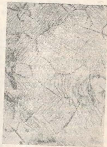
Рис. 198. Поликристаллический алюминий, линии скольжения при быстром растяжении. \times 150
