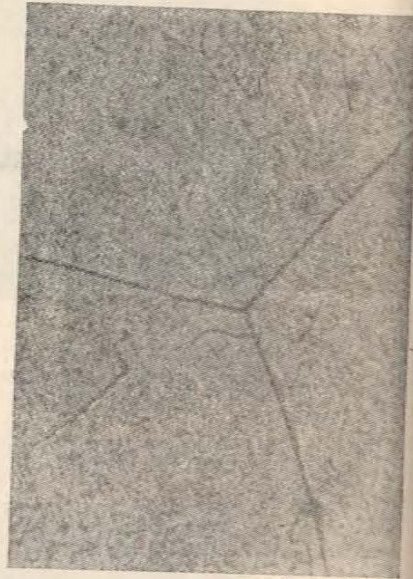
Рис. 60. То же, что на рис. 58 после отпуска при 600° в течение одного часа. \times 600 . Электролитическое травление в щавелевой кислоте
