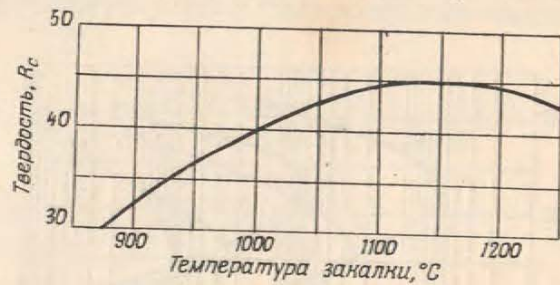
Рис. 20. Зависимость твердости мартенситной стали I группы (0,14% C, 12,9% Cr, 0,41% Si) от температуры закалки
