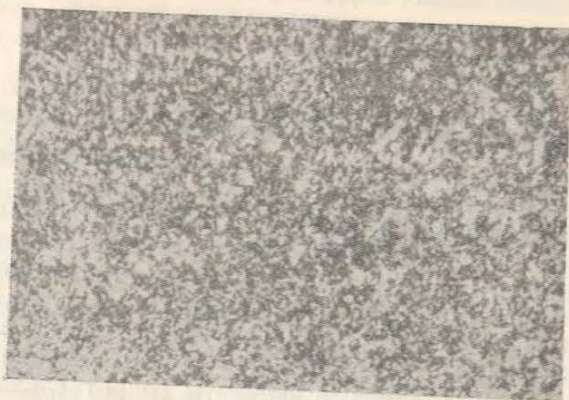
Рис. 184. Микроструктура стали (0,3% С, 0,7% Cr и 2,5 Ni), нормализованной при 850° после выдержки в течение месяца при 600° на воздухе
