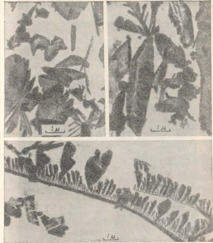
Рис. 80. Электронная микрофотография осажденных карбидов стали 18-8 после обработки по режимам: 1) один час при 675°; 2) один час при 705°; 3) один час при 760°. \times 13\ 000 ; уменьшение при воспроизведении 1/3
