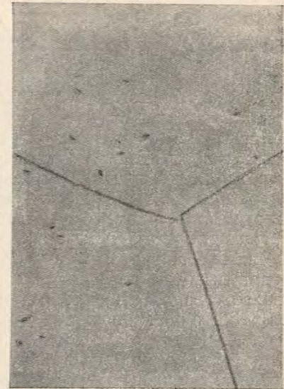
Рис. 62. Микроструктура стали с 25% Сг, выплавленной в вакууме, после закалки с 1200° в воду. Электролитическое травление в щавелевой кислоте. \times 500
