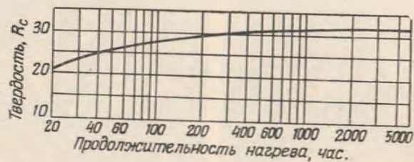
Рис. 55. Влияние продолжительности нагрева при 475° на твердость ферритной стали с 27% Cr
