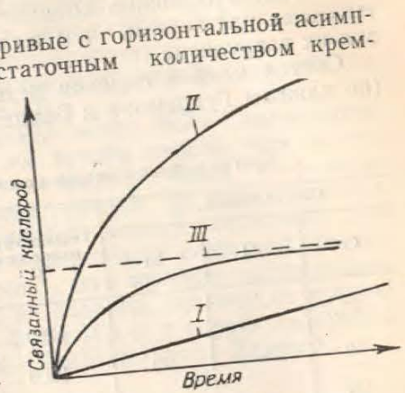
Рис. 162. Кривые зависимости окисления от времени
