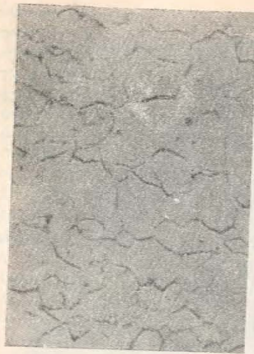
Рис. 195. Поликристаллический алюминий; границы зерен утолщены в результате растяжения в течение 20 мин. при 250°. Удлинение 4%. \times 150
