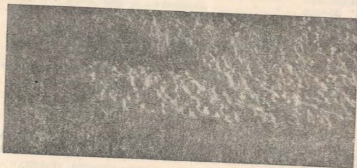
Рис. 117. Та же лопатка, что и на рис. 116; участок поверхности, подверженной кавитации
