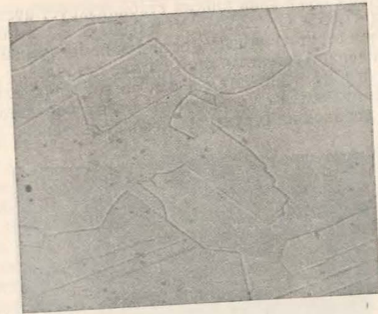
Рис. 75. Микроструктура аустенитной стали 18-8 с 0,06% C после закалки с 1050°. \times 600 . Травление в царской водке с глицерином
