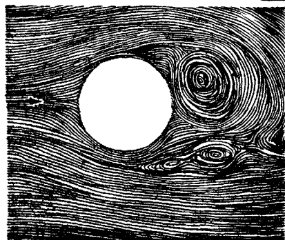
Рис. 161. Картина обтекания цилиндра.
