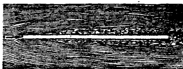
Рис. 155. Картина течения при обтекании пластинки.
