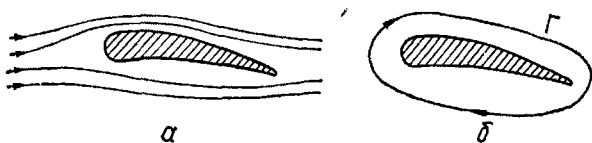
Рис. 57. Возникновение подъемной силы при обтекании крыла: a — схема обтекания; б — циркуляция.
