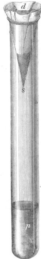
Dütenaufsatz, an der Spitze s mit Mercurinitrat befeuchtet, zum Nachweise von Ammonsalz in p, welche Flüssigkeit mit Natronlauge versetzt ist.
