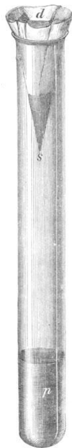
Dütenaufsatz, an der Spitze s mit Mercuronitrat befeuchtet, zum Nachweise von Ammonsalt in p , welche Flüssigkeit mit Natronlauge versetzt ist.
