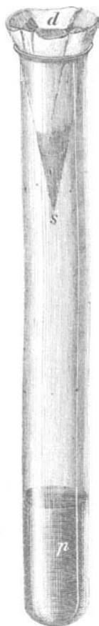
Dütenaufsatz, an der Spitze s mit Mercuronitrat befeuchtet, zum Nachweise von Ammonsalz in p , welche Flüssigkeit mit Natronlauge versetzt ist.
