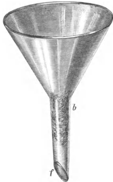
Trichter mit einem lockeren Bäuschchen Glaswolle (bei b ) versehen, dasselbe mittelst eines an der Spitze gekrümmten Drahtes eingeschoben.
