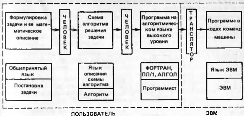
Рис. 5.6. Последовательность этапов разработки алгоритма задачи для решения на ЭВМ
