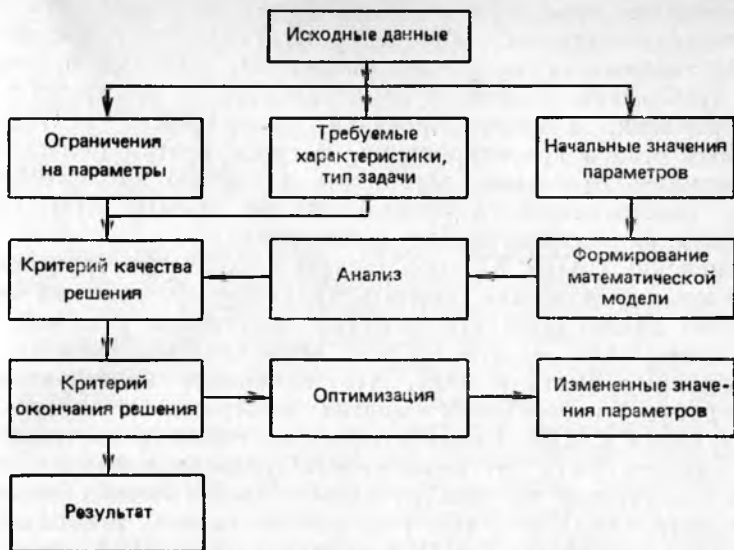
Рис. 5.4. Схема алгоритма оптимизации
