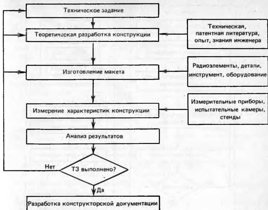
Рис. 5.1. Схема процесса разработки радиоэлектронного блока традиционными методами
