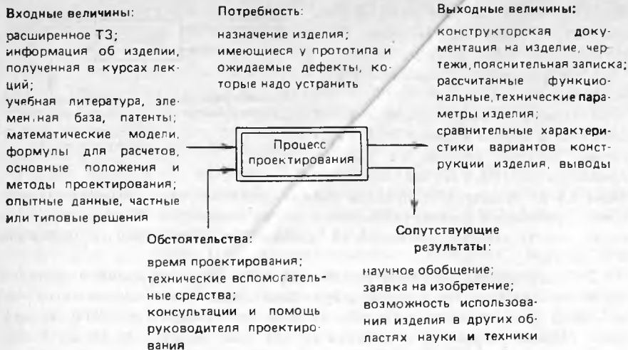
Рис. 3.3. Структура уточнения постановки задачи проектирования
