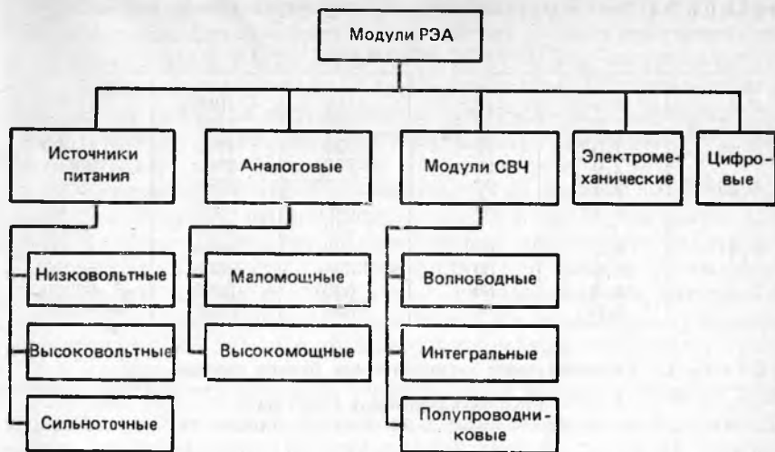
Рис. 3.7. Классификация модулей РЭА по характеру электрических сигналов
