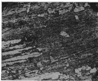
Рис. 106. Косой срез ( \alpha = 2 \div 3^\circ ) поверхности резания стали после фрезерования однозубой фрезой; шлиф травлен азотной кислотой, \times 40 (сталь 20Х—Т15К6; режим резания см. подпись к рис. 104)
