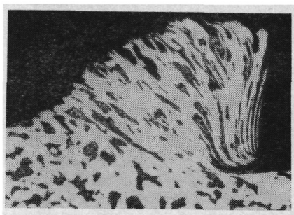
Рис. 127. Корень стружки при резании стали 20X в среде бензола. Момент образования элемента стружки (сталь 20X—P18; v = 0,22 мм/с; a = 0,1 мм; b = 2 мм; \gamma = 10^\circ ; \alpha = 10^\circ ), \times 44
