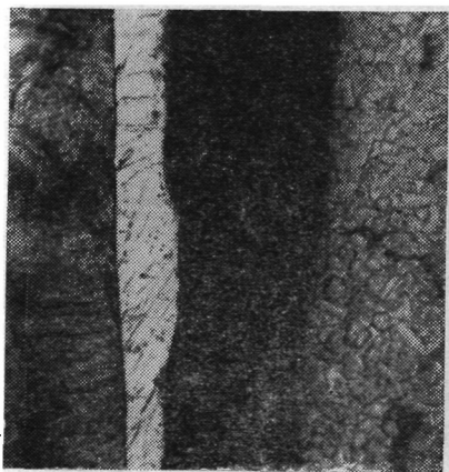
Рис. 166. Сечение обработанной поверхности и задней грани резца при резании железа с подогревом (железо Армко—Т15К6; режим см. подпись к рис. 163), \times 490
