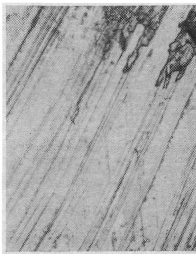
Рис. 136. Штрихи износа на передней поверхности после резания железа (железо Армо—сталь 40X; v = 8,3 мм/с; b = 5,5 мм; a = 0,1 мм; \gamma = 10^\circ ; \alpha = 10^\circ ), \times 62
