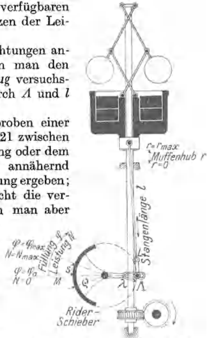
Fig. 320. Stellzeug mit zwei Verstellbarkeiten.
