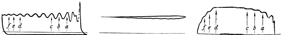
Fig. 239. Stufenkolbenpumpe. Nr. XXVIII. Luft im Pumpenraum, n = 50/\text{min} . 6 \text{ mm/at} , \frac{1}{5} nat. Gr.
