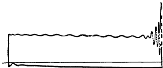
Fig. 233. Stufenkolbenpumpe. Nr. XXII. Saugwindkessel ohne Luft, n = 40/\text{min} . 6 mm/at, \frac{1}{3} nat. Gr.
