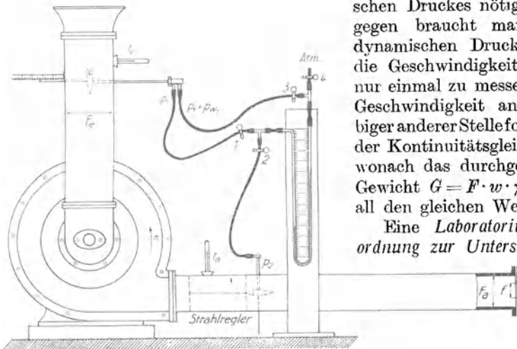
Fig. 256. Anordnung zum Untersuchen eines Ventilators.
