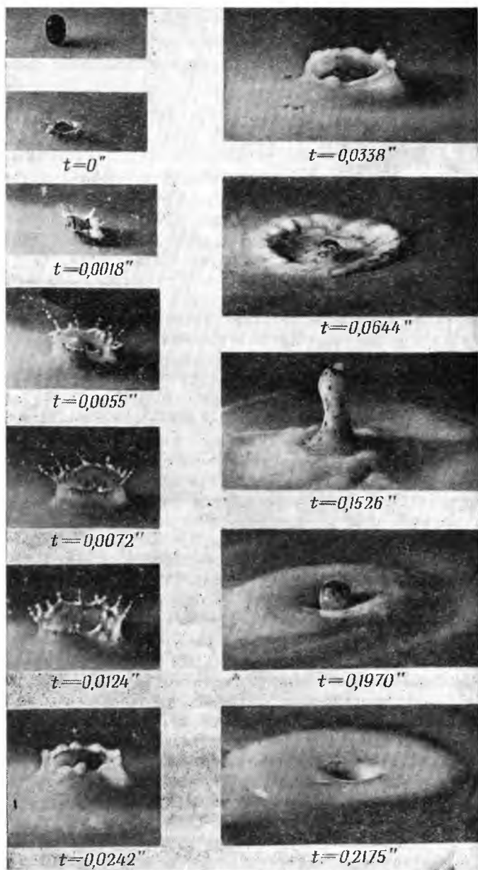
Ф и г. 5. Брызги от удара водяной капли (весом 0,2 г), падающей с высоты 40 см в смесь молока и воды. (Капля окрашена в черный цвет при помощи сажи.)
